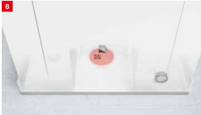
**솔루션:** 2D 코드 리더 DCR 200i는 AGV가 통과하면서 코드를 리딩합니다. 40~360mm로 작동 범위가 넓어 정확하게 감지하며, AGV에 유연하게 설치할 수 있습니다. 통합 설치 마법사를 통해 빠르고 쉽게 장치를 작동할 수 있습니다.
