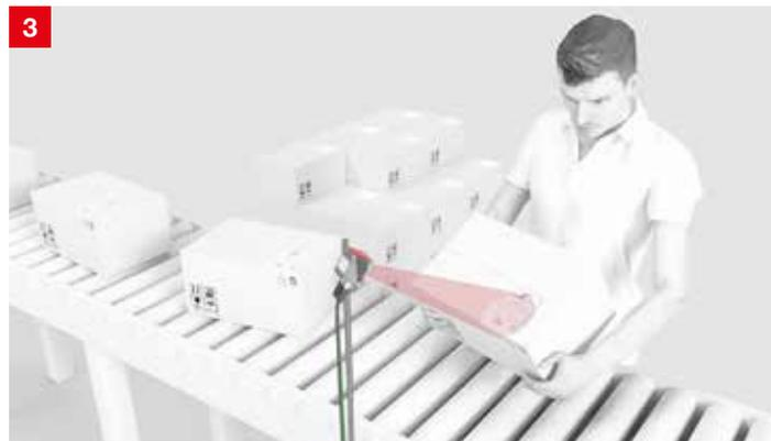
**솔루션:** 콤팩트한 카메라 기반 코드 리더 DCR 200i는 1D, 2D 코드 모두 판독 가능합니다. 간단하게 코드를 리더에 보여주면 코드를 판독할 수 있으며 별도의 트리거가 필요 없습니다. 프로피넷, 이더넷/IP, 이더넷 TCP/IP와 같은 범용 인터페이스를 통해 필드버스 통합이 가능합니다.
