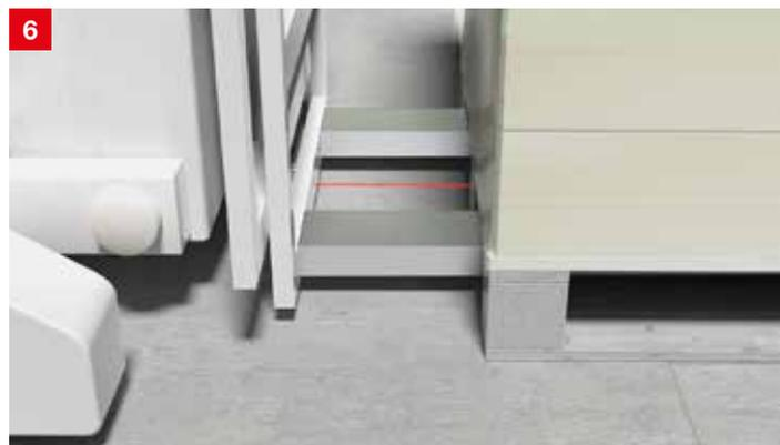
**솔루션:** 거리 센서 HRT 25B LR 시리즈의 반복 정밀도와 큰 라이트 스팟으로, 색상과 재질에 상관없이 안정적으로 작동하며 물체 간의 거리를 결정합니다. TOF 기술을 통해, 2,500mm의 넓은 작동 범위와 높은 허용 오차를 제공합니다.
