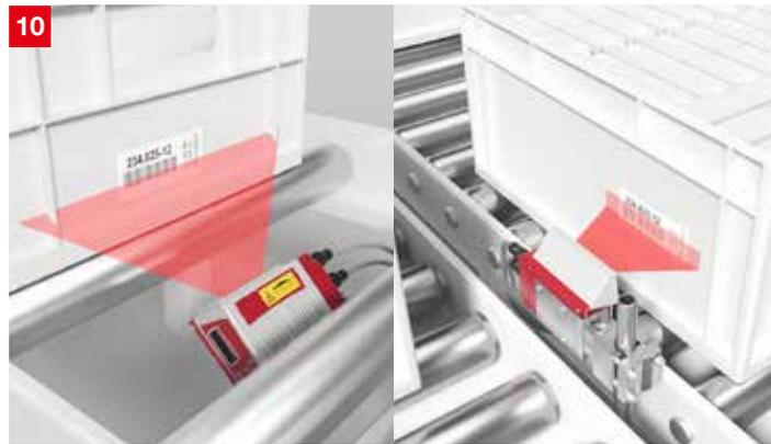
**솔루션:** 바코드리더 BCL 200i 및 BCL 300i 시리즈는 최소 판독 거리가 각각 40, 20mm로 코드와의 거리가 좁은 경우에도 설치가 가능합니다. 스위치가 내장되어 있어 모든 이더넷 기반 필드버스로 직렬 구조 설치가 가능합니다. 또한 제어장치에서 파라미터를 설정할 수 있습니다.
