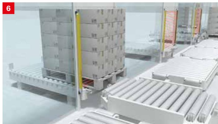
**솔루션:** 스마트 프로세스 게이팅을 사용하면 안전 센서가 제어 신호를 통해 PLC와 연결됩니다. 이 기능은 안전 라이트 커튼 MLC 530 SPG 모델에 내장되어 있습니다. 따라서 별도의 뮤팅 센서가 필요하지 않습니다.
