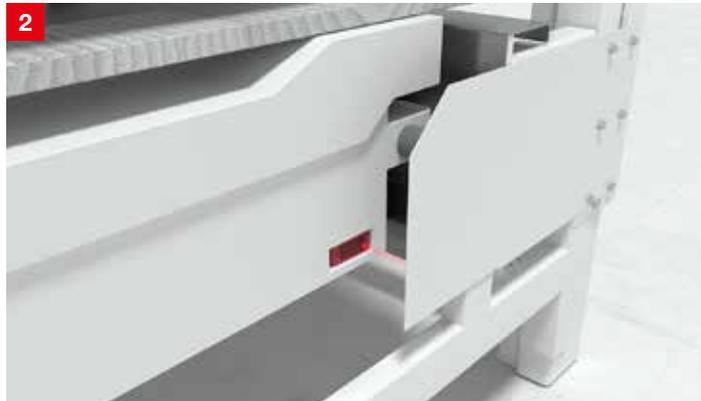
**솔루션:** 거리측정센서 ODS 110 또는 스위칭센서 HT110는 신호를 이용해 거리를 측정하는 (TOF) 방식으로 작동하며 최대 3m 거리까지 정확하게 감지합니다. 모든 장치에는 IO-Link 인터페이스가 내장되어 있으며 HT 110을 사용하면 위치와 상관없이 두 개의 스위칭 출력을 설정할 수 있습니다.
