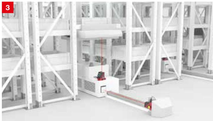
**솔루션:** 레이저 거리 측정 센서 AMS 300i는 최대 300m에 걸쳐 움직이는 시스템 부품까지의 거리를 높은 절대 정확도로 빠르게 결정합니다. 이 장치는 광범위한 산업용 이더넷 또는 필드버스 인터페이스를 통해, 밀리 초 간격으로 측정값을 전송하여 움직임을 제어합니다.
