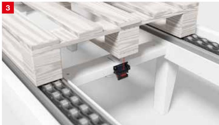
**솔루션:** 광센서 HT 25C 시리즈는 특수 홀더를 사용하여 컨베이어 시스템 제조업체가 컨베이어 내부에 장착할 수 있습니다. 분진을 배출하기 위한 전면 스크린이 내장되어 있으며 센서의 특수 외란광 파라미터화를 통해 외란광을 효율적으로 억제합니다.
