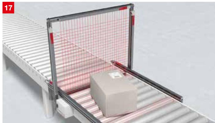
**솔루션:** 부피 측정 시스템 CMS 700i 물체가 지나갈 때 모양과 표면 재질과 상관 없이 물체의 길이, 너비, 높이, 돌출부, 변형 및 위치를 감지합니다. 심지어 폴리백도 안정적으로 감지할 수 있습니다. CMS 700i 시스템은 설치 및 작동을 위해 필요한 모든 제품들이 하나의 품목으로 구성되어 있습니다.
