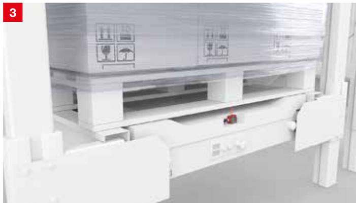
**솔루션:** 광센서 HT 3C는 배경 억제 기능 덕분에 외란광이 있는 환경에서도 팔레트를 안정적으로 감지합니다. HT 3C 시리즈는 다양한 색상 또는 구멍이 뚫린 물체, 반사광이 심한 표면도 정확하게 감지하는 솔루션을 제공합니다.
