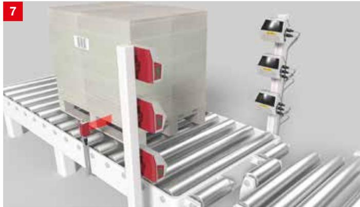
**솔루션:** 바코드리더 BCL 500i / 600i 시리즈는 다양한 위치에서 코드 라벨을 읽어야 하는 경우에 사용됩니다. 내장 스위치를 통해 장치들을 서로 연결할 수 있으며 직렬로 제어장치로 연결할 수도 있습니다.
