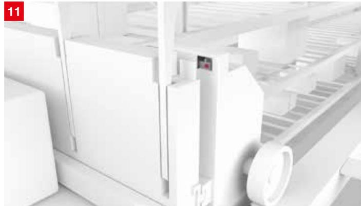
**솔루션:** 근접센서 IS 288 시리즈는 다양한 감지 어플리케이션에 사용할 수 있습니다. 사각형 구조로 플라스틱 및 금속 하우징 모델을 제공합니다. 측면으로 정렬된 센서 필드로, 설치 공간 및 비용을 절감할 수 있습니다.
