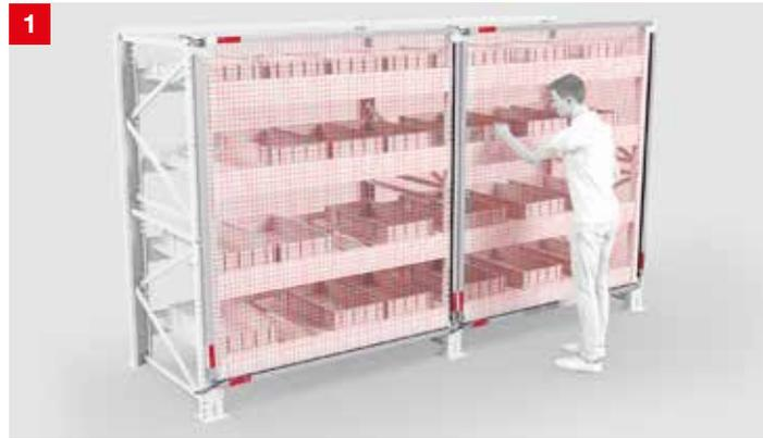
**솔루션:** 측정용 라이트 커튼 CML 700i 시리즈는 측정 범위 길이가 최대 2,960mm, 최소 분해능이 5mm로 매우 정밀하여 큰 사이즈의 랙 공간을 모니터링할 수 있습니다. 또한 인터페이스가 내장되어 다양한 필드버스에 쉽게 연결 가능합니다.
