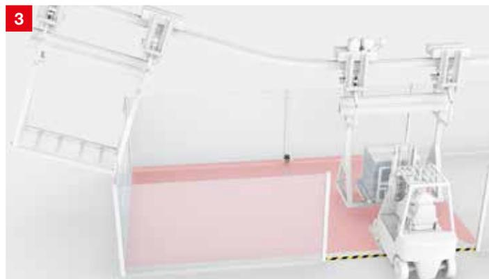
**솔루션:** 안전 레이저 스캐너 RSL 400는 270도 스캔 각도와 최대 8.25m 작동 범위로 한 개의 제품으로도 넓은 영역을 보호합니다. PROFIsafe가 있는 모델은 PROFINET 인터페이스를 통해 쉽게 산업용 네트워크로 연결할 수 있으며 최대 4개의 보호필드를 동시에 모니터링할 수 있습니다.
