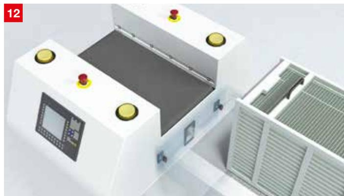
**솔루션:** 스마트 카메라 IPS 200i는 최대 0.1mm의 반복 정밀도로 홀이나 반사판과 같은 마커를 통해 위치를 제어합니다. 작업 영역은 최대 600mm이며 이더넷/TCP/IP, 프로피넷 또는 이더넷/IP 인터페이스를 통해 결과값을 출력합니다.
