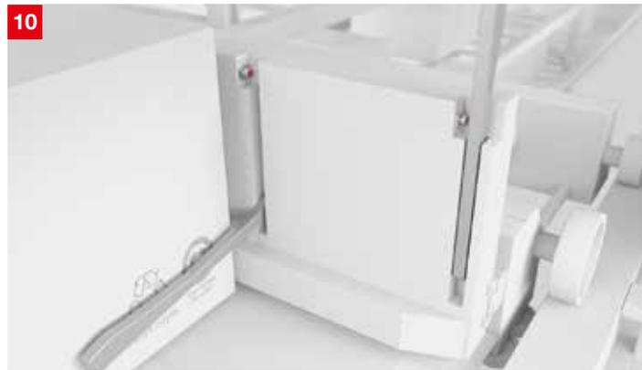
**솔루션:** 근접센서 IS 208 시리즈는 금속 물체를 정확하게 감지합니다. 견고한 금속 하우징 및 직경 8mm의 소형 표준 센서로 셔틀에 개별적으로 쉽게 설치할 수 있습니다.
