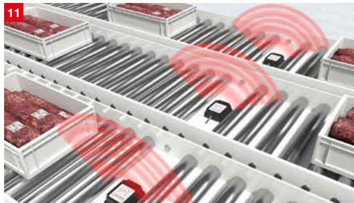
**솔루션:** RFID 기록/판독 장치 RFM 32 및 RFM 62는 컨테이너에 부착된 RFID 트랜스폰더의 정보를 판독합니다. 비접촉식 RFID 기술은 오염된 환경에서도 안정적으로 작동합니다. 또한 최대 400mm의 거리에서 사용 가능하여 컨베이어 시스템에 유연하게 장착할 수 있습니다.
