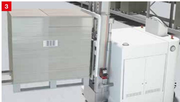
**솔루션:** 레이저 거리 측정 센서 AMS 300i는 2ms마다 +/-2mm의 절대 정밀도로 측정값을 전송합니다. 이 측정값은 다양한 인터페이스를 통해 상위 제어단으로 전송할 수 있습니다.
