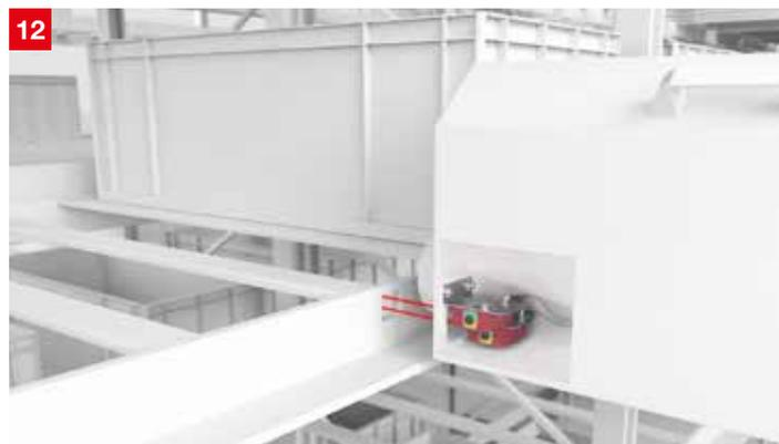
**솔루션:** 배경 억제 확산 센서 3C 시리즈는 배경에 영향을 받지 않고 정확하게 물체를 감지합니다. 특히 레이저 빔 모델은 정확하고 빠른 위치 제어 어플리케이션에 적용 가능합니다.
