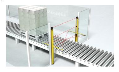
解决方案: 屏蔽功能以控制方式 桥接安全传感器, 从而允许运输 货物通过。 MSI 400安全控制器 的特殊屏蔽功能块或MSI-MD-FB屏蔽接口设计为现场模块, 可 处理屏蔽顺序控制工作。
