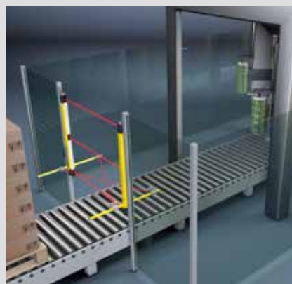
Muting de 2 sensores con control temporizado
