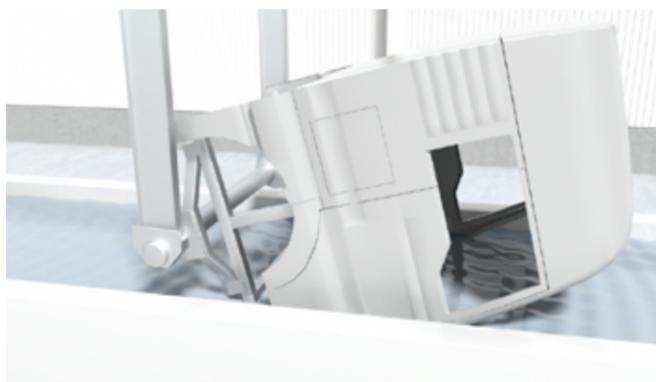
**解决方案:**RFM 读写设备发出的 RFID 波甚至可以穿透涂料层。相应电子标签可承受高达 250°C 的温度。
