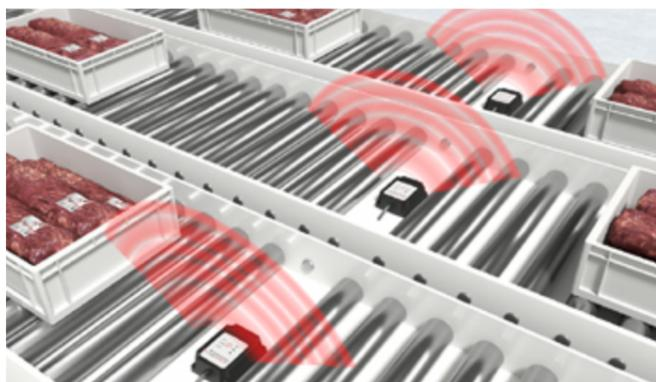
**解决方案:**由于具有 IP68/69K 高防护等级,TFM 和 TFI 电子标签可以配合使用 RFM 和 RFI 读写设备,用于食品行业。质量数据和过程数据可以在生产过程中存储在 TFM 电子标签上。
