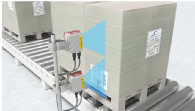
**解决方案:**BCL 600i 一维码阅读器采用蓝色激光二极管,其景深范围比红色激光二极管高出 50%。大的阅读景深度范围可以减少读取距离波动时的影响,且无需手动调焦。
