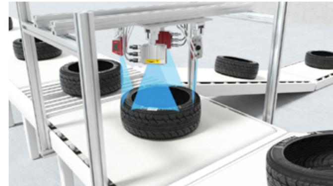
**解决方案:**BCL 500i、600i 和 900i 一维码阅读器都可作为模块化扫描仪系统。可通过对读码器的安装布局实现全方位读取条码。
