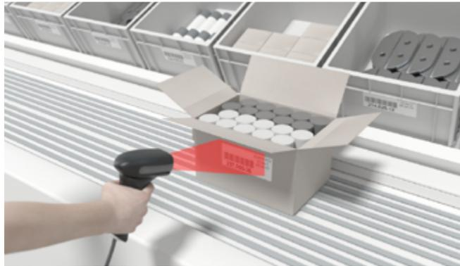
**解决方案:**IT 145xg 和 IT 1300g 手持式扫描仪可读取所有常用一维码。IT 190xg 手持式扫描仪还可以读取任意位置和方向的二维码。设备适用于干燥和清洁环境。
