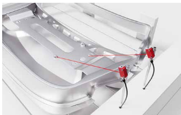
Nuestros escáneres láser ODT3CL1-2M no solo pueden detectar la presencia de un componente, sino también puntos de referencia definidos en un componente, controlando así la calidad. Los sensores también funcionan con fiabilidad con diferentes acabados de superficie.
