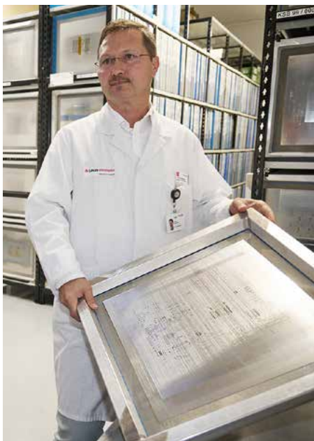
El director de producción Georg Denking con una plantilla. Se utiliza para aplicar la pasta de soldadura específicamente en las placas de circuito impreso.
