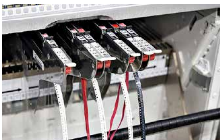
Los componentes electrónicos estándar están en rollos. Las cintas transportadoras individuales se alimentan en una máquina de posicionamiento que coloca los componentes en la placa de circuito impreso.
