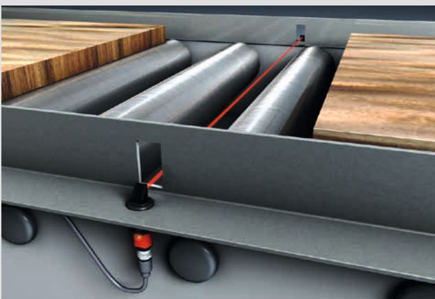
Detektion von Holzplatten
