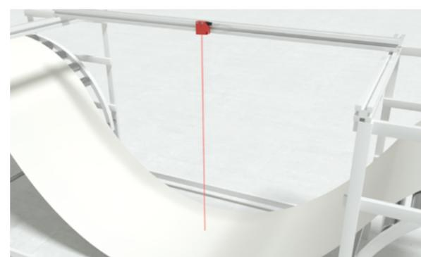
**解决方案:**可以通过垂度测量监测材料的拉伸度。ODSL 8、ODS 10和 ODSL 96传感器具有各种光斑几何形状,可以可靠地测量各种不同材料表面的垂度。
