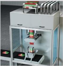
Zuverlässige Markenerkennung zum Schnitt von Sleeve-Etiketten
