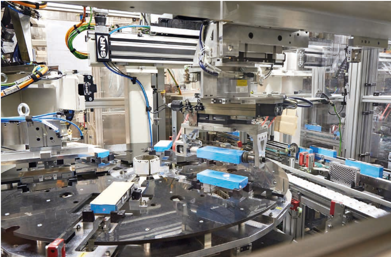
En esta estación, cada celda recibe un «escudo térmico» – un aislamiento térmico protector – que se presiona en los lados longitudinales. Las barreras ópticas de reflexión PRK 25 de Leuze detectan la presencia de los objetos.
