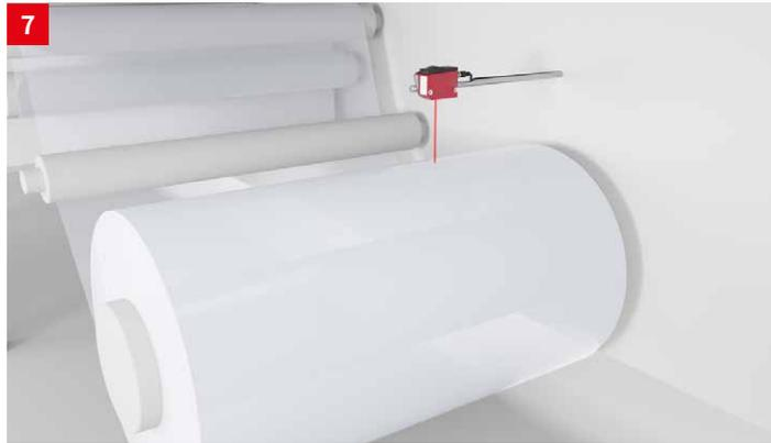
**솔루션:** 거리 측정 센서 ODS9 또는 ODS96 시리즈는 롤 직경과 관련된 아날로그 신호를 제어 장치로 전송합니다. 이 외에도 초음파 센서 DMU318 및 DMU418을 사용하여 롤 직경을 측정할 수 있습니다. 다양한 측정 범위의 거리 센서를 제공합니다.
