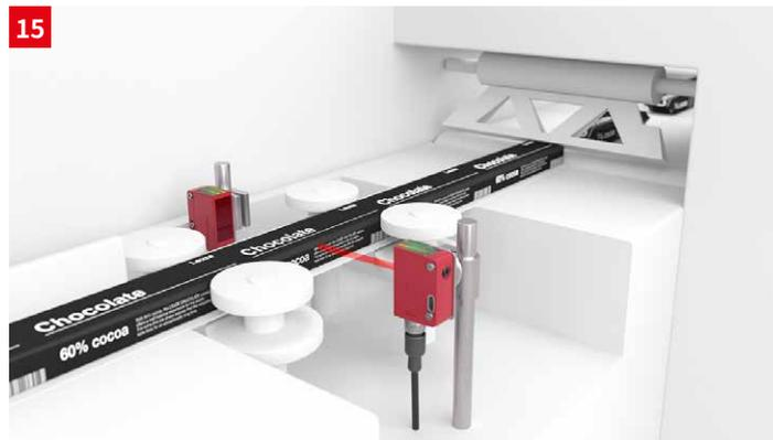
**솔루션:** 고성능의 투수광 포토센서 LS25CI.XR Super Power 및 LS25CI.XR은 대부분의 금속이나 어두운 색으로 된 필름에도 광선을 쉽게 투과됩니다. 밀봉된 필름 튜브에서도 포장 내부의 제품 앞쪽 가장자리를 확실하게 감지합니다.
