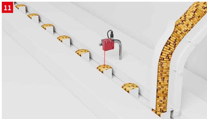
**솔루션:** 거리 측정 센서 ODS 9는 다양한 측정 범위와 분해능 덕분에 충전 레벨 모니터링에 적합합니다. 파라미터를 설정할 수 있는 아날로그 전류 또는 전압 출력과 IO-Link 인터페이스를 갖추고 있어 사용되는 제어 환경에 맞게 쉽게 조정할 수 있습니다.
