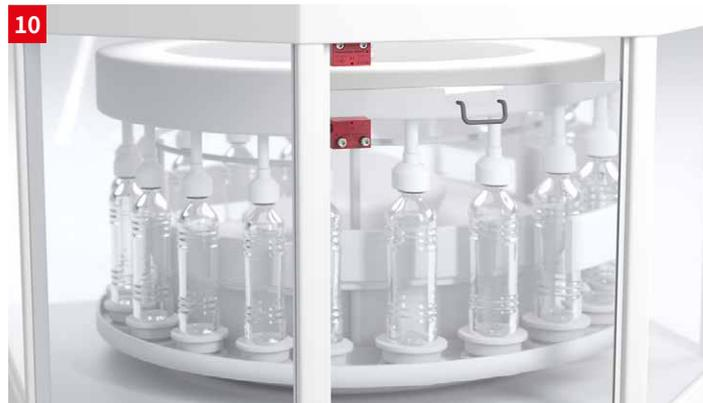
**솔루션:** 마그네틱 코딩 안전 근접 센서 MC 300은 도어와 덮개를 모니터링합니다. 이 센서는 밀폐된 디자인과 비접촉식 작동 원리 때문에 열악하고 습한 환경에서 사용하기에 매우 적합합니다. 이 장치는 사각형 및 원통형 디자인이기 때문에 간편하게 설치할 수 있습니다.
