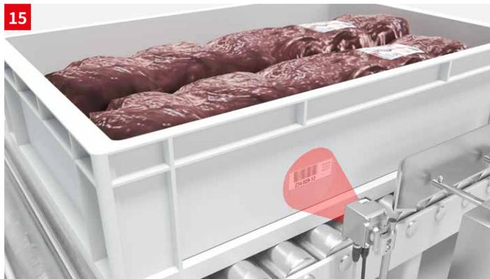
**솔루션:** 보호 등급이 IP 69K인 스테인리스 스틸 하우징(위생적인 디자인)의 콤팩트한 이미지 기반 코드 리더 DCR 200i를 사용하면 컨테이너의 바코드 또는 데이터 매트릭스 코드를 매우 확실하게 판독 및 식별할 수 있습니다. 또한, 이더넷 기반 인터페이스를 선택할 수 있습니다.
