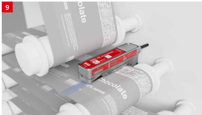
**솔루션:** 포크 센서 IGSU14E SD는 이음매를 확실하게 감지합니다. 초음파 원리를 사용하여 모든 유형의 인쇄를 감지할 수 있고 티칭 기능으로 쉽고 빠르게 티칭할 수 있습니다. 내장된 IO-Link 인터페이스를 통해 진단 기능을 사용할 수 있습니다.
