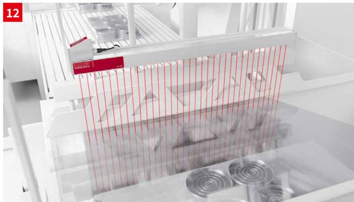
**솔루션:** 측정 라이트 커튼 CML 730PS는 필름 내 물체를 감지하기 위해 개발되었습니다. 전원 설정을 통해 다양한 포장 필름을 하나 이상의 레이어에서 광선을 투과시킬 수 있고 필름 내 제품을 감지할 수 있습니다.
