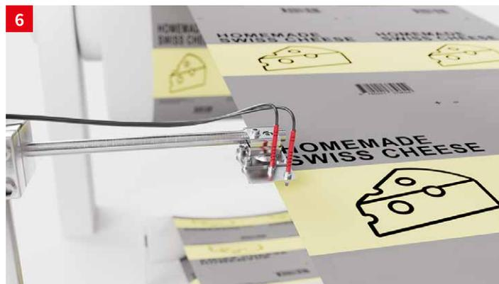
**솔루션:** 웹 가이드를 위해 다양한 솔루션을 사용할 수 있는데, 플라스틱 광섬유 케이블 KF 시리즈나 스위칭 반사판 포토센서 (예: PRK 18B)로 2 포인트를 제어할 수 있습니다. 측정용 포크 센서 GS 754를 사용하면 고정밀 아날로그 웹 가이드가 가능합니다.
