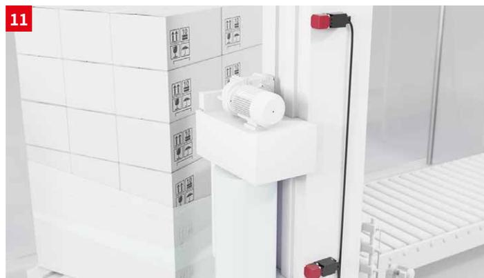
**솔루션:** 근접 센서는 필름 캐리지의 금속 구조물을 감지합니다. 회전형 활성 헤드와 단자 또는 M12 연결부가 있는 사각형 근접 센서 IS 244는 유연하게 설치할 수 있고 감지 범위가 최대 40mm에 이릅니다.
