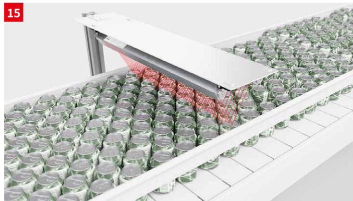
**솔루션:** V 옵틱 구성의 측정용 라이트 커튼 CML 700은 통과하는 이송 물체를 측정하기 위해 개발되었으며, 전체 측정 너비에서 간섭을 감지합니다. 결함(틈)이 있는 경우 트랜스미터에서 리시버로 빛이 반사되지 않기 때문에 센서가 즉시 감지합니다. 다양한 인터페이스를 사용할 수 있습니다.
