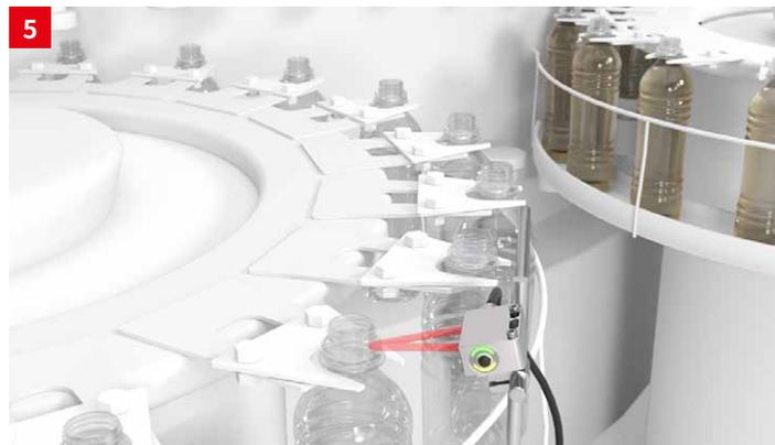
**솔루션:** 배경 억제 확산 센서 HT55C는 충전 중에 반사판 없이 병을 확실하게 감지합니다. ECOLAB 인증과 장시간의 자체 세정제 내구성 테스트에서 CleanProof+ 등급을 받아 습한 환경 및 집중 세척 공정 중에도 안정적인 센서의 성능을 보장합니다.
