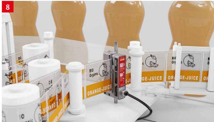
**솔루션:** 초음파 포크 센서 GSU12, GSU14E 및 IGSU14E는 투명한 라벨과 부분적으로 투명한 라벨을 감지합니다. 초음파 시스템과 광학 감지 시스템이 하나의 하우징에 결합된 포크센서 GSX14E는 비균질의 공동 BOPP 재질로 만들어진 라벨도 처리할 수 있습니다. IO-Link 인터페이스는 설정을 간소화해 줍니다.
