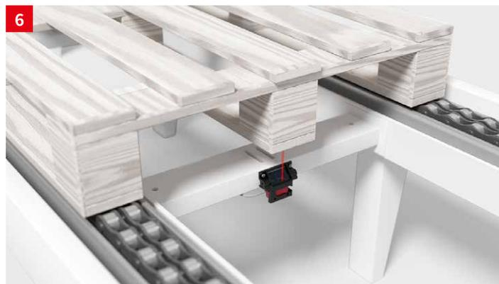
**솔루션:** 설치 브라켓 SET-HT25CI는 특수 홀더를 확산 센서 HT 25C와 결합합니다. 홀더에는 전면 스크린이 비스듬한 위치에 내장되어 있어, 떨어지는 먼지 입자가 자동으로 차단됩니다. 센서의 특별한 파라미터 설정을 통해 주변 광원을 효율적으로 억제합니다.
