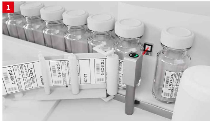
**솔루션:** 반사판 포토센서 PRK53C.T는 투명체 감지를 위해 개발되었습니다. 위생이 중요한 생산 공정에 적합한 스테인리스 스틸 하우징을 갖춘 이 센서는 응답 시간이 짧고 IO-Link 인터페이스가 내장되어 있습니다.
