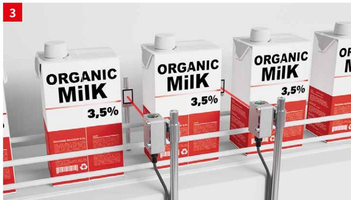
**솔루션:** 소형 레이저 광점을 사용하는 반사판 포토센서 PRK 55CL은 작은 틈을 감지하는 데 적합합니다. 함께 사용되는 스테인리스 스틸 하우징의 MTKS.5 반사판은 여러 가지 크기로 제공됩니다. 센서와 반사판은 ECOLAB 인증을 받았습니다.
