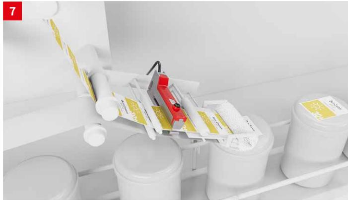
**솔루션:** 광학 포크 센서 GS61 및 GS63B는 불투명한 라벨의 전체 범위를 확실하게 감지합니다. 이 센서는 포텐서미터나 터치 기능을 통해 조정할 수 있습니다. 하부 포크의 디자인이 슬림해 디스펜싱 가장자리에 직접 설치할 수 있습니다.
