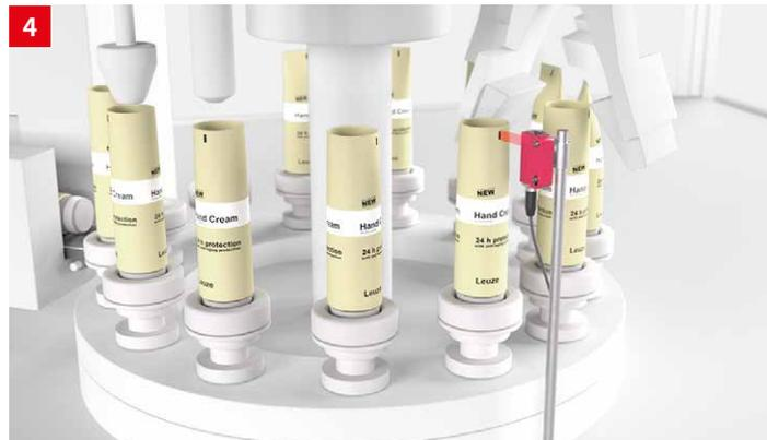
**솔루션:** 소형 명암 센서 KRT 3C는 사이즈가 작아 설치 공간에 제약이 적습니다. 이 센서는 응답 시간이 50µs에 불과해 원형 물체에서도 다양한 색상의 인쇄 마크를 매우 정확하게 감지합니다. IO-Link 인터페이스를 통해 포맷 변경 시간을 절감할 수 있습니다. 요구 사항이 더 까다로운 경우에는 스테인리스 스틸 하우징의 KRT 55를 사용할 수 있습니다.
