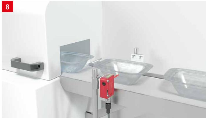
**솔루션:** 플라스틱 하우징의 3C 또는 25C 시리즈나 스테인리스 스틸 하우징의 55C 시리즈의 소형 반사판 포토센서는 해당 어플리케이션을 위해 오토콜리메이션 모델로 설계되었습니다. 또한, 마이크로 트리플 구조로 된 반사판 MTKS는 다양한 크기와 재질을 제공하여 선택하여 사용할 수 있습니다.
