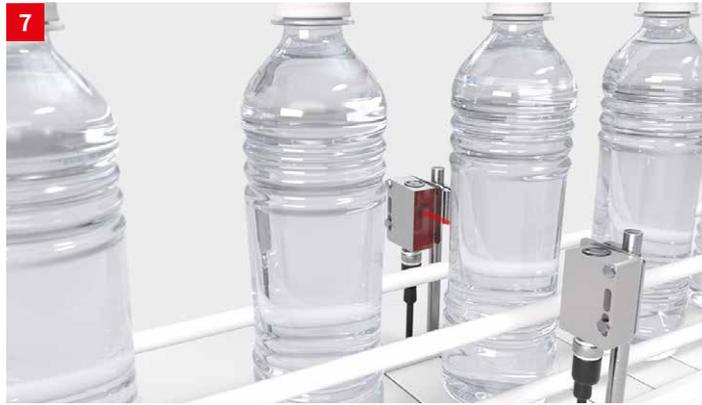
**솔루션:** 투수광 포토센서 LS/LE55CI.H2O 는 투명하거나 불투명한 용기에 담긴 수성 액체를 감지하기 위한 최적의 파장을 갖추고 있습니다. 또한, 충전 공정 중 세척 및 환경에 대한 까다로운 요구 사항을 충족하기 위해 보호 등급 IP 69K의 스테인리스 스틸 하우징으로 설계되었습니다.
