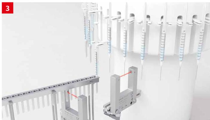
**솔루션:** 레이저 포크 센서 GSL 08B 는 얇은 주사기 바늘도 감지합니다. V4A 스테인리스 스틸 하우징은 무균실에 적합하고 ECOLAB 인증을 받았기 때문에 위생과 세정제 내성에 관한 요구 사항이 까다로운 구역에서 사용하기 적합합니다. 또한, -25°C에서 60°C 사이의 온도에서 안정적으로 작동합니다.
