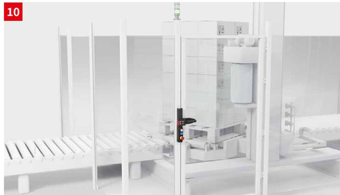
**솔루션:** 잠금 장치가 있는 견고한 안전 스위치 L100, L250 및 L300은 전기 신호로 접근을 해제하기 전까지 도어를 잠금 상태로 안전하게 보호합니다. 이 시리즈에는 기본 모델, 조작 컨트롤이 내장된 모델, 그리고 RFID 코딩 액추에이터가 있는 모델이 포함됩니다.
