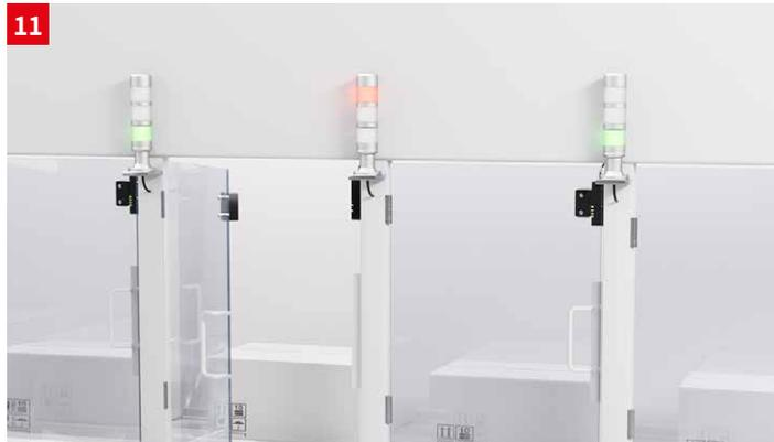
**솔루션:** 안전 근접 센서 RD 800은 도어와 덮개를 모니터링하고, RFID 코딩 액추에이터로 최고 수준의 무단 조작 방지 기능을 제공합니다. IP 69K 보호 등급과 최고 작동 온도 70°C를 자랑하는 이 장치는 광범위한 어플리케이션에 사용할 수 있습니다. OSSD 출력과 퍼포먼스 레벨 PI e로 손쉬운 통합을 보장합니다.
