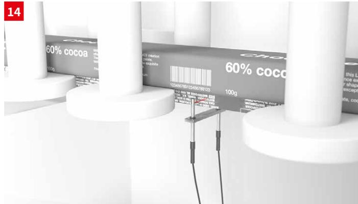
**솔루션:** 다양한 옵틱 전원부와 마운팅 옵션을 갖춘 광섬유 케이블 KF 및 KFX는 제한적인 설치 환경에 유연하게 적용할 수 있습니다. 높은 광출력의 앰프와 결합된 LV463. XR은 이 어플리케이션에 꼭 맞는 솔루션입니다. 또한, 아날로그 출력과 IO-Link 인터페이스도 제공합니다.
