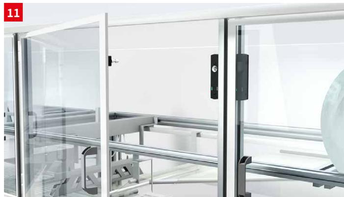
**솔루션:** 인터락 스위치 L250 및 L300은 제어장치가 해제 전기 신호를 보낼 때까지 안전 도어를 잠금 상태로 유지합니다. RFID 코딩 액추에이터 덕분에 무단 조장을 방지할 수 있으며 비상 정지 및 명령 버튼 옵션으로 전체 안전 기능을 더 쉽게 설정할 수 있습니다.
