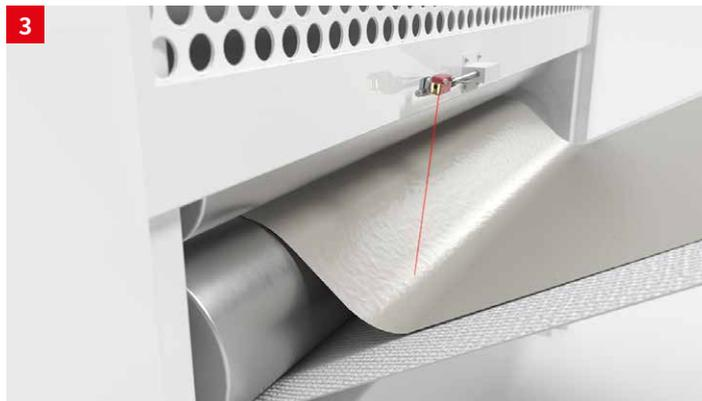
**솔루션:** 광학 거리 센서 ODT 3C를 반죽 루프 위쪽 롤링 기계의 출구에 설치하여 상위 PLC에 거리값을 제공합니다. 측정값은 IO-Link를 통해 프로세스 데이터로 사용하여 평가합니다. 또한 진단 데이터는 IO-Link를 통해 컨트롤러로 전송되어 인더스트리 4.0을 실현할 수 있습니다.
