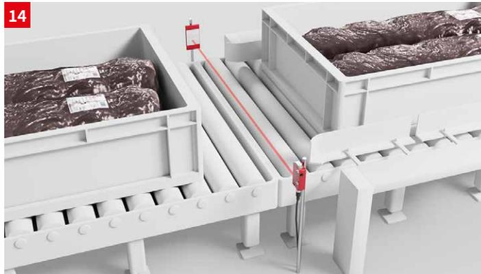
**솔루션:** 반사판 포토센서 PRK 46C 또는 PRK 25C 시리즈는 이송되는 컨테이너 감지에 사용할 수 있습니다. 배경 억제 확산 센서 HT 46C 또는 HT 25C도 자주 사용됩니다. 46C 및 25C 시리즈는 보호 등급 IP 69K를 보유하고 있으며 ECOLAB 인증을 받았습니다.
