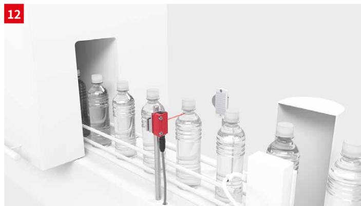
**솔루션:** 플라스틱 하우징(PRK 3CL 시리즈) 또는 금속 하우징(PRK 55CL 또는 PRK 18B)에 레이저 광원이 있는 반사판 포토 센서는 매우 낮은 지터로 정확한 트리거가 가능합니다.
