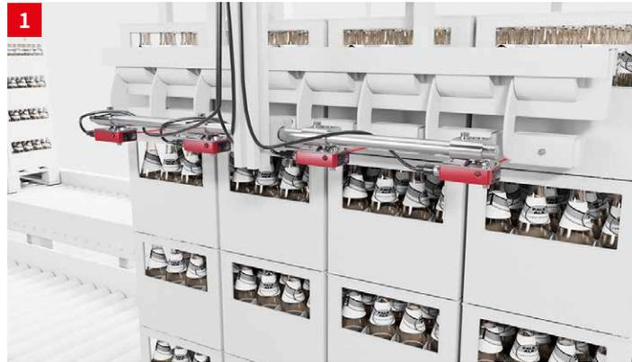
**솔루션:** 반사판 포토센서 PRK 46C는 감지 범위가 매우 넓어 예비 광출력이 매우 높습니다. 다른 모델에서는 감도를 조정할 수 있고 Depol 기능으로 시스템의 가용성을 높일 수 있습니다. 모든 센서는 IP 69K 보호 등급과 ECOLAB 인증을 보유하고 있습니다.
