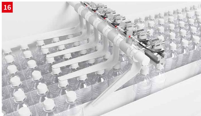
**솔루션:** 끝단 감지용 센서와 함께 브라켓으로 연결하면 간편하게 해결할 수 있습니다. 최종 위치는 플라스틱 브라켓의 금속 암을 통해 근접 센서(예: 금속 또는 스테인리스 스틸 하우징의 IS 218 또는 IS 212)로 감지할 수 있습니다.
