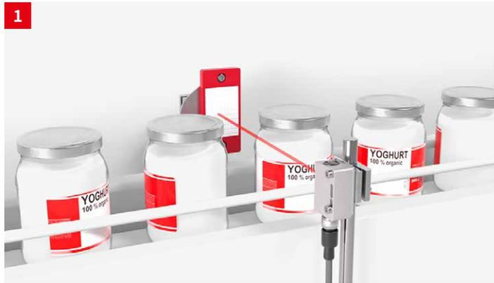
**솔루션:** 반사판 포토센서 PRK 55C는 투명한 병을 확실하게 감지합니다. 감도는 터치 버튼을 사용하여 설정할 수 있습니다. 반사판이나 센서의 오염은 옵션으로 제공되는 트레이킹 기능이 자동으로 처리합니다. 위사다운 디자인의 견고한 스테인리스 스틸 하우징으로 보호 등급은 IP 69K입니다.
