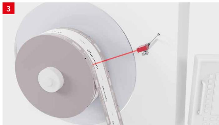
**솔루션:** 거리 측정 센서 ODS 9는 최적의 드라이브 조정을 위해 아날로그 거리 신호를 제공합니다. 이 거리 센서는 다양한 거리 범위, 파라미터 설정 옵션 및 내장 디스플레이와 함께 사용할 수 있습니다. 이 센서는 IO-Link 인터페이스가 내장되어 있어 범용으로 사용할 수 있습니다.
