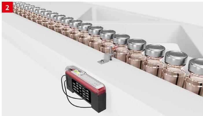
**솔루션:** 다양한 빔 출력의 플라스틱 화이버 옵틱 센서 KF 또는 유리 화이버 옵틱 센서 GF와 LV 463 앰프는 약병 감지를 위한 유연한 솔루션입니다. 유리 화이버 옵틱 센서의 경우, 특히 주변 온도가 높은 경우에 사용하기 적합합니다. 메뉴를 통해 편리하게 설정할 수 있는 앰프는 아날로그 출력 및 IO-Link 인터페이스와 함께 사용할 수 있습니다.
