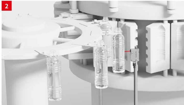
**솔루션:** 편광식 반사판 포토센서 PRK 55C 및 PRK 18B는 매우 투명한 병 감지를 위해 특별히 개발되었습니다. 온도 변화와 오염에 강해 주변 환경의 영향을 크게 받지 않기 때문에 예기치 못한 유지보수로 인한 작업 중단 없이 장기간 기계를 작동시킬 수 있습니다.
