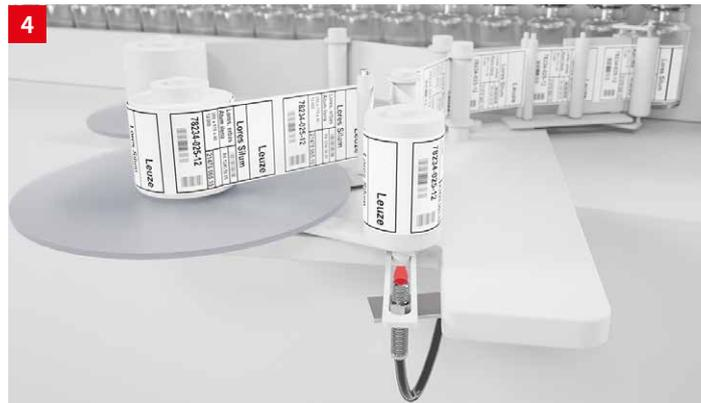
**솔루션:** 근접 센서 IS 200은 주로 금속성 롤 마운트를 감지하므로, 텐션 롤의 두 끝단 위치를 감지합니다. 근접 센서 IS 288, IS 212 또는 IS 218은 내장형 또는 비내장형 설치를 위해 적절한 스위칭 거리를 제공합니다.
