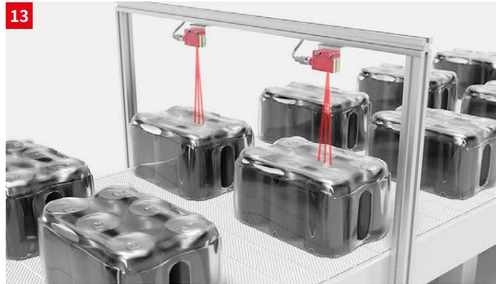
**솔루션:** 이송 물체 감지 센서 DRT25C.R은 컨베이어 벨트 표면을 기준으로 사용하기 때문에 모든 유형의 패키지를 확실하게 감지합니다. 따라서 제품 변경 시 센서를 조정할 필요가 없습니다.
