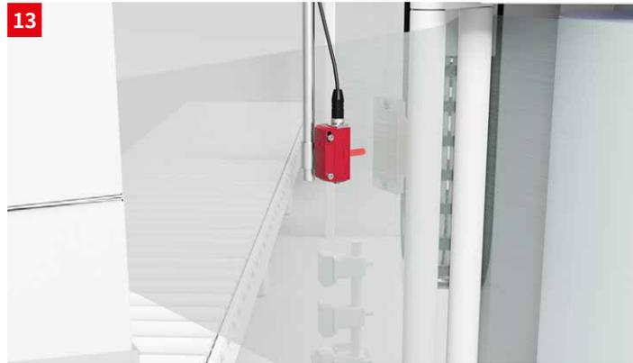
**솔루션:** 편광식 포토센서 PRK3C.A 또는 반사판 포토센서 PRK25C.A는 투명 필름의 감지에 적합합니다. 내장된 IO-Link 인터페이스는 다양한 진단 옵션과 원격으로 센서의 파라미터를 설정할 수 있는 기능을 제공합니다. 반사판 MTKS를 사용하거나 반사 테이프 REF6을 반사판으로 사용합니다.
