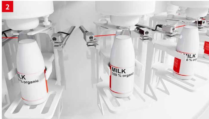
**솔루션:** 투수광 포토센서 LS55CI, H2O 및 LE55CI.H2O는 LED 광원 덕분에 수성 액체의 감지에 적합합니다. 위사다운 디자인의 스테인리스 스틸 55C 시리즈 트랜스미터 및 리시버 시스템은 광출력이 높아 다양한 색상의 용기와 플라스틱 라벨이 있는 용기에 담긴 액체도 감지합니다.
