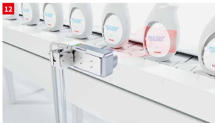
**솔루션:** Simple Vision 센서 IVS 1048i 시리즈는 넓은 감지 필드로 제품의 라벨을 쉽게 감지하고 라벨이 올바르게 부착되어 있는지 확인할 수 있습니다. 파라미터 설정은 로이체 Vision Studio 소프트웨어를 통해 수행됩니다. 스위칭 가능한 내장 LED 고성능 조명은 최적의 이미지를 제공합니다.
