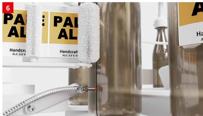
**솔루션:** 다양한 옵틱 아웃렛이 있는 유리 화이버 옵틱 센서 GF와 앰프LV 463은 병의 정렬 상태를 확인하는 데 매우 적합합니다. 화이버 옵틱 센서는 특히 정교하면서도 강력합니다. 이 센서는 IO-Link 인터페이스를 갖추고 있으며 아날로그 출력 옵션이 제공됩니다.
