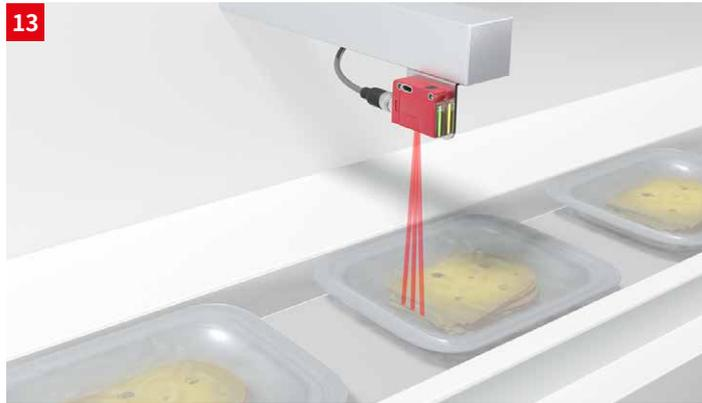
**솔루션:** 이송 물체 감지 센서 DRT 25C는 컨베이어 벨트를 기준으로 설정하기 때문에 제품의 색상이나 높이와 상관 없이 벨트에 있는 물체의 앞단을 확실하게 감지할 수 있습니다. 이송 방향에 수직으로 배열된 광점은 틈이 있는 제품도 감지합니다.
