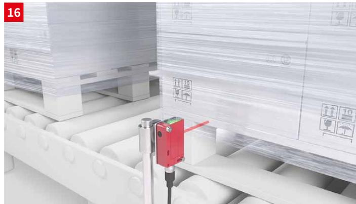
**솔루션:** 반사판 포토센서 PRK 46C. D는 롤러 컨베이어에 사용하기에 가장 적합합니다. 특히 필름 포장 및 수축 포장된 팔레트 감지에 높은 기능적 안정성을 제공합니다. 보호 등급이 IP 69K인 이 센서는 감지 범위가 16m이고 높은 예비 광출력을 갖추고 있어 기계적으로 매우 강력하고 안정적입니다.
