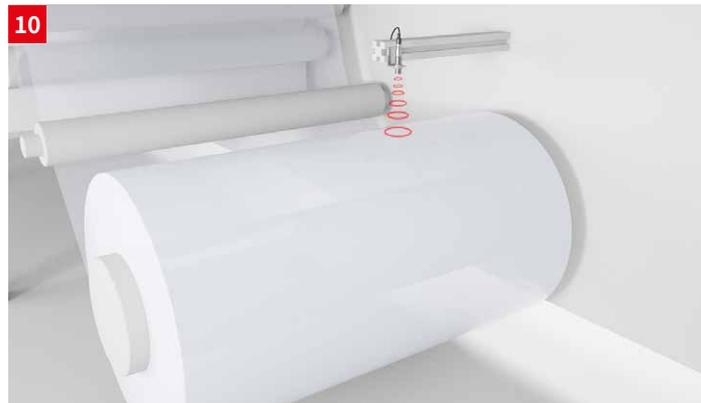
**솔루션:** 초음파 거리 센서 DMU 318 또는 DMU 418은 정확한 거리 측정을 위해 개발되었으며 롤 직경에 대한 정보를 아날로그 신호를 통해 제공합니다. 또는, 다양한 측정 범위를 제공하고 거리 측정 센서 ODS 9 시리즈를 사용할 수도 있습니다. 내장된 IO-Link 인터페이스를 통해 부가 기능을 이용할 수 있습니다.
