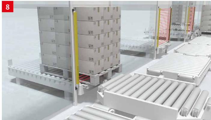
**솔루션:** SPG(Smart Process Gating) 기능을 사용하면 PLC의 제어 신호를 통해 안전 센서가 브릿지됩니다. 이 기능은 MLC 530-SPG 시스템에 포함되어 있습니다. SPG 기능이 있어서 추가 뮤팅 센서가 필요하지 않으며 특히 공간을 절약하고 무단 조작을 방지하도록 시스템을 설계할 수 있습니다.
