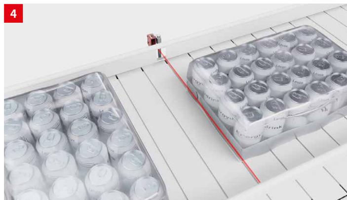
**솔루션:** 반사판 포토센서 PRK25C.D는 수축 포장된 물체 감지에 최적화되어 있으며 높은 예비 광출력을 제공합니다. 설치 공간이 협소한 경우, 더 작은 하우징의 PRK 5B.D센서를 사용할 수 있습니다.
