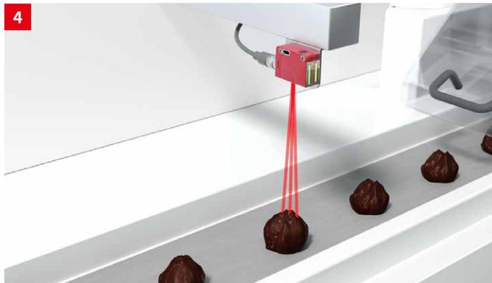
**솔루션:** 이송 물체 감지 센서 DRT 25C는 작동 원리 때문에 작고 납작한 것부터 크고 둥근 것까지 다양한 형태의 제품을 확실하게 감지합니다. 또한 터치 버튼 하나로 센서를 쉽게 설정할 수 있습니다. 추가적인 센서 기능은 IO-Link 인터페이스로 제어할 수 있습니다.
