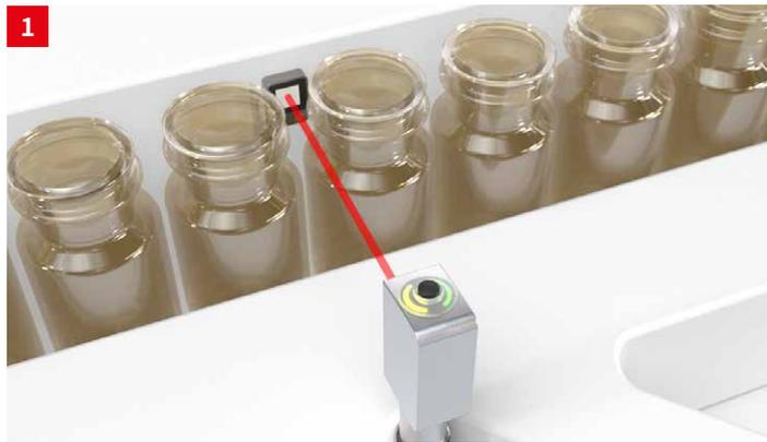
**솔루션:** 작은 레이저 광점을 사용하는 반사판 포토센서 PRK 53CL1.T3 를 스테인리스 스틸 반사판 MTKS와 함께 사용하면 약병을 매우 정확하게 감지하여 약병의 위치를 제어할 수 있습니다. 소형 센서로 협소한 공간에서도 쉽게 설치할 수 있으며 센서와 반사판은 위생적인 디자인으로 설계되었습니다.
