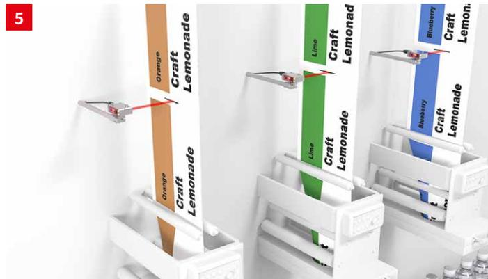
**솔루션:** 신호 디스플레이와 멀티 컬러 트랜스미터 LED가 있는 명암 센서 KRT 18B는 매우 유연하게 절단 마크를 감지합니다. 내장된 IO-Link 인터페이스 덕분에 라벨 변경 시 시운전과 명암 센서 조정이 간단합니다.
