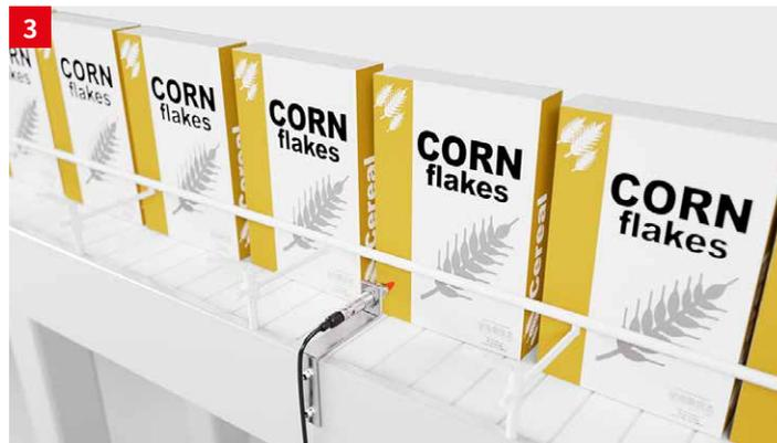
**솔루션:** 정전용량 센서 LCS는 싱글 레인 이송 중인 상자를 통해 내용물을 확인합니다. 원통형 디자인의 센서 덕분에 설치 시 공간을 많이 차지하지 않습니다.
