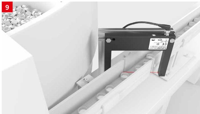
**솔루션:** 포크 센서 GS 04B 및 GS 08B는 소형 부품을 감지하는 데 매우 적합합니다. 트랜스미터와 리시버가 하나의 장치에 있기 때문에 정렬 작업이 필요 없으며 설치 공간이 협소한 어플리케이션에 쉽게 적용할 수 있습니다. 이 센서는 수평으로 라인에 설치되기 때문에 각각의 마개가 라이트빔에 감지됩니다.
