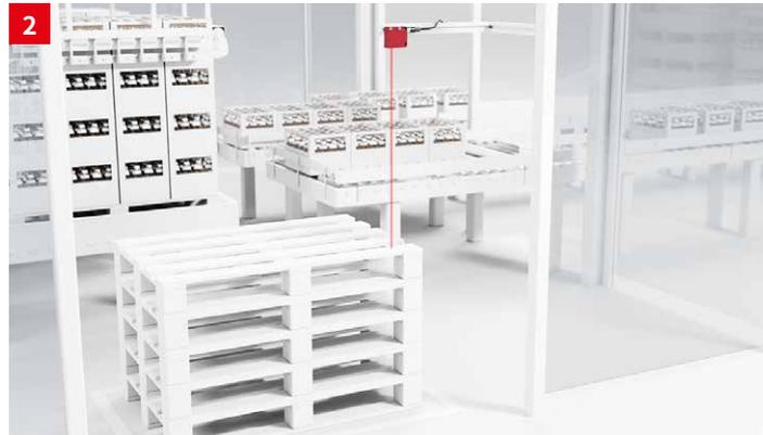
**솔루션:** 광 측정 센서는 확실한 높이 측정을 보장합니다. 거리 측정 센서 ODS 110은 아날로그 값이나 내장된 IO-Link 인터페이스를 통해 거리값을 출력할 수 있습니다. 선명하고 작은 레이저 광점(레이저 등급 1)은 인체에 무해하며 이를 통해 위치를 쉽게 제어할 수 있습니다.
