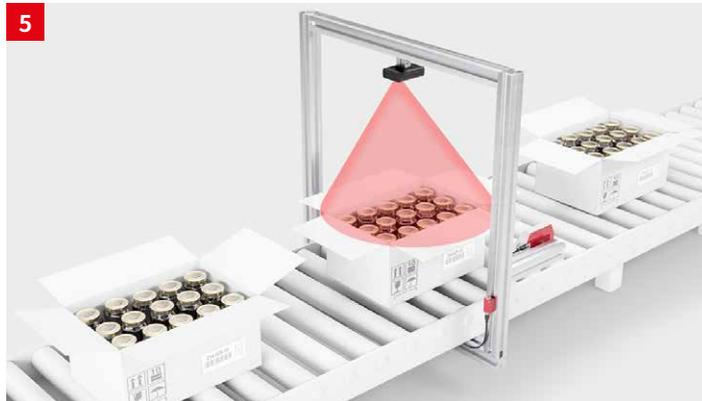
**솔루션:** 산업용 웹캠 LCAM 308은 외부 활성화화를 통해 단색의 이미지를 기록합니다. 이렇게 하면 상자 내용물을 문서화하고 이더넷 인터페이스를 통해 상위 제어장치로 전송할 수 있습니다. 설정은 내장된 웹 브라우저로 수행할 수 있습니다.
