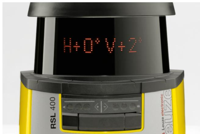
内置电子水平仪可实现设备快速对齐。
