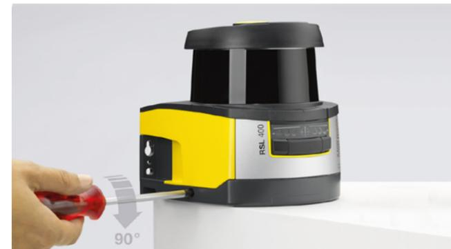
扫描仪更换 30 秒内即可解决: 两个螺丝旋转 90°, 然后更换扫描头。也无需重新校准、重新调整和配置, 因为配置存储器集成在连接单元中。
