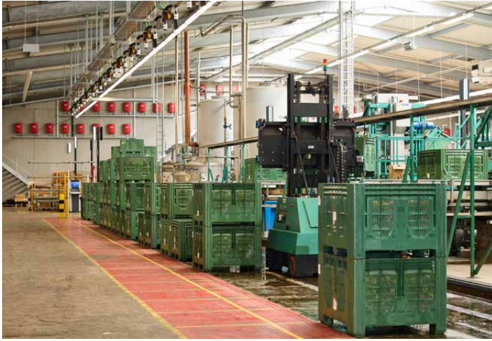
Ein Querverschiebewagen (Binmatic, vorne rechts) nimmt die Kisten mit den sortierten Äpfeln auf und stapelt sie auf der gegenüberliegenden Seite zur Abholung für die Staplerfahrer.
