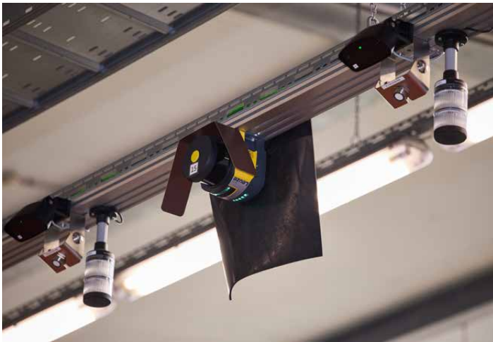
Blick auf die Sicherheitstechnik im Übergabebereich: Ein Sicherheits-Laserscanner RSL 400 von Leuze (Mitte) erzeugt ein Schutzfeld und deckt damit gleich zwei Übergabestationen ab. Zusätzlich sind an jeder Station ein Ultraschallsensor sowie ein Radarsensor montiert (links/rechts des Scanners). Zur Statusanzeige dient jeweils eine Leuchtanzeige.
