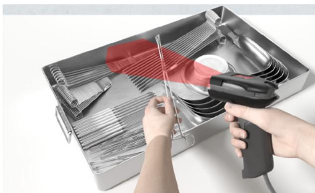
**Solución:** Los lectores manuales IT 1920i y HS 66x8 son resistentes a los productos de limpieza que normalmente se utilizan en este ámbito gracias a su alto índice de protección de la carcasa. Los equipos son compatibles con DPM y pueden leer códigos marcados directamente con fiabilidad.
