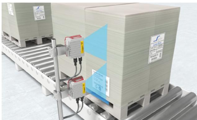
**Solución:** Los lectores de códigos 1D BCL 600i alcanzan un 50% más de profundidad de campo que los equipos con luz roja láser, gracias a su diodo láser azul. La gran profundidad de campo de lectura reduce la sensibilidad en caso de oscilaciones en la distancia y hace innecesario un ajuste en la distancia focal.
