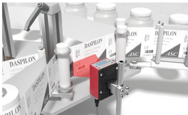
**Solución:** Los lectores de códigos 1D/2D LSIS 462i comparan la posición de impresión del código con una posición definida previamente. Además, gracias al procesamiento de imágenes integrado, pueden comprobar la calidad de impresión y la presencia de texto explícito en las etiquetas.
