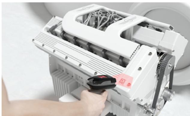
**Solución:** Los lectores manuales IT 1920i y HS 66x8 pueden soportar entornos de aplicación muy exigentes gracias a su alto índice de protección de la carcasa. Los equipos son compatibles con DPM y pueden leer códigos marcados directamente con fiabilidad.
