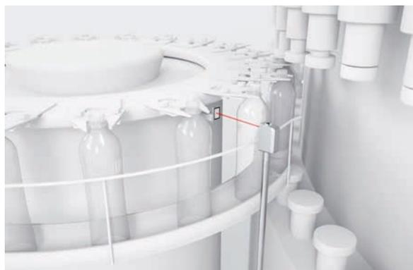
Die Reflexionslichtschranke PRK33C.PPTT3 der Serie 33C eignet sich zur Detektion transparenter Flaschen in einer aseptischen Abfüllung. Das Hygiene-Design mit besonders glatterm Gehäuse ohne Befestigungsbohrungen verhindert Ablagerungen. Der Sensor wird zudem gasdicht über einen Montagezapfen befestigt.
