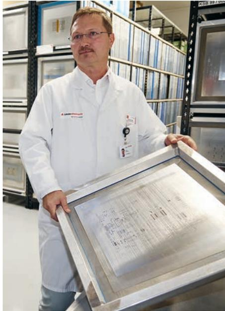
Produktionsleiter Georg Denkinger mit einer Schablone. Sie dient dazu, die Lötpaste gezielt auf die Leiterplatten aufzubringen.
