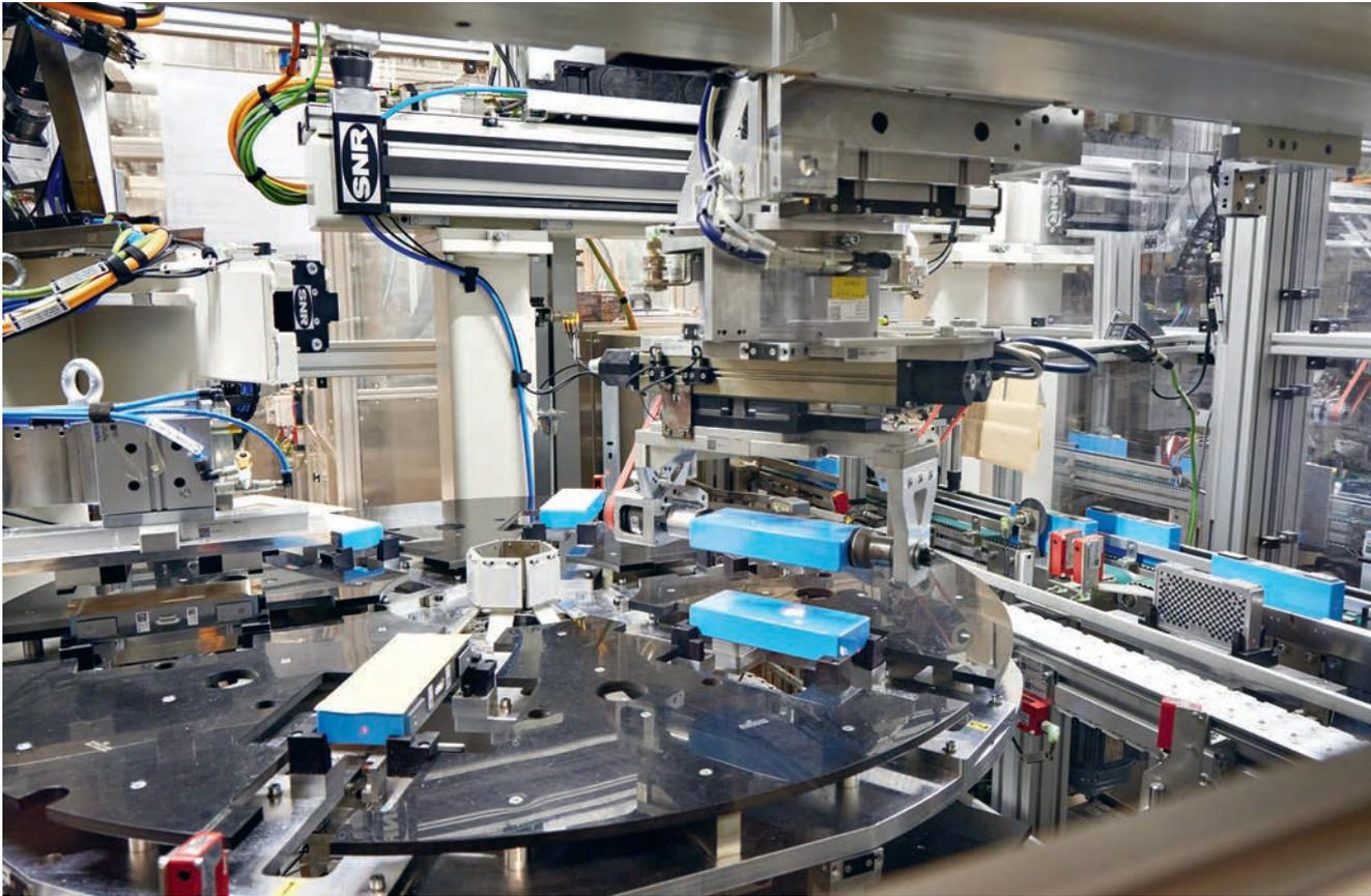
An dieser Station erhält jede Zelle einen „Heat Shield“ – eine schützende Hitzeisolierung –, die auf die Längsseiten aufgespresst wird. Leuze Reflexionslichtschranken PRK 25 erkennen die Anwesenheit der Objekte.
