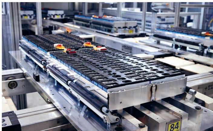
Ein Doppelmodul inklusive Zellkontaktsystem auf der Oberseite. Im letzten Schritt wird ein Kühlaggregat ergänzt. Abschließend geht das Doppelmodul in die Montage. Sensoren von Leuze erfassen die Position der Module auf dem Band.
