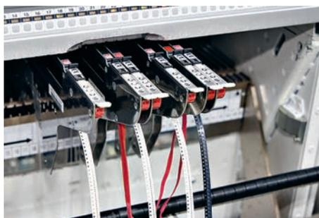
Die elektronischen Standardbauteile befinden sich auf Rollen. Die einzelnen Rollenbänder werden in einen Bestücker geführt. Dieser platziert die Komponenten auf der Leiterplatte.
