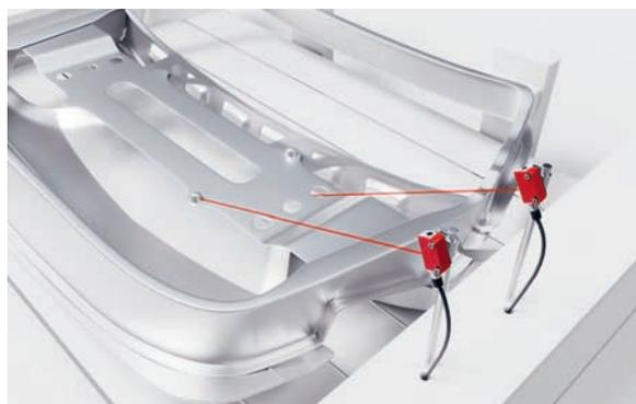
Unsere Laser-Lichttaster ODT3CL1-2M können neben der Anwesenheit des Bauteils auch festgelegte Referenzpunkte an einem Bauteil detektieren und so die Qualität kontrollieren. Dabei arbeiten die Sensoren auch bei verschiedenen Oberflächenbeschaffenheiten zuverlässig.
