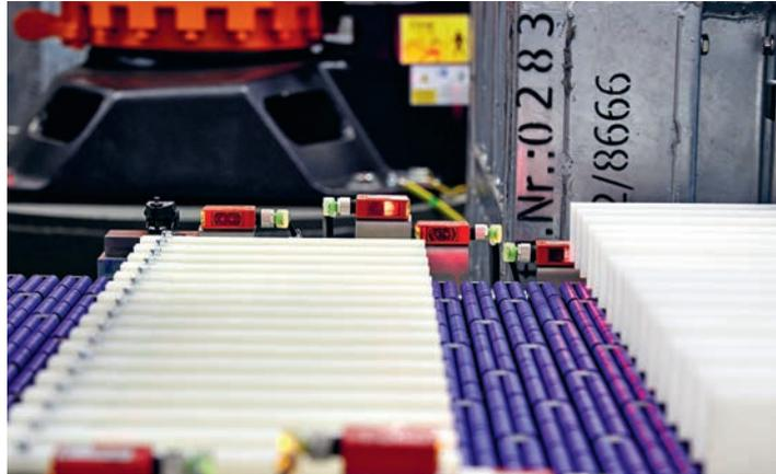
**Bei der Vereinzelung der Zellen erfassen Sensoren die Positionen der Objekte. Das ist Voraussetzung für einen automatisierten Ablauf.**
