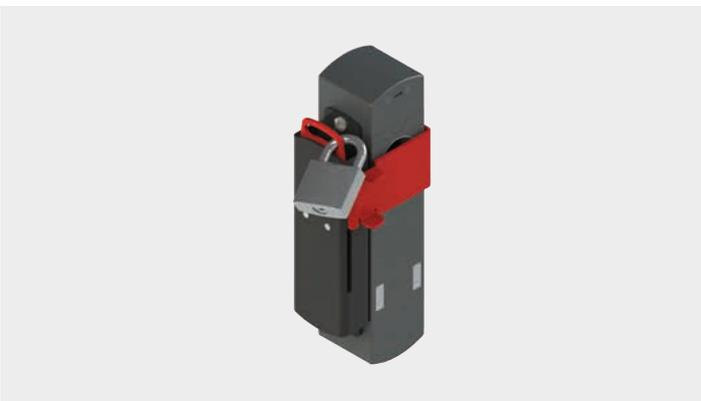
Die vollständig aus Metall gefertigte Lock-Out Tag-Out Vorrichtung verhindert durch die Verwendung individueller Vorhängeschlösser das Einsperren des Betriebspersonals im Gefahrenbereich. Dazu wird der rote Schieber nach oben bewegt und das Schloss eingehängt. So wird die Öffnung mechanisch verschlossen und zusätzlich die RFID-Erkennung des Betätigers abgeschirmt. Bis zu 5 Vorhängeschlösser mit 3,5 mm-Bügel lassen sich in die längliche Öse einhängen.
