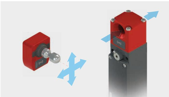
Das Gelenk am Betätiger und die große, gefaste Öffnung am Gerät sorgen für geringe Kollisionsgefahr zwischen Sensor und Betätiger und vermeiden Beschädigungen selbst bei ungenau schließenden Türen. Durch die offene Durchführung werden eventuelle Schmutzansammlungen einfach auf der Rückseite herausgeschoben. So garantiert das spezielle Design höchste Zuverlässigkeit und Verfügbarkeit.
