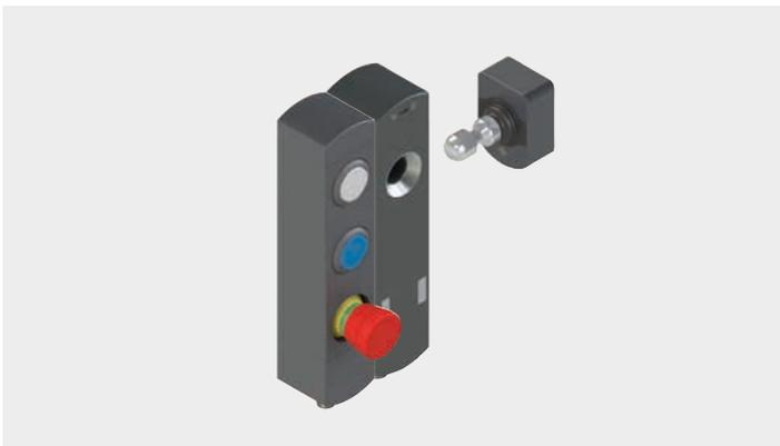
Die optionalen Befehlsgeber CD-B vereinfachen den Aufbau von Sicherheitsfunktionen an Schutz Türen. Befehlsgeber und Zuhaltung verfügen über das gleiche Design mit identischen Abmessungen. So entstehen optisch und funktional optimal aufeinander abgestimmte Module. Mit den integrierten Tasten für Anforderung, Reset und Not-Halt bieten die Module komplette Lösungen für eine Sicherheits-Installation an Zugangstüren.
