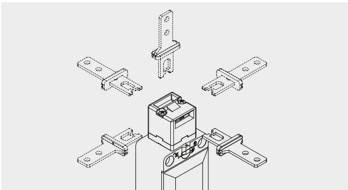
Durch die verstellbare Ausrichtung des Kopfes in 90°-Schritten und die zusätzliche Einführung von oben kann das Gerät mit fünf verschiedenen Anfahrrichtungen für den Betätiger verwendet werden. So ist für unterschiedliche Einbausituationen nur ein Artikel notwendig.
