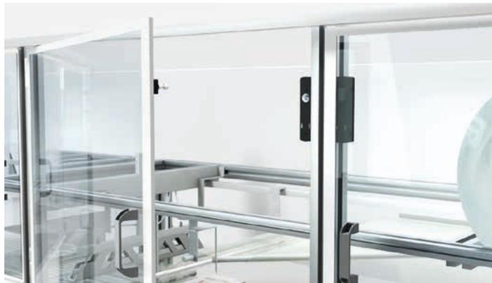
**Lösung:** Die Sicherheitsschalter mit Zuhaltung der L-Serie halten Schutztüren so lange verriegelt, bis die Freigabe über ein elektrisches Signal von der Prozesssteuerung erfolgt ist.
