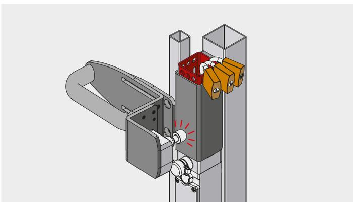
Der justierbare Türgriff mit Rechts- oder Linksanschlag AC-L300-SH sorgt für eine schnelle und einfache Montage der Sicherheits-Zuhaltung L300 an Drehtüren und Schiebetüren. Die äußerst stabile und robuste Metallkonstruktion unterstützt die Vorteile bei der Tür-Zentrierung durch das Gelenk am Betätiger. Eine design-optimierte Alternative bietet der Türgriff AC-L300-SH2 (siehe Abbildung Seite 17 unten).
