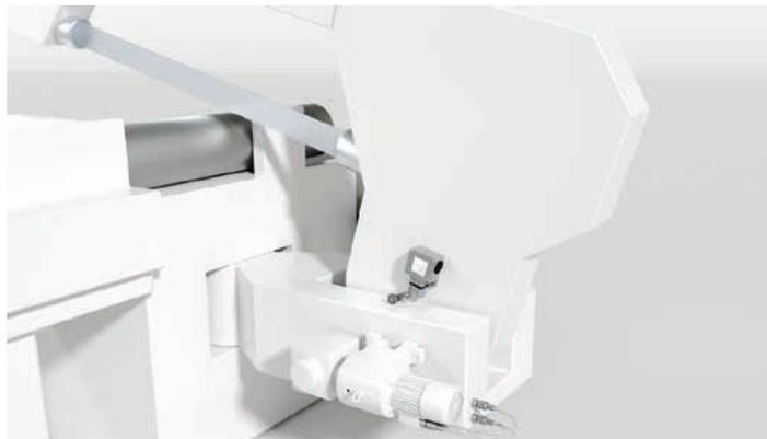
**Lösung:** Der Positionsschalter S300 überwacht das Erreichen der Endlage. Durch Varianten mit Stößel und verschiedenen Betätigern ist das Gerät universell einsetzbar. Mit seinen zwangsgeführten Öffnerkontakten kann der S300 auch direkt in den Sicherheitskreis eingebunden werden.
