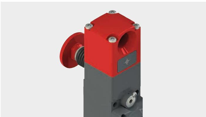
Der optionale Fluchtentsperrungs-Taster (Panic-Button) ermöglicht die sofortige Entriegelung des Betätigers und das Öffnen der Tür aus dem Inneren des Gefahrenbereichs. Der ergonomisch optimierte Taster ermöglicht es dem Bediener den Gefahrenbereich auch dann zu verlassen, falls er versehentlich eingeschlossen wird. Die Vorrichtung funktioniert auch bei fehlender Stromversorgung.
