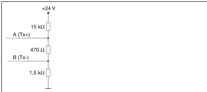
Fig. 5.9: Diviseur de tension pour la terminaison du bus RS 485
