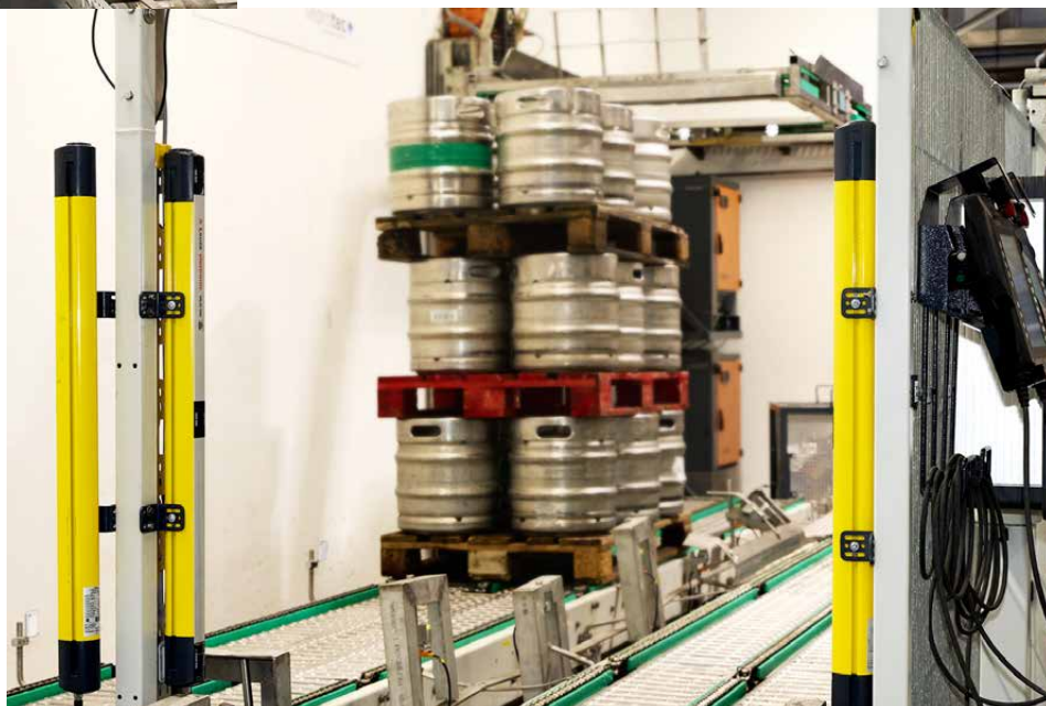
Leuze Mehrstrahl-Sicherheits-Lichtschraken des Typs MLD 500 sichern den Arbeitsbereich der Roboter gegen Zugang von außen ab.
