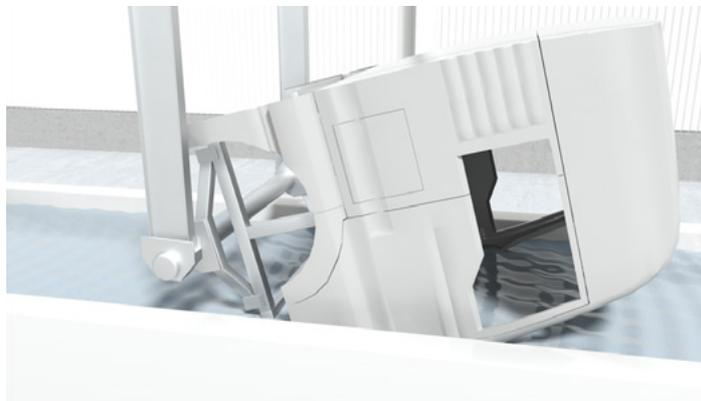
**Solución:** Las ondas RFID del equipo de lectura/escritura RFM pueden atravesar incluso capas de pintura. Los transponders correspondientes aguantan temperaturas de hasta 250 °C.
