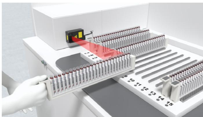
**Solución:** Los lectores de códigos 1D BCL 148 permiten una profundidad de campo de lectura de hasta 310 mm gracias a su ajuste del foco. De este modo, se pueden leer códigos con tamaños de módulo pequeños a largas distancias. La rápida decodificación y lectura por parte del equipo permite una alta velocidad de proceso.
