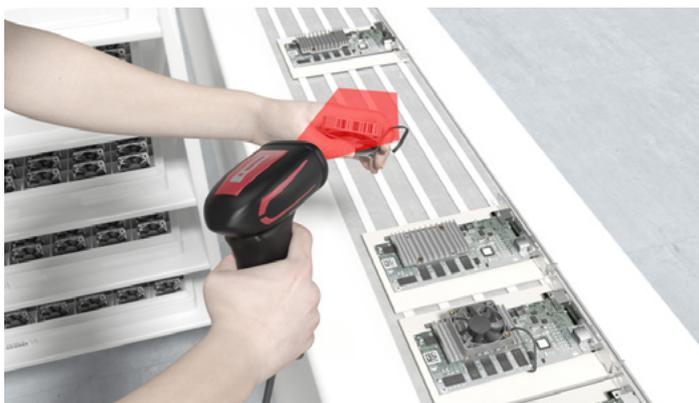
**Solución:** El lector manual IT 1920i DPM lee todos los códigos 1D y 2D convencionales. Los equipos son compatibles con DPM y pueden leer códigos marcados directamente con fiabilidad. Además, el alto índice de protección protege los componentes sensibles para que no sufran daños.
