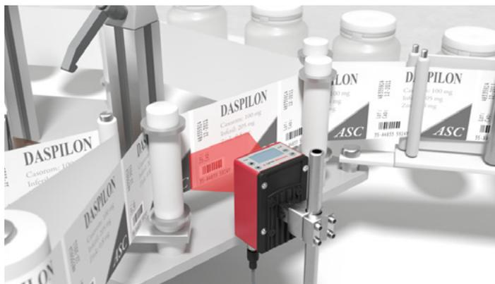
**Solución:** Los lectores de códigos 1D/2D LSIS 462i comparan la posición de impresión del código con una posición definida previamente. Además, gracias al procesamiento de imágenes integrado, pueden comprobar la calidad de impresión y la presencia de texto explícito en las etiquetas.
