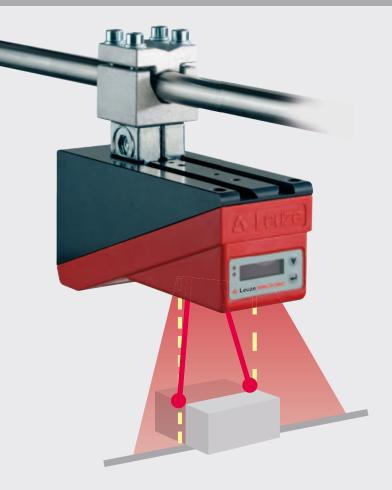
Die LES Sensoren ermitteln die Abmessungen und Position von Objekten über deren Kanten. Über das Erkennen von Höhensprüngen berechnet und überträgt der Sensor exakte Objektpositionen. So werden Höhen und Breiten oder auch die Position als weiterverarbeitbare Daten zuverlässig geliefert. Dabei können über die individuelle Parametrierung eine oder mehrere Kantenpositionen ausgegeben werde.
