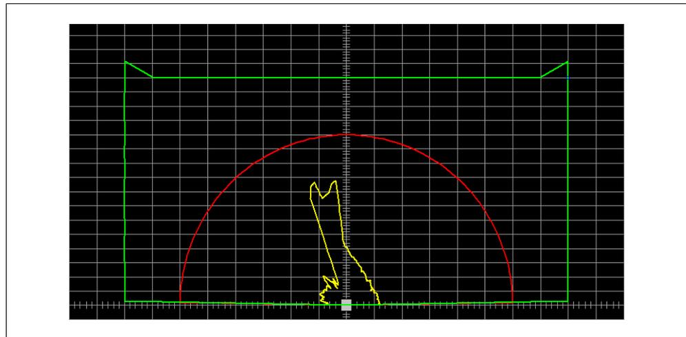
**Polygon** Bei der Schutzfeldform „Polygon“ setzen Sie die Eckpunkte des Schutzfelds direkt. Somit haben Sie die Möglichkeit, bestimmte Objekte, die sich ständig im Scanbereich befinden (z.B. Pfeiler), auszublenden.
