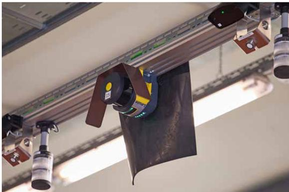
Ein Sicherheits-Laserscanner RSL 400 von Leuze (Mitte) erzeugt ein Schutzfeld und deckt damit gleich zwei Übergabestationen ab. Zusätzlich sind an jeder Station ein Ultraschallsensor sowie ein Radarsensor montiert (links/rechts des Scanners). Zur Statusanzeige dient jeweils eine Leuchtanzeige.
