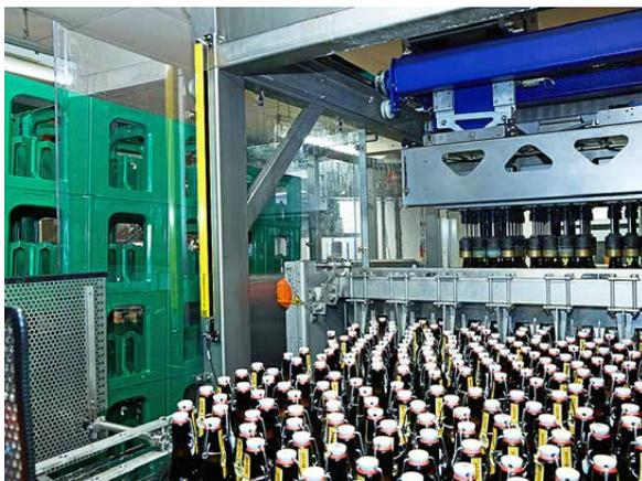
Hier werden fertig befüllte und etikettierte Bügelflaschen in die Kästen gesetzt. Die Maschine bestückt mehrere Bierkisten gleichzeitig.
