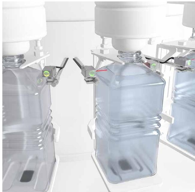
Den Füllstand wässriger Flüssigkeiten in Behältern zuverlässig zu erkennen, zählt zu den anspruchsvollsten Detektionsaufgaben. Hierfür braucht es besonders leistungsstarke Sensorlösungen wie die speziell für diese Applikation optimierten Einweg-Lichtschranken der Baureihe 55C von Leuze.
