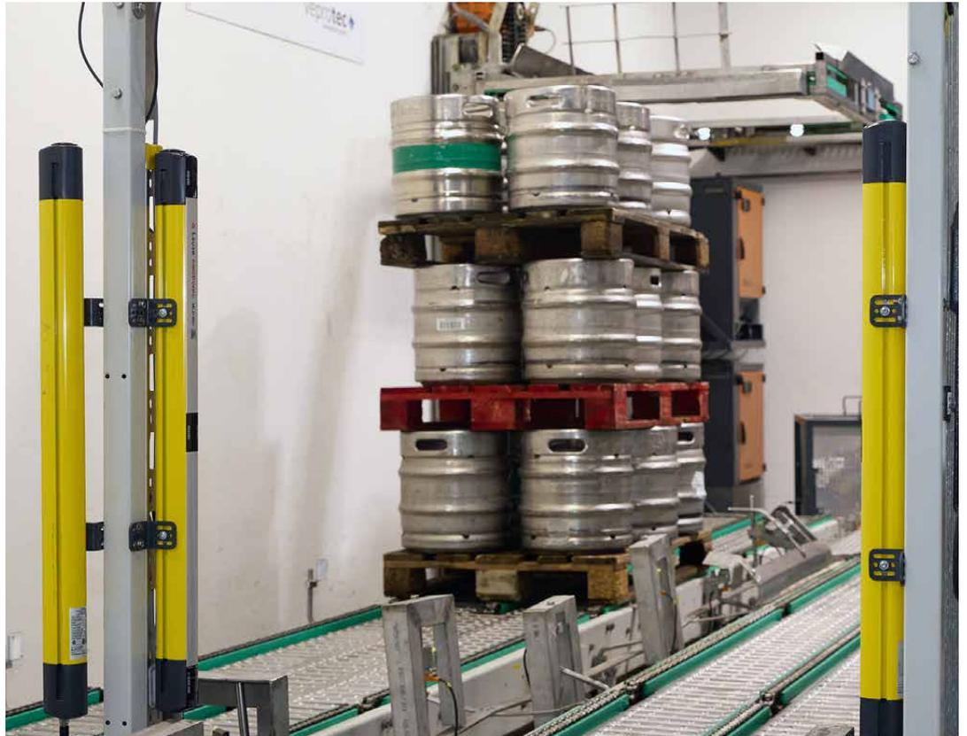
Hier muss keiner schwer heben: In der Fass-Abfüllung greifen zwei moderne Roboter die Bierfässer und setzen sie auf Förderbänder oder Paletten.
