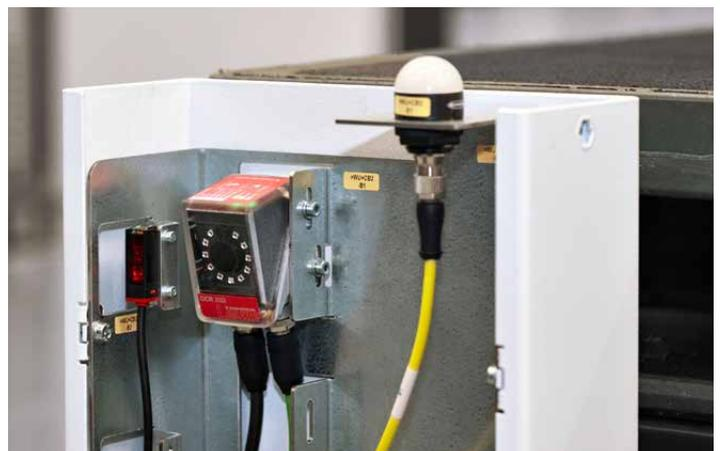
**Unter der geöffneten Abdeckung ist links ein HT5.1/4X zur Anwesenheitserkennung der Palette installiert. Der kamera-basierte Codeleser DCR 202iC (Mitte) erfasst Auftrags- und Materialdaten über den 2D-Code der Palette. Das Signallicht rechts informiert über den aktuellen Status per Farbsignal.**
