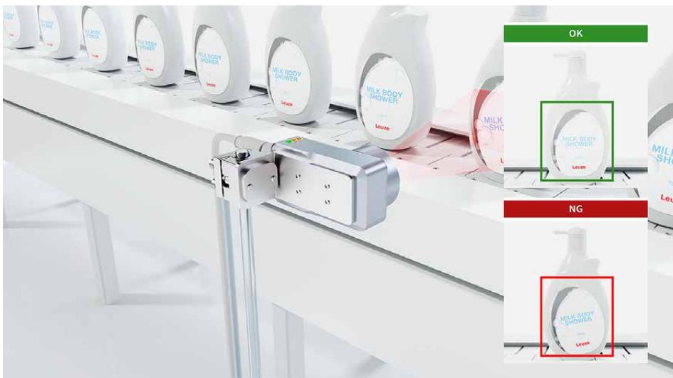
Qualitätskontrolle beim Etikettierprozess: Unser IVS 1048i kann leicht lokalisieren, messen und prüfen, ob das Etikett in der korrekten Position angebracht wurde.
