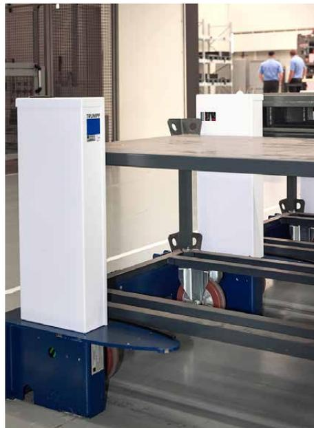
**Eine Docking-Station: Hier lassen sich Rollwagen für Paletten platzieren. Je nach Auftrag holen FTS die Paletten ab oder bestücken die in der Docking-Station geparkten Rollwagen mit neuen Paletten.**
