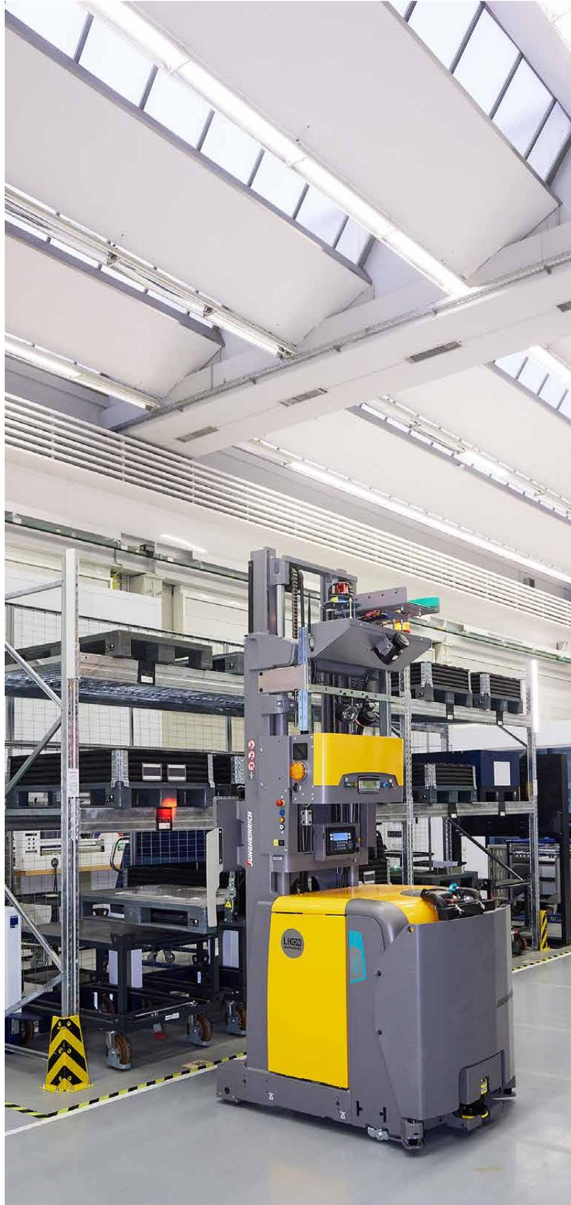
Ein FTS bei der Arbeit – das fahrerlose Transportsystem bestückt eine Docking-Station mit Material.
