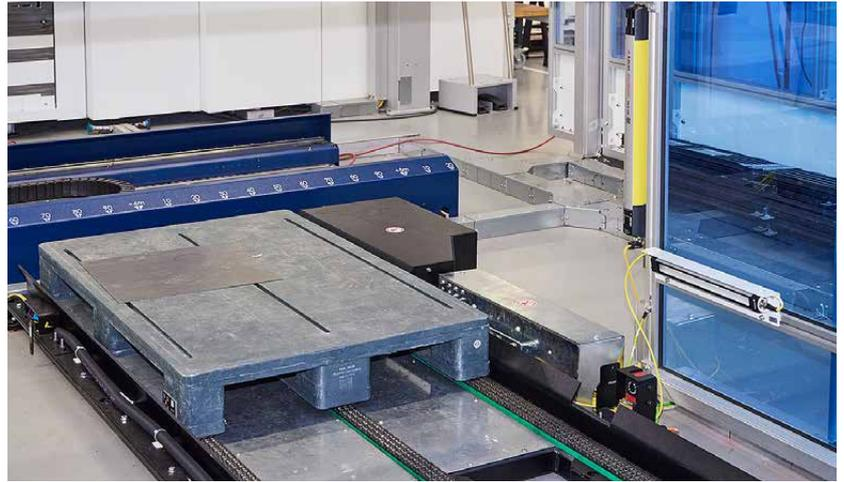
**Eine Mehrstrahl-Sicherheits-Lichtschranke der Baureihe MLD 500 sichert den Zugang ab. Zudem sind ebenfalls Leuze Sensoren zur Anwesenheitserkennung der Paletten sowie zur Auftrags- und Materialdatenerfassung installiert.**
