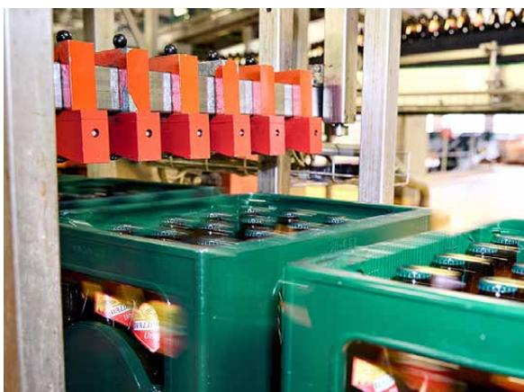
Den Sensoren über dem Förderband entgeht nichts: Fehlt eine Flasche oder liegt eine quer im Bierkasten, erfassen sie das sofort.
