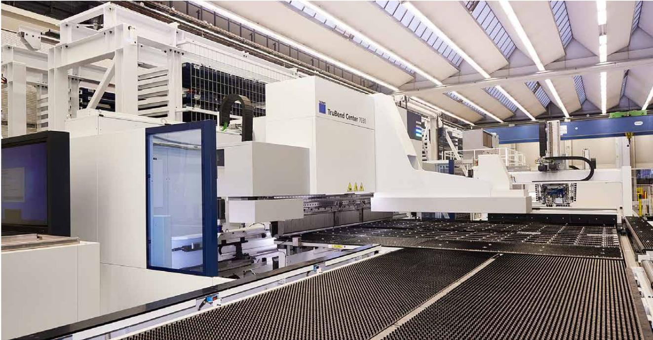
**Moderne Blechbearbeitungsstrecke im Customer Center, im Vordergrund eine TruBend Center 7030, ein vollautomatisches Schwenkbiegezentrum.**
