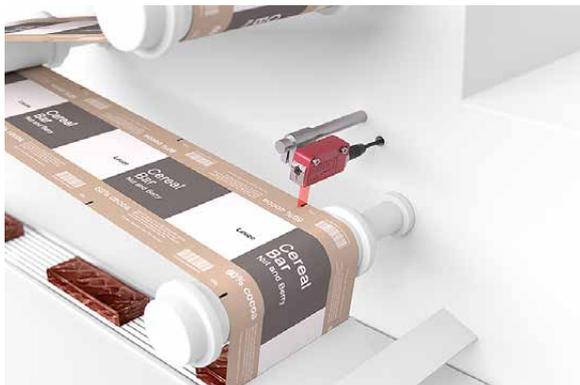
In der Verpackungsindustrie werden Produkte oft in Schlauchbeutel verpackt. Sensoren erkennen die aufgedruckten Kontrastmarken und takten so den Schneidvorgang der Verpackungsfolie. Mit dem KRT 3C gelingt das dank Multicolor-Funktionalität auch bei Materialien mit unterschiedlichen Farb- oder Grauwertkombinationen jederzeit zuverlässig.
