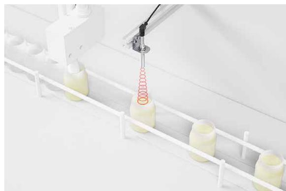
**Unser neuer, kompakter Ultraschallsensor HTU208 in der Bauform einer M8-Gewindehülse hat eine sehr schmale Schallkeule. So kann er Füllstände auch durch sehr kleine Behälteröffnungen überwachen.**
