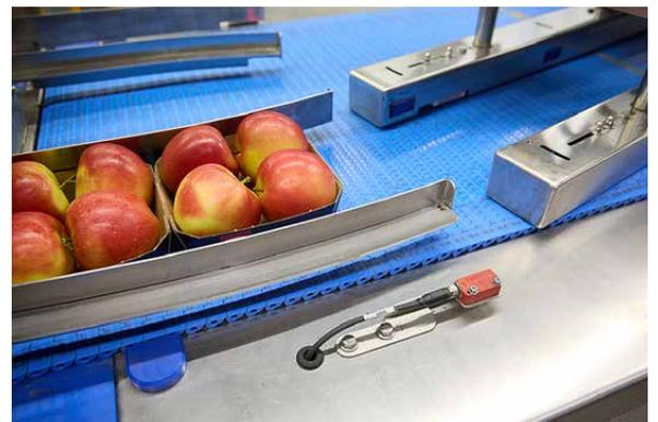
In der Verpackung ist ebenfalls Sensortechnik von Leuze installiert. An den Bandabschnitten installierte PRK-Optiksensoren erkennen die transportierte Ware. So lässt sich die Bandgeschwindigkeit automatisch optimal regeln.
