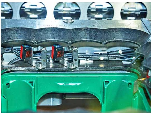
Hier werden die Bügelflaschen bei der Bestückung der Bierkästen ausgerichtet. Dazu erkennt pro Flasche ein Leuze Sensor die Position des Etikettes.
