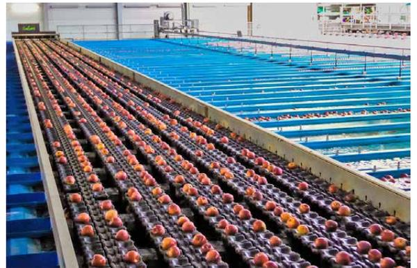
**Nach Prüfung der Qualitätseigenschaften in der Sortiermaschine fahren die Äpfel auf Schalenketten entlang von insgesamt 50 wassergefüllten Kanälen und werden im Kanal mit den entsprechenden Sortierkriterien abgelegt. Bildquelle: Baywa**
