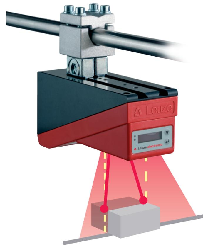
LES 传感器可以通过物体的边缘检测出物体的位置。通过测量物体的高度差, 就可以计算并指出物体的位置。
