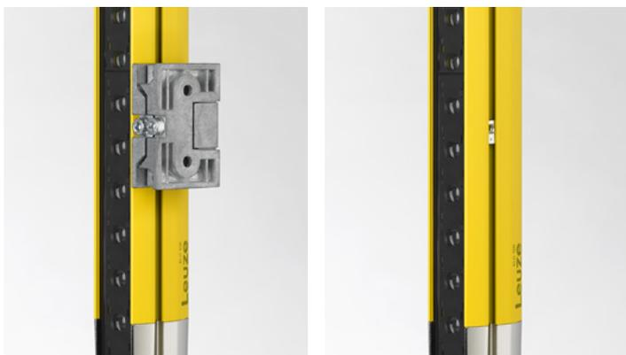
Los soportes robustos, gracias a su función giratoria, facilitan la alineación de los equipos. Estos se montan directamente en las ranuras, que van fijadas a ambos lados de la ELC 100. Si no se requiere ninguna alineación –por ejemplo en aplicaciones con alcances cortos–, se emplean las tuercas correderas incluidas en el volumen de entrega, lo cual reduce aún más los costes.
