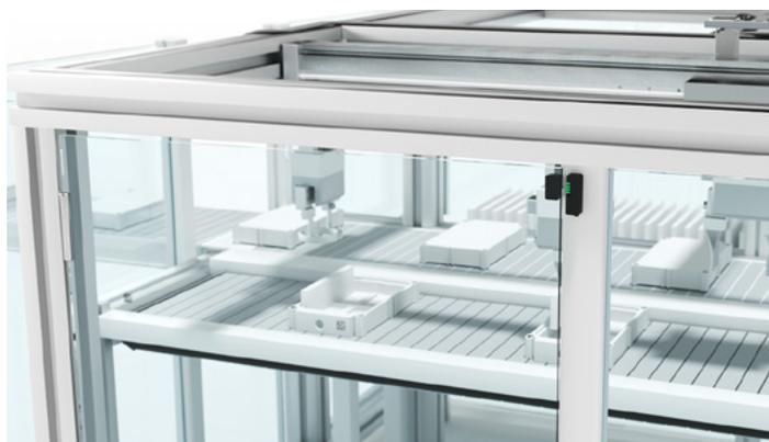
**Solución:** Los transponders de seguridad sin contacto RD 800 ofrecen una protección elevada contra manipulaciones gracias a la codificación RFID. Además, gracias a sus salidas OSSD son fáciles de integrar en el circuito de seguridad.
