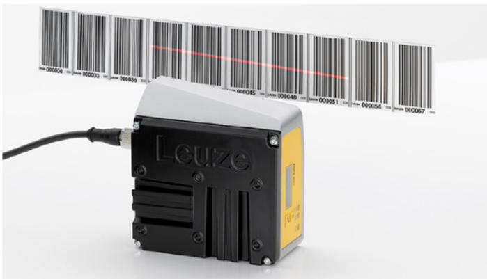
El FBPS 600i funciona de modo especialmente fiable. Con cada proceso de escaneo se leen varios códigos, a partir de los cuales el software determina valores de posición muy exactos. Debido a la trayectoria oblicua del haz de exploración y al movimiento del equipo, cada código se escanea en diferentes puntos. De este modo, se evitan errores de lectura causados por la suciedad o los daños locales.
