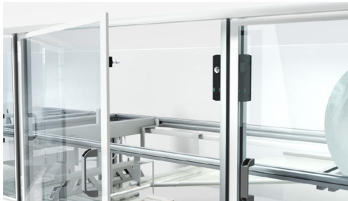
**Solución:** Los micros de seguridad con enclavamiento de la serie L mantienen enclavadas las puertas de seguridad hasta que se produce la liberación mediante una señal eléctrica del controlador de procesos.
