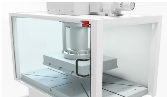
**Solución:** Los micros de seguridad sin enclavamiento de la serie S20/200 se pueden utilizar de manera universal gracias a sus carcavas robustas y las diversas posibilidades de montaje. Los interruptores con codificación magnética sin contacto de la serie MC se utilizan especialmente en entornos húmedos, adversos o propensos a ensuciarse.
