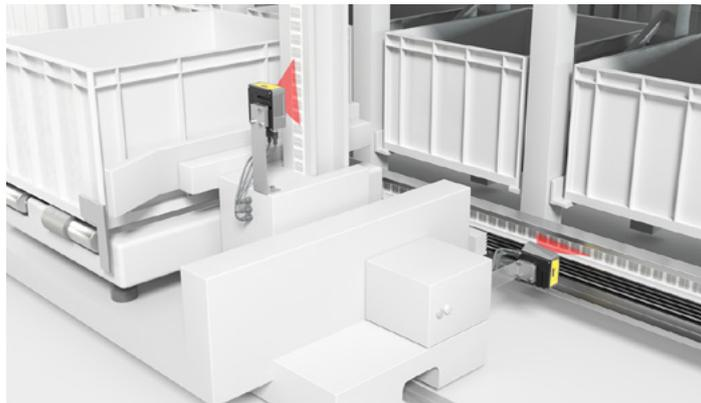
**Solución:** El sistema de posicionamiento por códigos de barras a prueba de errores FBPS 600i ofrece una detección segura de la posición con un solo equipo. Está certificado como equipo de seguridad y cumple con los requisitos para PL e/SIL 3. De este modo, se pueden implementar las funciones de seguridad con facilidad.
