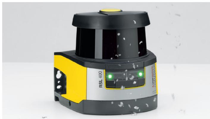
Gracias a la alta resolución angular de 0,1°, el RSL 400 es capaz de filtrar de forma óptima objetos no relevantes para la seguridad como el polvo y las partículas en suspensión (exploración 3 veces superior a la de otros escáneres convencionales). Así se reducen las desconexiones innecesarias.
