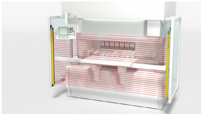
**Solución:** Las cortinas ópticas de seguridad MLC 530 disponen de las funciones de blanking fijo, blanking flotante y reducción de resolución. Al configurar dichas funciones, se permite que ciertos objetos entren en el campo de protección.
