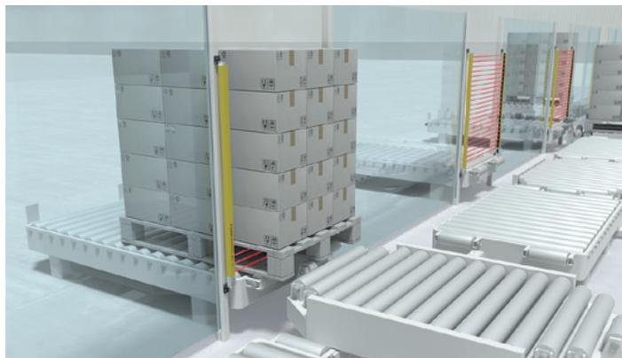
**Solución:** En el caso del Smart Process Gating, la inhibición del sensor de seguridad se lleva a cabo en combinación con una señal de control del PLC. La función viene integrada en la cortina óptica de seguridad MLC 530 SPG. No se requieren sensores de muting adicionales y, gracias al SPG, las instalaciones pueden ser diseñadas para ahorrar espacio.
