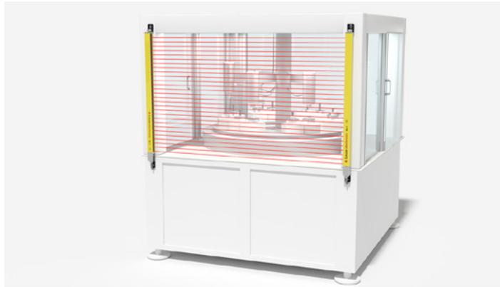
**Solución:** Las cortinas ópticas de seguridad de la serie MLC ofrecen una detección segura de los dedos y de las manos con distintas resoluciones de 14 a 40 mm. Esto permite implementar pequeñas distancias de seguridad entre el sensor de seguridad y el punto peligroso.
