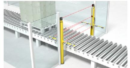
Muting de 4 sensores con control temporizado. Para entradas y salidas. Con requisitos elevados, p. ej., en cuanto a la forma y la ubicación de la carga. Los sensores de muting están alineados paralelamente.
