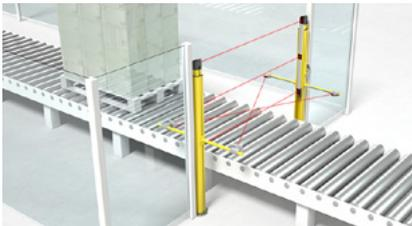
Muting de 2 sensores con control temporizado. Solución universal para entradas y salidas. Los sensores de muting están alineados en forma de cruz.
