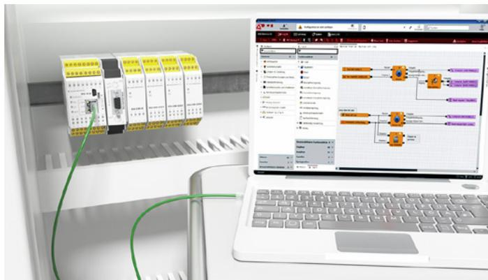
**Solución:** El control de seguridad ampliable MSI 400 dispone ya en el módulo básico de 24 entradas/salidas seguras, así como de una interfaz Ethernet con protocolos Ethernet industriales. Gracias al software de configuración de licencia gratuita MSI.designer, la configuración se lleva a cabo de forma rápida y eficiente.
