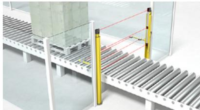
Muting de 2 sensores, con control secuencial. Solo para salidas. Con requisitos elevados, p. ej., en cuanto a la forma y la ubicación de la carga. Los sensores de muting están alineados paralelamente.
