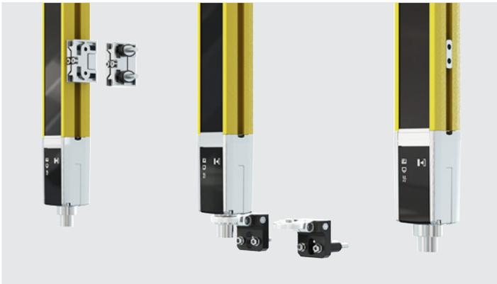
Varios soportes garantizan que el montaje sea sencillo y rápido en cualquier situación de instalación. Los diseños están dimensionados para ocupar poco espacio y facilitar la alineación. Las versiones con elementos de amortiguación adicionales reducen la transmisión de sacudidas y vibraciones, y garantizan un funcionamiento fiable incluso bajo condiciones exigentes.
