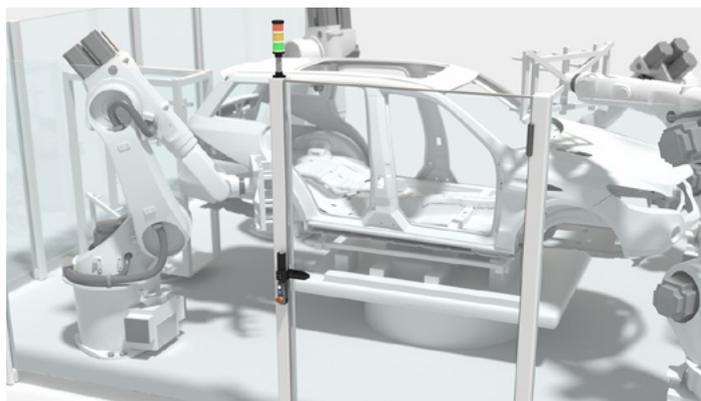
**Solución:** Los robustos micros de seguridad con enclavamiento de la serie L mantienen las puertas de seguridad bien enclavadas hasta que se libera el acceso mediante una señal eléctrica. La serie consta de diseños estándar, equipos con elementos de uso integrados, así como equipos con actuador con codificación RFID.
