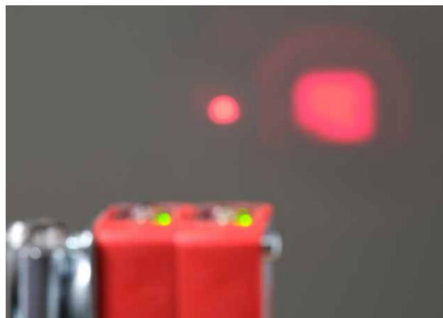
Linker Lichtfleck mit neuester Leuze PowerPinPoint-Technologie für erhöhte Trennschärfe, optimierte Erkennung kleiner Objekte und höhere Reichweite. Rechter Lichtfleck mit konventioneller Technik
