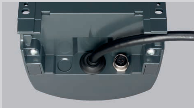
ケーブル用のコネクタと基本設定及びネットワーク設定を保存するためのメモリを備えたコネクタユニット
