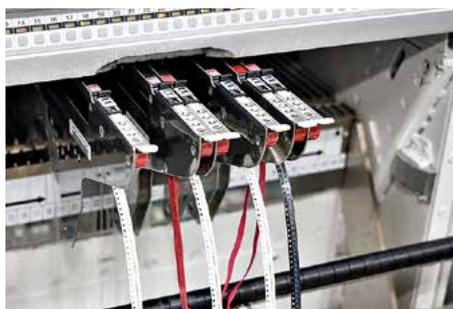
Les composants électroniques standard sont situés sur des rouleaux. Les bandes transporteuses individuelles sont introduites dans une machine de placement. Cela place les composants sur la carte de circuit imprimé.
