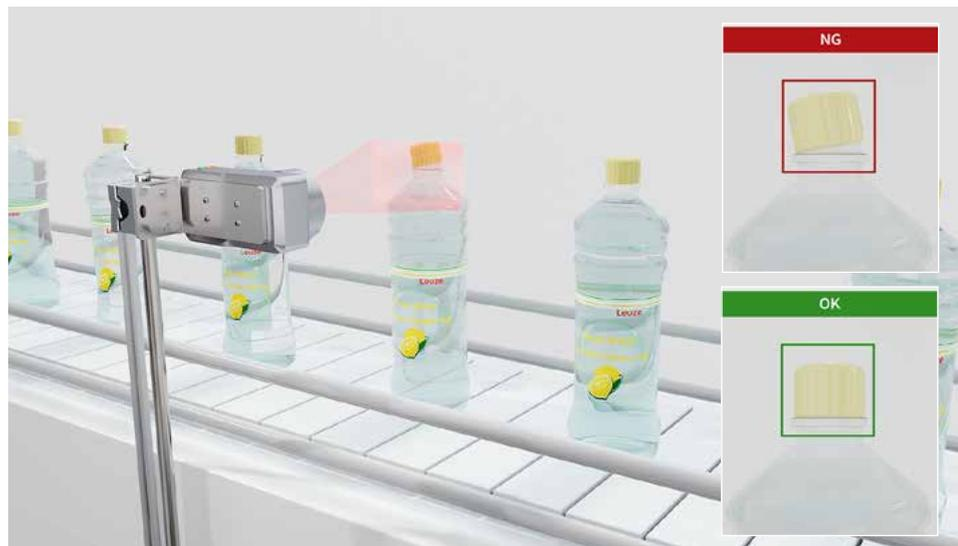
L'IVS 108 de Leuze convient à toute application nécessitant de vérifier la présence ou l'absence d'objets. Par exemple, des bouchons de bouteilles, des étiquettes ou des empreintes sur des bouteilles ou des flacons dans les systèmes de remplissage. Il permet également de contrôler l'orientation correcte des objets, quels que soient leurs formats, matériaux, couleurs ou dimensions.
