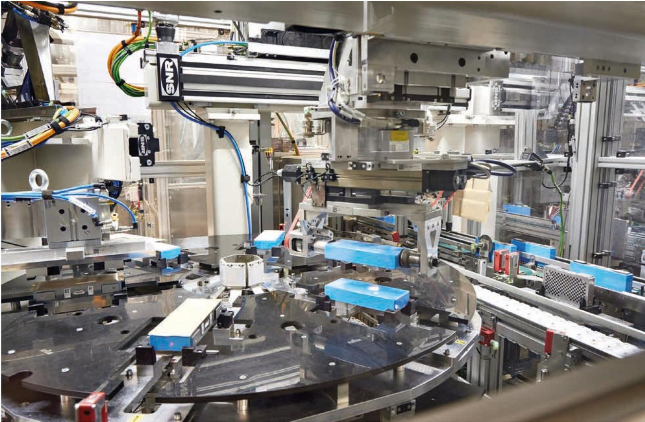
Chaque cellule reçoit également un « Heat Shield », une isolation thermique de protection, qui est pressé longitudinalement. Des barrières lumineuses à réflexion PRK 25 détectent la présence d'objets.
