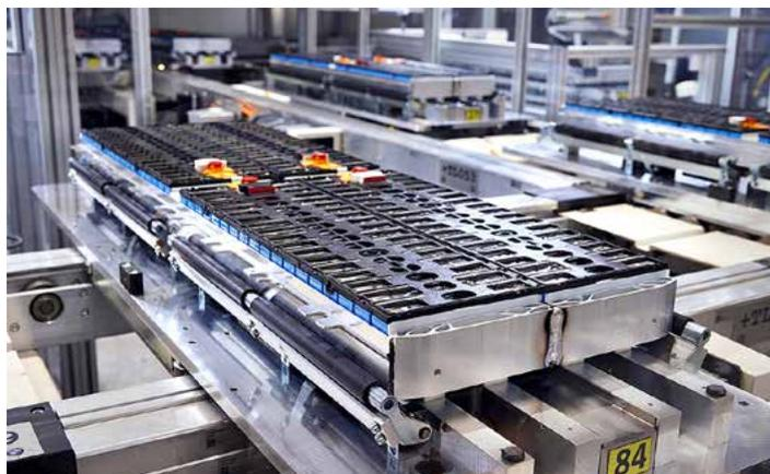
Un double module comprenant un système de contact cellulaire sur le dessus. Dans la dernière étape, une unité de refroidissement est ajoutée. Le module double se rend ensuite dans la zone d'assemblage. Les capteurs de Leuze détectent la position des modules sur la courroie.
