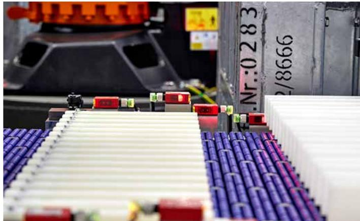
**Lorsque les cellules sont séparées, des capteurs détectent les positions des objets. C'est une condition préalable à un processus automatisé.**
