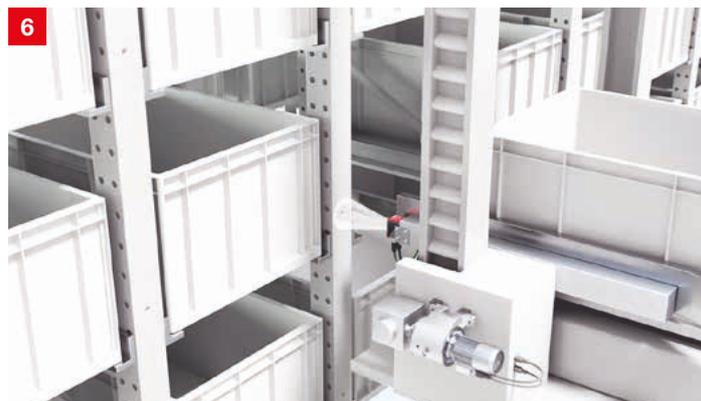
**提案：**IPS200i/400iはシングルまたはダブルデプスの棚の区画位置に対し、クレーンの位置を正確に制御するためのカメラベースセンサーです。Ethernet TCP/IP, PROFINET, またはEthernetIPのインターフェースオプションを持っており、制御系に簡単に組み込むことができ、同様に機器に備わっているWebサーバーを経由して容易にセットアップすることができます。
