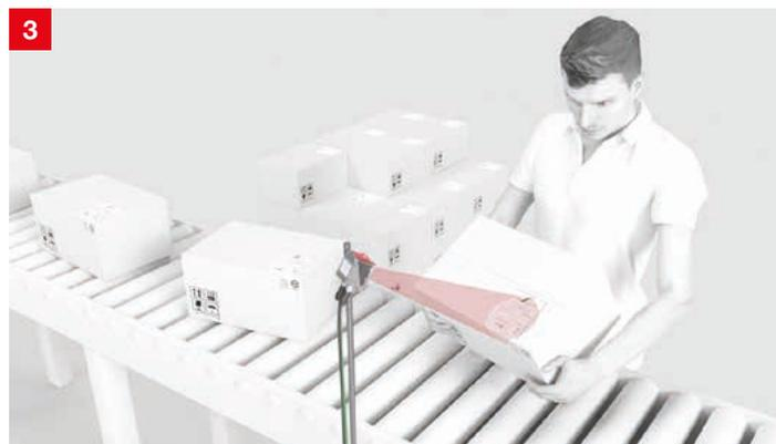
**提案：**DRT200iは小型のカメラベースの固定式コードリーダーです。1Dバーコードと2Dコードの両方を読み取ることができます。装置はコードを提示するだけで認識するので、外部からの起動は必要ありません。フィールドバスへの組み込みを容易にするため、Ethernet TCP/IP, EthernetIP, またはPROFIBUSを標準的に内蔵しています。
