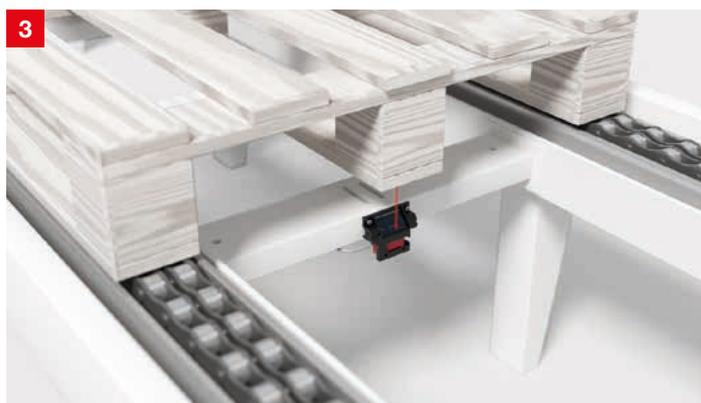
**提案：**拡散反射型センサーHT25Cシリーズは、この用途に使用するための特殊なホルダーが適合するため、既に多くのコンベアシステムメーカーに採用されています。このホルダーはセンサーのフロントスクリーンを埃の影響から守り、外乱光の影響を抑制する効果があります。
