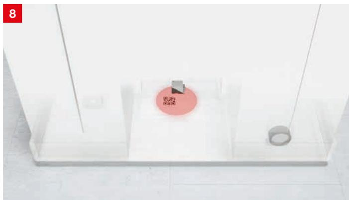
**提案：**2Dコードリーダー DCR200iはAGVがラベル上を通過する際にコードを読み取ります。40～360mmの読取深度を持ち、AGVに柔軟に組み込み、安定した動作を実現することができます。セットアップウィザードが本体内に組み込まれており、短時間で設定を完了させて簡単に実用を開始することができます。
