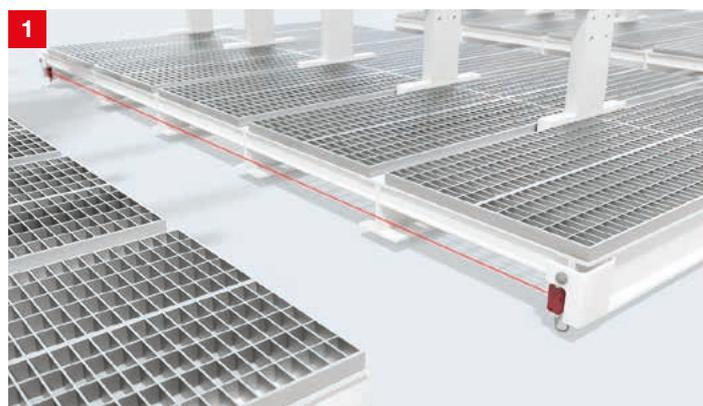
**提案：**SLS46Cは最大70mの距離を保護できるシングルビームタイプの安全デバイスで、足元の監視に最適です。隣接するセンサーセットとの干渉を避けるため、赤線タイプと赤外線タイプを使い分けることができます。
