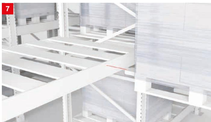
**提案：**拡散反射型センサ HT3Cは検出対象の物性に関わらず、適切なポイントで正確にスイッチングします。デジタル出力信号を2個備えており、同じセンサーを荷役アタッチメントの位置調整にも用いることができます。
