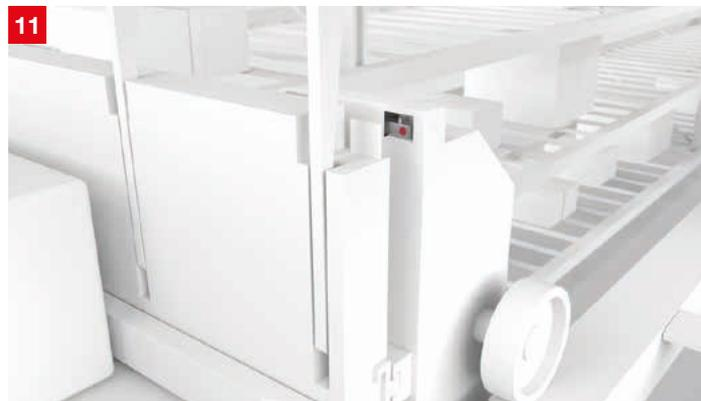
**提案：**IS288は様々なセンシングタスクに用いられる四角柱型の近接スイッチセンサーです。筐体はプラスチック製または金属性から選択でき、縦向きに搭載できるので、取り回しが良いことが特徴です。
