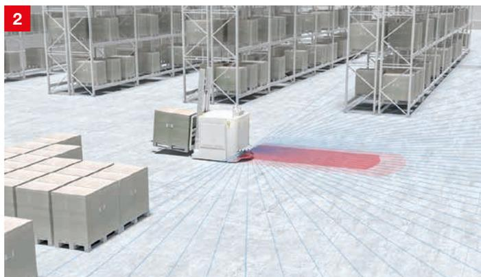
**提案：**RSL400iは1台のデバイスに安全テクノロジーと高精度測距機能を統合した高性能スキャナーです。最大100通りの保護フィールドを形成すると同時に、0.1°の角度分解能で高精度の測距データを取得するため、非常に精度の高い環境マップを形成することができます。
