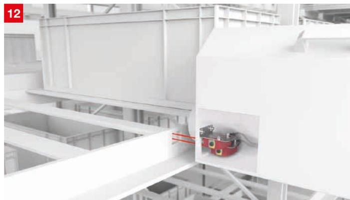
**提案：**小型でパワフルな3Cシリーズの拡散反射型タイプが安定したセンシング動作を保証します。穴の背景の条件によってセンシングの結果が変化しないよう背景抑止の機能を持ち、小径のレーザーを採用することで穴の端部の精密な位置でスイッチング出力を出すことができます。
