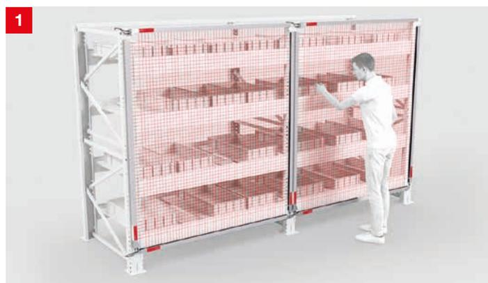
**提案：**測定用のライトカーテン CML700iを推奨します。最大2,960mmの長さ、5mmの精度に対応し、ビームが干渉された位置を測定して検出することができます。インターフェースを内蔵しているため、既存のフィールドバスへの組み込みを容易に行える点も大きな特徴です。
