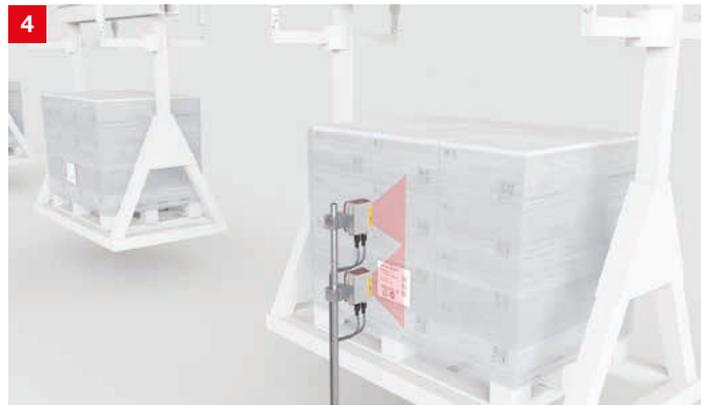
**提案：**BCL500i/600iパレットに施されたコードの読取に最適化されたバーコードリーダーです。機器に内蔵されたスイッチによって、機器同士から制御側までをライン構造でダイレクトに接続することができます。オプションが豊富であり、必要な読取距離に応じて最適な光学仕様を選択することができます。
