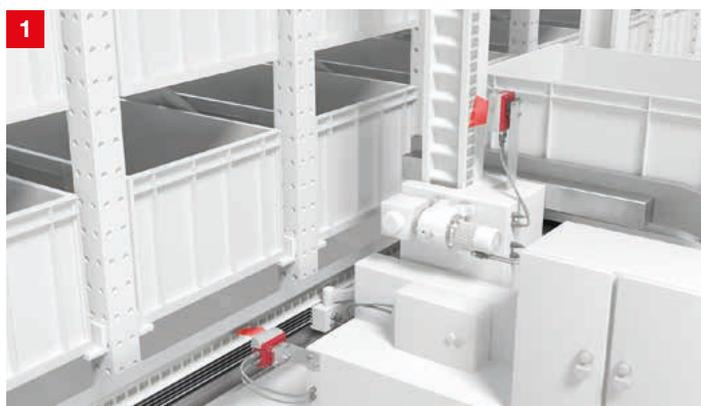
**提案：**BPS 300i は正確な位置情報を提供するコンパクトなバーコードポジショニングシステムです。産業用Ethernet、SSIまたはシリアル接続によるフィールドバス通信機能がシステムの制御をシンプルでフレキシブルにします。デバイスの設定と診断も同様に簡単です。
