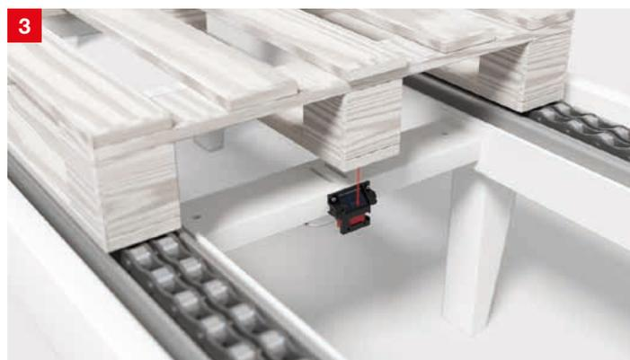
**Lösung:** Die Lichttaster der Serie HT 25C werden bereits beim Hersteller der Fördertechnik im Innenbereich des Förderers mittels eines Spezialhalters montiert. Dieser verfügt über eine integrierte Frontscheibe zur Ableitung von Schmutzpartikeln. Durch die spezielle Fremdlichtparametrierung der Sensoren werden Fremdlichtquellen effizient ausgeblendet.
