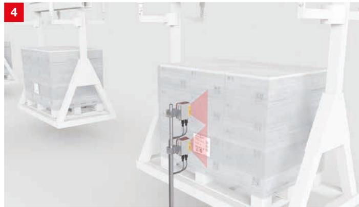
**Lösung:** Die Barcodeleser der Baureihen BCL 500i / 600i lesen die Codes an den Paletten. Über den integrierten Switch können die Geräte sowohl untereinander als auch über eine Linienstruktur direkt an die Steuerung angebunden werden. Durch unterschiedliche Optik-Varianten lassen sich die Geräte zudem optimal an die Leseaufgabe anpassen.
