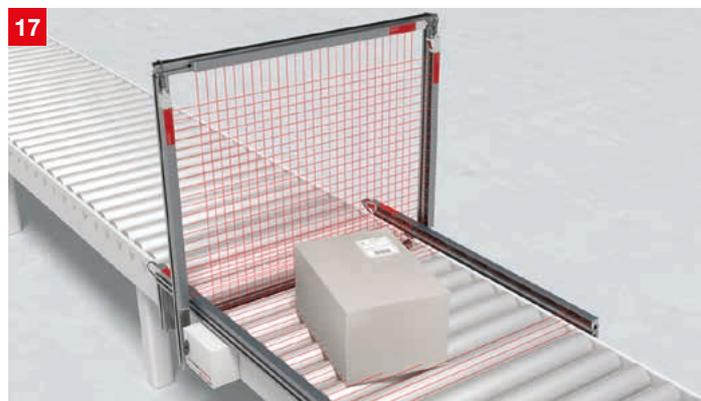
**Lösung:** Das 3D-Konturmesssystem CMS 700i erfasst im Durchlauf Länge, Breite, Höhe, Überstände, Ausbauchungen und Lage beliebiger Objekte – unabhängig von deren Form und Oberflächenbeschaffenheit. Auch Polybags werden prozesssicher erfasst. Das Komplettsystem beinhaltet unter einer Artikelnummer alle Komponenten für die Installation und den Betrieb.
