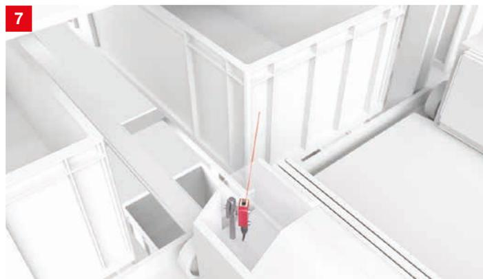
**Lösung:** Die tastenden Sensoren der Serie 3C detektieren zuverlässig Gegenstände vor einem Hintergrund. Auch farblich strukturierte Objekte werden zuverlässig erkannt.
