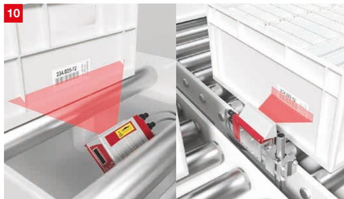
**Lösung:** Die Barcodeleser der Baureihen BCL 200i und BCL 300i lassen sich durch ihre minimale Lesedistanz von nur 40 und 20 mm mit geringem Abstand zum Code montieren. Mit ihrem integrierten Switch lassen sich Linienstrukturen in allen ethernet-basierten Feldbussen aufbauen. Die Parametrierung erfolgt dabei über die Steuerung.
