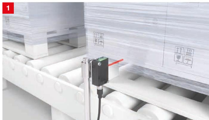
**Lösung:** Die Reflexions-Lichtschranken PRK 46C.D und PRK 25C.D sind für den Einsatz an Rollenbahnen optimiert. Sie bieten speziell bei folienumwickelten und umschumpften Paletten eine hohe Funktionssicherheit. So erzeugt der Sensor ein stabiles Ausgangssignal, solange sich das Objekt im Erfassungsbereich befindet.
