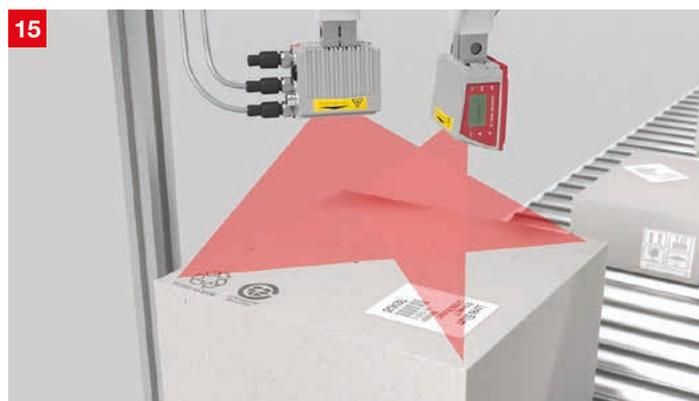
**Lösung:** Das modulare Scanner-Portal MSPi nutzt mindestens zwei zueinander ausgerichtete Barcodeleser für das Lesen nicht ausgerichteter Barcodes. Bei Bedarf bieten wir auch auf Ihre Anwendung zugeschnittene Portal-Konfigurationen an. Über die integrierte Feldbus-Schnittstelle lassen sich die Portale einfach in die Steuerung einbinden.
