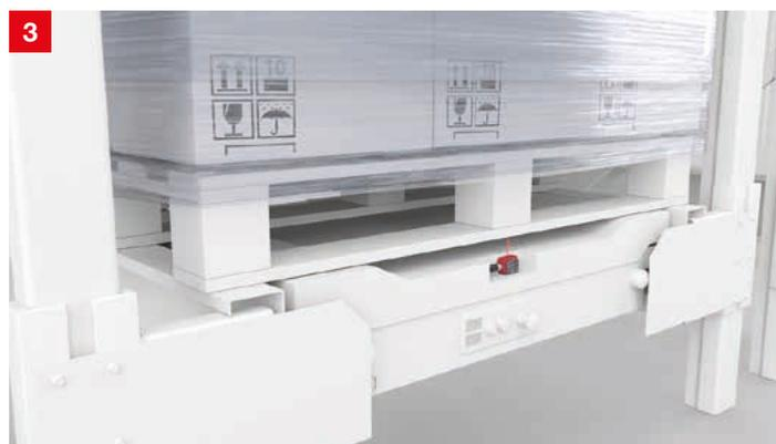
**Lösung:** Die optischen Sensoren HT 3C detektieren durch die aktive Hintergrundausblendung und die Fremdlichtfestigkeit zuverlässig Paletten. Die Serie HT 3C bietet robuste Lösungen, z. B. für die Erkennung von farblich strukturierten Objekten, Objekten mit Durchbrüchen oder mit hochpolierten Oberflächen.
