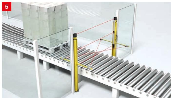
**Lösung:** Die Muting-Funktion überbrückt den Sicherheits-Sensor in kontrollierter Weise für die Durchfahrt des Förderguts. Diese Funktion ist in den Mehrstrahl-Sicherheits-Lichtschranken MLD 300/500 und den Sicherheits-Lichtvorhängen MLC 500 bereits integriert.
