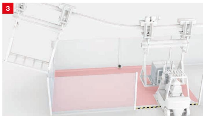
**Lösung:** Die Sicherheits-Laserscanner RSL 400 sichern durch 270° Scanwinkel und bis zu 8,25 m Reichweite auch große Bereiche mit nur einem Gerät. Varianten mit PROFIsafe / PROFINET-Schnittstelle ermöglichen eine einfache Integration in industrielle Netzwerke und erlauben die parallele Überwachung von bis zu 4 Schutzfeldern.
