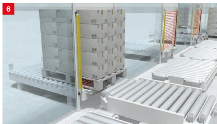
**Lösung:** Bei Smart Process Gating erfolgt die Überbrückung des Sicherheits-Sensors in Verbindung mit einem Steuersignal von der SPS. Die Funktion ist im Sicherheits-Lichtvorhang MLC 530 SPG enthalten. Zusätzliche Muting-Sensoren entfallen, und die Anlagen können durch SPG besonders platzsparend gestaltet werden.
