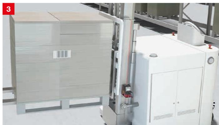
**Lösung:** Das Laser-Positioniersystem AMS 300i liefert alle 2 ms Messdaten mit einer absoluten Genauigkeit von  $\pm 2$  mm. Die Daten können über unterschiedlichste Schnittstellen an die Steuerung übergeben werden.
