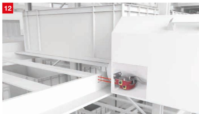
**Lösung:** Die leitungsfähigen Lichttaster mit Hintergrundausblendung der Serie 3C erkennen zuverlässig Objekte vor verschiedensten Hintergründen. Für besonders genaue und schnelle Positionierungsaufgaben stehen Varianten mit Laserlicht zur Verfügung.
