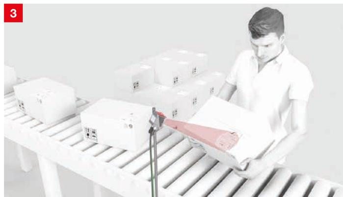
**Lösung:** Der kompakte, kamerabasierte Codeleser DCR 200i liest sowohl 1D- als auch 2D-Codes. Das Gerät erkennt die Codes durch einfaches Präsentieren – eine externe Aktivierung ist nicht notwendig. Für die Feldbusintegration stehen Standard-schnittstellen wie PROFINET, EtherNet/IP und Ethernet-TCP/IP zur Verfügung.
