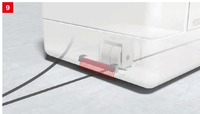
**Lösung:** Der optische Spurführungssensor OGS 600 erkennt mittels Kantendetektion die Spur und sendet entsprechende Signale an die Steuerung. Besonders zuverlässig arbeiten die Geräte in Kombination mit unseren optimierten Spurbändern OTB. Da der Mindestabstand vom Boden nur 10 mm beträgt, lassen sich die OGS 600 platzsparend in die FTS integrieren.
