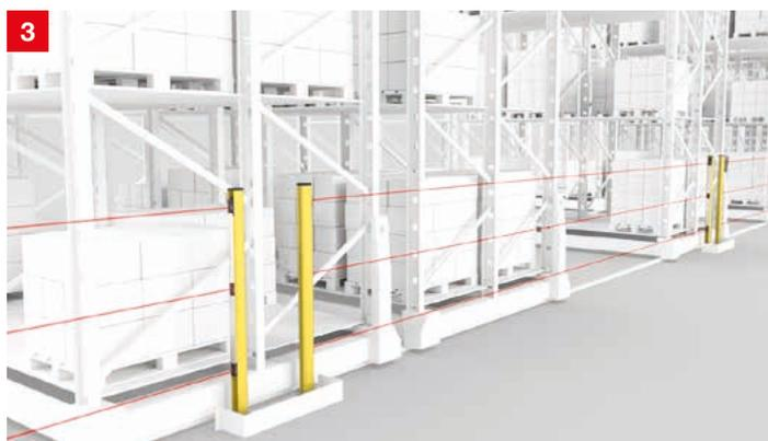
**Lösung:** Die Mehrstrahl-Sicherheits-Lichtschraken der Baureihe MLD 500 werden als Zugangssicherung eingesetzt. Für Reichweiten bis 8 m stehen besonders kosteneffiziente Transceiver-Systeme zur Verfügung, die nur auf einer Seite einen elektrischen Anschluss benötigen. Alternativ bieten Sender-Empfänger-Systeme Reichweiten bis 70 m.
