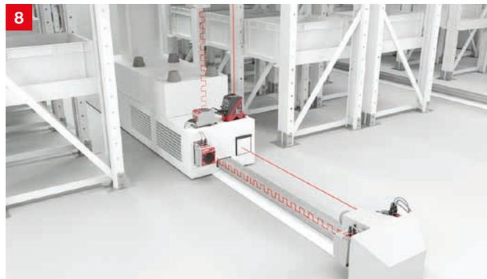
**Lösung:** Die Datenübertragungs-Lichtschanke DDLS 500 mit Industrial Ethernet-Schnittstellen überträgt Daten mit einer Rate von bis zu 100 Mbit/s. Mit dem Ausrichtlaser und der vormontierten Montageplatte lassen sich die Geräte besonders einfach ausrichten, und der integrierte Webserver sorgt für eine schnelle und ortsunabhängige Ferndiagnose.
