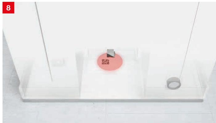
**Lösung:** Der 2D-Codeleser DCR 200i liest die Codes beim Überfahren durch das FTS. Der große Arbeitsbereich von 40–360 mm erlaubt einen flexiblen Einbau in das FTS und sorgt für einen stabilen Betrieb. Durch den integrierten Set-up-Wizard lassen sich die Geräte schnell und einfach in Betrieb nehmen.
