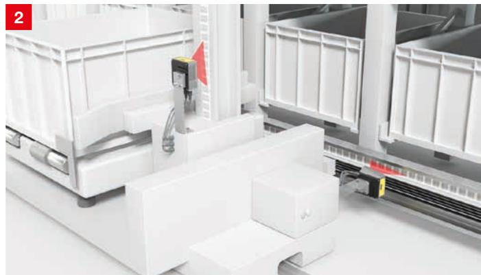
**Lösung:** Mit dem Sicherheits-Barcode-Positioniersystem FBPS 600i ist nur noch ein Sensor für die sichere Positionserfassung notwendig. Das Gerät wird über zwei SSI-Schnittstellen an eine sichere Auswerteeinheit – z. B. eines Frequenzumrichters – angeschlossen und ist für Anwendungen bis PL e geeignet. So lassen sich Sicherheitsfunktionen einfach umsetzen.
