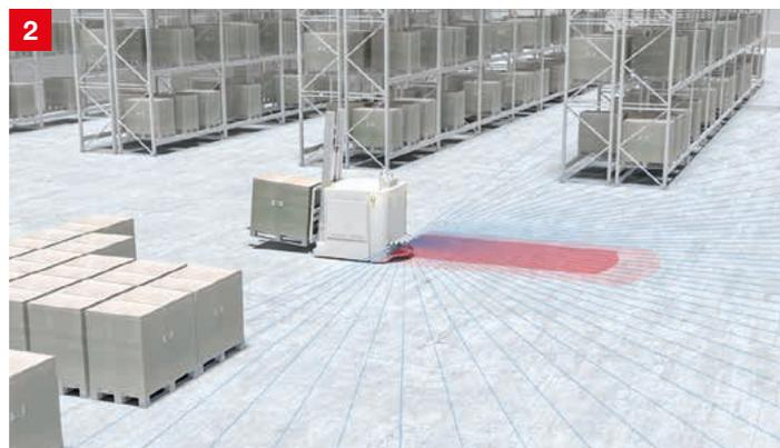
**Lösung:** Der Sicherheits-Laserscanner RSL 400 vereint Sicherheitstechnik und hochwertige Messwertausgabe in einem Gerät. Er verfügt über bis zu 100 umschaltbare Feldpaare. Die Messdaten besitzen eine hohe Winkelauflösung von 0,1°, wodurch sich eine sehr genaue Karte der Umgebung erstellen lässt.
