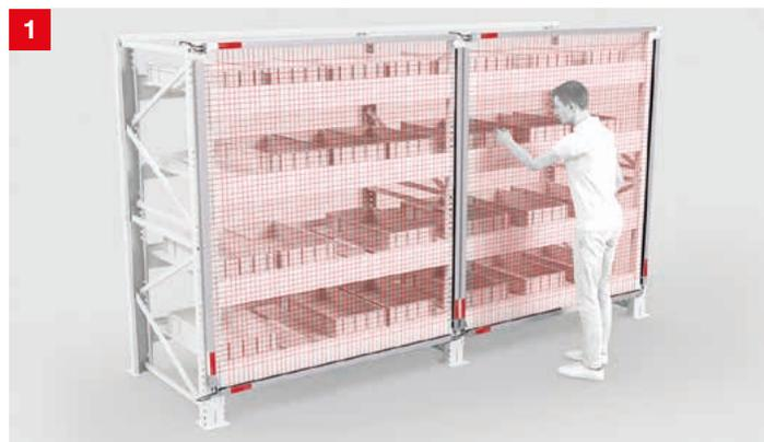
**Lösung:** Die messenden Lichtvorhänge der Baureihe CML 700i überwachen große Regalbereiche mit Messfeldlängen bis zu 2.960 mm und einer Auflösung ab 5 mm. Durch die integrierten Schnittstellen lassen sich die Geräte einfach in verschiedene Feldbusse einbinden.
