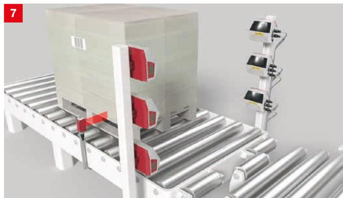
**Lösung:** Für die Lesung des Code-Labels bei variierender Position werden mehrere Barcodeleser der Baureihe BCL 500i / 600i eingesetzt. Über den integrierten Switch können die Geräte sowohl untereinander als auch über eine Linienstruktur direkt an die Steuerung angebunden werden.
