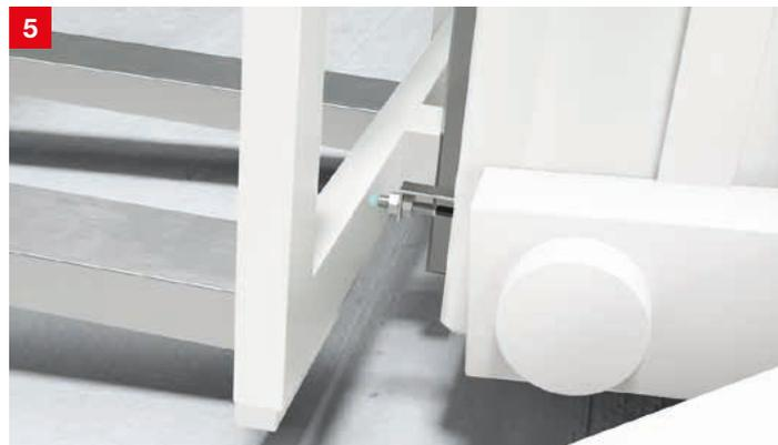
**Lösung:** Die induktiven Sensoren der Serie IS 212 erkennen metallische Objekte mit einem maximalen Arbeitsabstand von 10 mm. Die Geräte sind durch das robuste Metallgehäuse gut gegen Umwelteinflüsse und Reinigungsprozesse geschützt.
