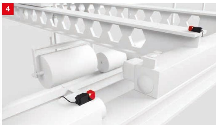
**Lösung:** Die induktiven Sensoren der Serie IS 244 erkennen die Endlage des Krans oder der Laufkatze. Durch ihr in fünf Richtungen ausrichtbares Sensorfeld lassen sich die Geräte flexibel montieren. Für den Anschluss stehen Versionen mit M12-Stecker oder komfortablem Klemmraum zur Verfügung.
