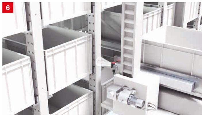
**Lösung:** Die kompakten kamerabasierten Sensoren IPS 200i / 400i werden zur Fachfeinpositionierung vor einfach oder doppelt tiefen Regalfächern eingesetzt. Über die integrierte Ethernet TCP/IP-, PROFINET- oder Ethernet/IP-Schnittstelle lassen sich die Geräte einfach in unterschiedliche Steuerungen integrieren und über den integrierten Webserver leicht konfigurieren.
