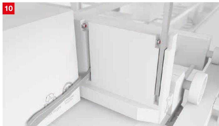
**Lösung:** Die induktiven Sensoren der Serie IS 208 erkennen zuverlässig metallische Objekte. Die kleinen Standard-Geräte mit nur 8 mm Durchmesser und robustem Metallgehäuse lassen sich einfach und individuell in das Shuttle integrieren.
