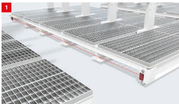
**Lösung:** Die Einstrahl-Sicherheits-Lichtschraken SLS 46C überwachen den Fußraum auf einer Länge von bis zu 70 m. Sie sind als Typ 4- und als besonders einfach auszurichtende Typ 2-Variante erhältlich. Der Einsatz von Modellen mit Rot- und Infrarotlicht verhindert eine gegenseitige Beeinflussung zwischen den Regalreihen.
