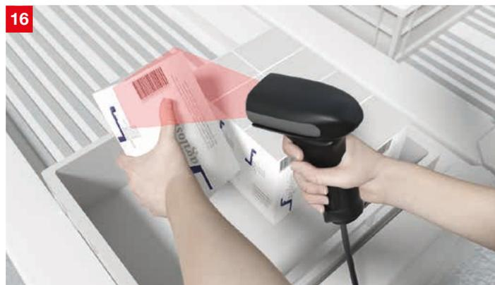
**Lösung:** Die mobilen Barcodeleser der Baureihe IT 1472Xg lesen alle in der Lagerwirtschaft und Logistik gängigen Barcodes. Je nach Einsatzbereich sind Ausführungen mit Kabelanschluss oder Funkübertragung verfügbar.
