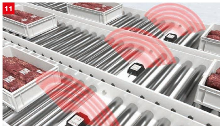
**Lösung:** Die RFID-Schreib-Lesegeräte RFM 32 und RFM 62 lesen die Informationen der RFID-Transponder, die an den Behältern angebracht sind. Die kontaktlose RFID-Technologie arbeitet auch in verschmutzten Umgebungen zuverlässig. Mit Leseabständen bis zu 400 mm können die Lesegeräte dabei sehr flexibel in die Förder-technik integriert werden.
