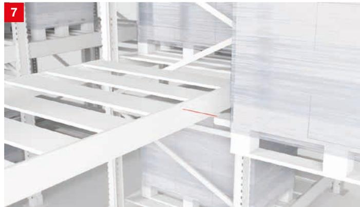
**Lösung:** Die Lichttaster der Serie HT 3C arbeiten unabhängig vom Material und verfügen über präzise Schaltpunkte. Durch zwei digitale Schaltausgänge können die gleichen Sensoren auch zur Positionierung des Lastaufnahmemittels genutzt werden.
