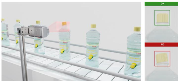
**Solución:** el nuevo sensor Simple Vision IVS 1048i puede determinar si el tapón de la botella está cerrado correctamente con su amplio conjunto de herramientas.
