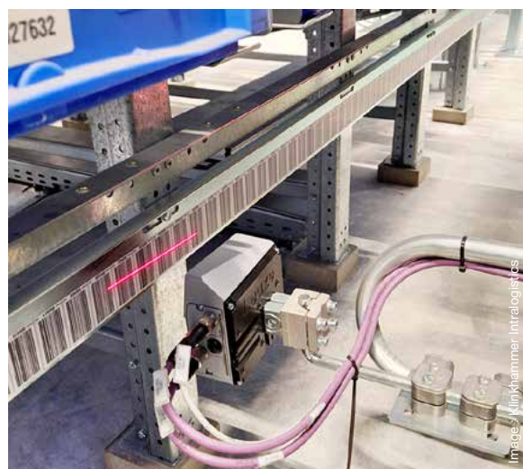
Système de positionnement sécurisé à code à barres Leuze FBPS 607i
