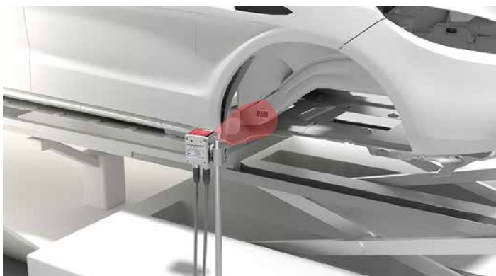
Les lecteurs de codes à caméra utilisant identCHAIN fournissent non seulement une identification individuelle des objets, mais aussi des informations sur les appareils et l'état de chaque étape de la production.
