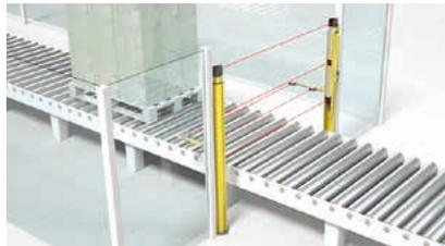
Inhibition à 2 capteurs, séquentielle. Uniquement pour la sortie. En cas d'exigences supérieures, p. ex. concernant la forme et le placement du chargement. Les capteurs d'inhibition sont orientés parallèlement.
