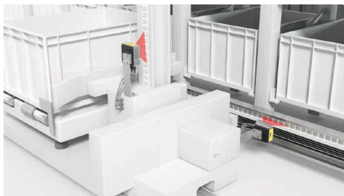
Les FBPS 600i sont particulièrement adaptés à la saisie de position lors de mouvements rapides, par exemple pour une utilisation sur des transtockeurs. Pour cela, les FBPS 600i disposent d'un temps de réaction aux défauts très court de seulement 10 ms. Cela permet d'optimiser les courbes de vitesse et les performances de disponibilité de l'installation.
