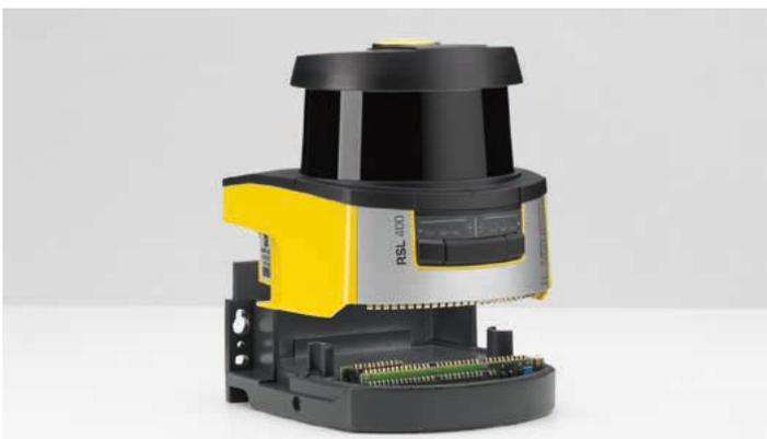
L'unité de branchement du RSL 400 est amovible et peut être montée séparément. La tête de scanner reste ainsi protégée et peut ensuite être mise en place facilement. En cas de maintenance, le scanner est remplacé en moins de 30 secondes. Il suffit de faire tourner deux vis de 90 degrés pour pouvoir changer la tête de scanner. Ce, sans devoir répéter l'alignement, le réglage ni la configuration, puisque la mémoire de configuration est intégrée à l'unité de branchement.
