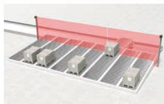
Solutions de sécurité, p. ex. pour la sécurisation des stations de transfert et des accès sur les systèmes de convoyage
