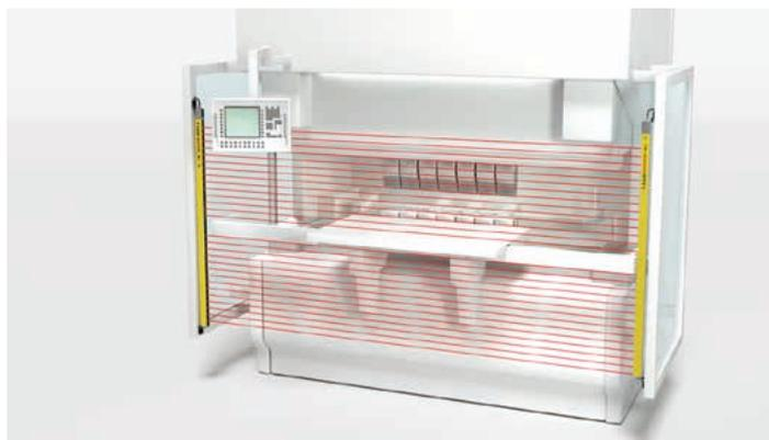
**Solution :** Les barrières immatérielles de sécurité MLC 530 disposent des fonctions de blanking fixe, de blanking flottant et de résolution réduite. La configuration de ces fonctions permet d'autoriser la présence et le mouvement de certains objets dans le champ de protection.
