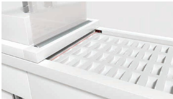
**Solution :** Pour les ouvertures étroites, on utilise des barrages immatériels monofaisceau de sécurité SLS 46C. Ils sont disponibles en variantes de type 2 et de type 4 et peuvent être intégrés facilement au moyen de prises ou de câbles.
