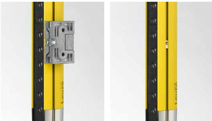
Les supports robustes permettent d'aligner facilement les appareils grâce à leur fonction de pivotement. Ils sont montés directement dans les rainures présentes sur les deux côtés de l'ELC 100. Si aucun alignement n'est nécessaire – par exemple dans les applications à courte portée – les coulisseaux inclus dans la livraison sont utilisés, ce qui permet de réduire davantage les coûts.
