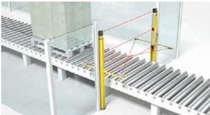
Inhibition à 2 capteurs, temporelle. Solution universelle pour l'entrée et la sortie. Les capteurs d'inhibition sont orientés en croix.
