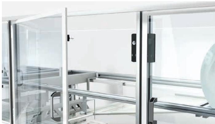
**Solution :** Les interrupteurs de sécurité avec interverrouillage de la série L maintiennent les portes de protection verrouillées jusqu'à ce qu'elles soient déverrouillées par un signal électrique provenant de la commande du processus.
