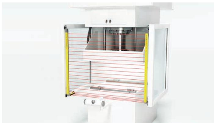
**Solution :** Les barrières immatérielles de sécurité cascadables MLC 520 et MLC 520-S permettent l'enchaînement de jusqu'à 3 segments. Celles-ci sont intégrées à la commande via un raccordement commun. L'installation est ainsi simple et économique.
