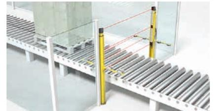
Inhibition à 4 capteurs, temporelle. Pour l'entrée et la sortie. En cas d'exigences supérieures, p. ex. concernant la forme et le placement du chargement. Les capteurs d'inhibition sont orientés parallèlement.
