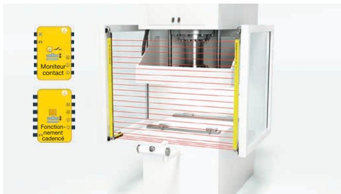
**Solution :** L'outil de configuration MSI.designer offre une bibliothèque de fonctions spéciales pour l'emploi sur les presses hydrauliques et mécaniques. Celle-ci contient des blocs fonctionnels sur mesure pour la commande et la mise en sécurité des presses et permet ainsi une configuration simple et rapide du contrôleur de sécurité MSI 400.
