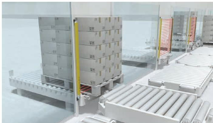
**Solution :** Pour le Smart Process Gating, le capteur de sécurité est court-circuité via un signal de commande provenant de l'API. La fonction est incluse dans la barrière immatérielle de sécurité MLC 530 SPG. Des capteurs d'inhibition supplémentaires ne sont pas nécessaires et, grâce au SPG, les installations peuvent être conçues pour être particulièrement peu encombrantes.
