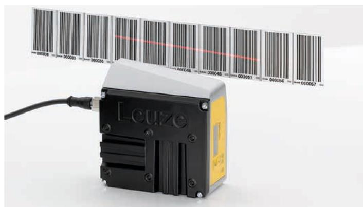
Le FBPS 600i fonctionne de manière particulièrement fiable. À chaque balayage, plusieurs codes sont lus et interprétés par le logiciel pour déterminer des valeurs de position très précises. Grâce à la trajectoire oblique du faisceau de balayage et au mouvement de l'appareil, chaque code est balayé à différents endroits. Ceci permet d'éviter les erreurs de lecture dues à des saletés ou des dommages ponctuels.
