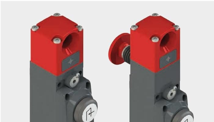
Le déverrouillage de secours (bouton d'urgence) en option permet le déverrouillage immédiat de l'organe de commande et l'ouverture de la porte depuis l'intérieur de la zone dangereuse. Le bouton ergonomique optimisé permet à l'opérateur de quitter la zone dangereuse, même s'il est accidentellement enfermé. Le mécanisme fonctionne également en l'absence d'alimentation électrique.
