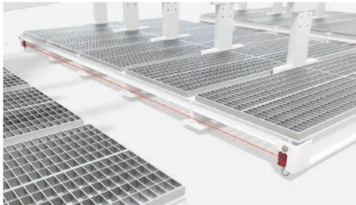
**Solution :** Les barrages immatériels monofaisceau de sécurité SLS 46C surveillent l'espace des pieds sur une longueur pouvant atteindre 70 m. Ils sont disponibles en variante de type 4 et en variante de type 2 particulièrement facile à aligner. L'utilisation de modèles à lumière rouge et infrarouge permet d'éviter les interférences mutuelles entre les rangées de rayonnages.
