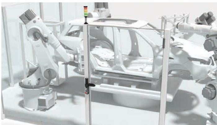
**Solution :** Les interrupteurs de sécurité robustes avec interverrouillage de la série L maintiennent les portes de protection fermement verrouillées jusqu'à ce que l'accès soit libéré par un signal électrique. La série comprend des modèles standard, des appareils avec éléments de commande intégrés ainsi que des appareils avec organes de commande à codage RFID.
