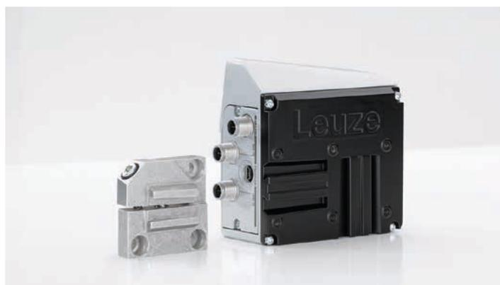
Le système de fixation bien pensé avec concept de remplacement rapide permet aussi un montage simple du FBPS 600i. Les appareils sont solidement fixés sur le support de serrage à l'aide d'une seule vis facilement accessible. Cela permet de gagner du temps lors du montage et de remplacer les appareils rapidement en cas de maintenance.
