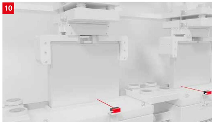
**Lösung:** Die Reflexionslichtschranken PRK 5B detektieren auch spiegelnde Objekte zuverlässig. Durch den homogenen Lichtfleck verfügen die Geräte über ein sicheres Schaltverhalten und lassen sich einfach Ausrichten.
