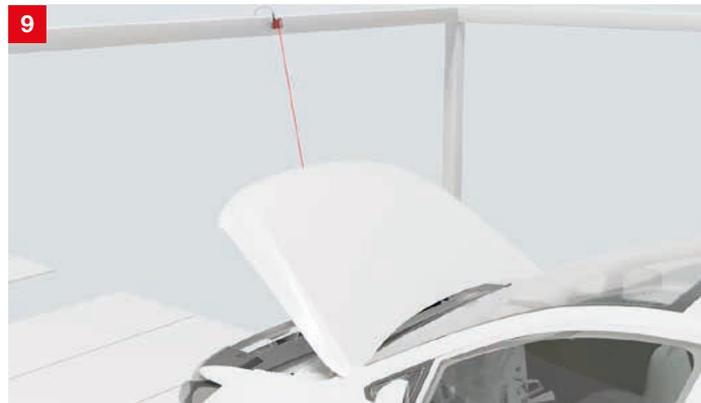
**Lösung:** Die messenden und schaltenden Abstandssensoren ODS 110/HT 110 arbeiten nach dem Pulslaufzeitverfahren (TOF) und bieten über Entfernungen bis zu 5 m zuverlässige Ergebnisse. Die Parametrierung erfolgt einfach über eine Teach-Taste oder IO-Link. Durch die kompakten Abmessungen sind die Geräte flexibel in die Anlage integrierbar.
