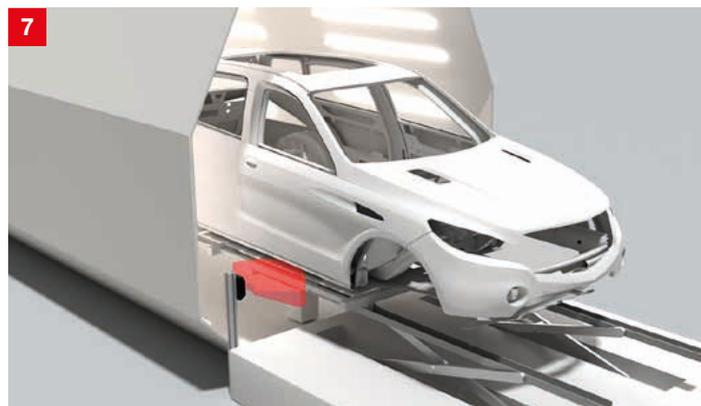
**Lösung:** Die RFID-Systeme der Baureihe RFM arbeiten im Frequenzband von 13,56 MHz und sind je nach geforderter Reichweite mit unterschiedlichen Antennen erhältlich. Transponder mit verschiedenen Geometrien und spezielle, lackverträgliche Hochtemperatur-Transponder für Temperaturen bis 250 °C sind passend zum Frequenzband verfügbar.
