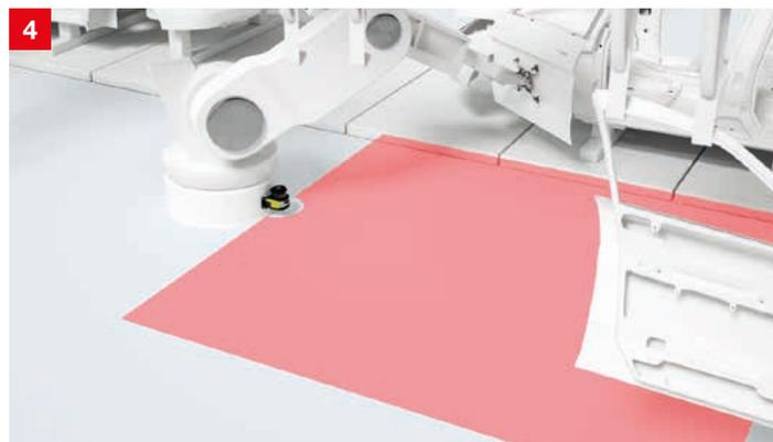
**Lösung:** Die Sicherheits-Laserscanner RSL 400 eignen sich durch die parallele Überwachung von bis zu 4 Schutzfeldern zur Bereichssicherung in automatisierten Produktionsanlagen und bei der Mensch-Roboter-Kollaboration. Ihre PROFI-safe-Schnittstelle ermöglicht eine einfache Integration in industrielle Netzwerke und bietet umfangreiche Diagnosemöglichkeiten.
