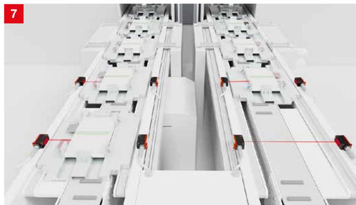
**Lösung:** Die optischen Sensoren der Serie 5B benötigen nur wenig Bau- raum. Durch die optimierte Strahlgeometrie erkennen die Geräte auch die flachen Batteriezellen zuverlässig und sorgen so für eine hohe Verfügbarkeit der Maschine.
