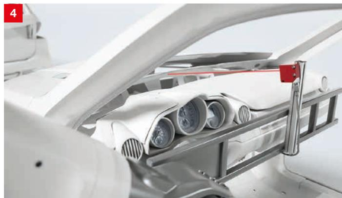
**Lösung:** Die optischen Abstandssensoren ODS 9 setzen Maßstäbe in Präzision und Bedienkomfort. Sie liefern auch unter schwierigen Bedingungen, z. B. bei glänzenden Objekten, exakte Messwerte. Diese sind auf dem integrierten Display ablesbar. Das unterstützte IO-Link Smart-Sensor-Profil ermöglicht einen schnellen und fehlersicheren Gerätetausch.
