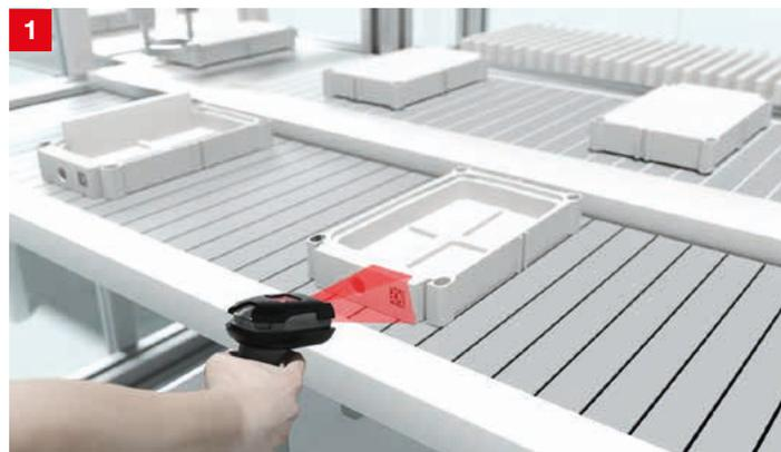
**Lösung:** Zur Erfassung der Aufträge und Lose eignen sich mobile Codeleser. Kabellose Modelle wie der IT 1990i machen die Bedienung einfach und komfortabel. Abhängig vom Steuerungskonzept werden sie direkt an einen PC angeschlossen oder – für die Einbindung über gängige Feldbus- und Ethernet-Schnittstellen – an die modulare Anschlusseinheit MA 200i.
