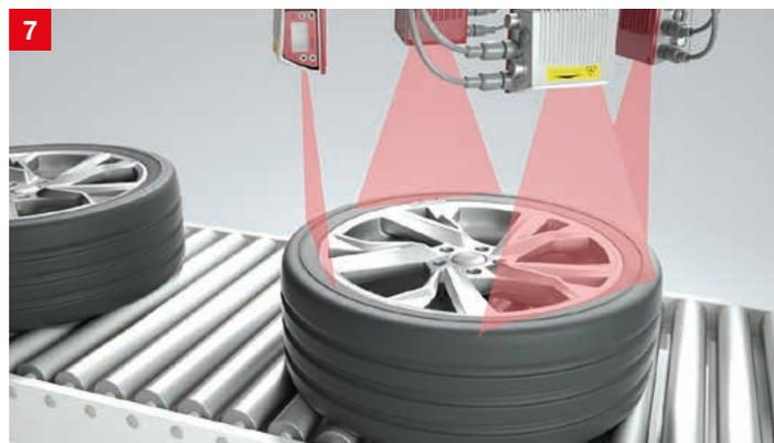
**Lösung:** Für die Abdeckung des gesamten Reifens werden mehrere Barcodeleser BCL 500i oder BCL 600i verwendet. Die Geräte zeichnen sich durch eine große Lesereichweite und Tiefenschärfe aus. Die Identifikation des Codes wird durch die Codefragmenttechnik unterstützt, die Teilergebnisse zu einem Gesamtergebnis zusammensetzt.
