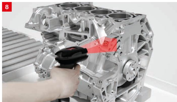
**Lösung:** Die robusten Handscanner IT 1920i und HS 66x8 dekodieren 2D-DPM-Codes und überstehen Schläge oder das Fallen auf den Boden. Sie werden über die integrierten USB- und RS 232-Schnittstellen oder – für gängige Feldbus- / Ethernet-Schnittstellen – über die modulare Anschlusseinheit MA 200i einfach in das jeweilige Steuerungskonzept eingebunden.
