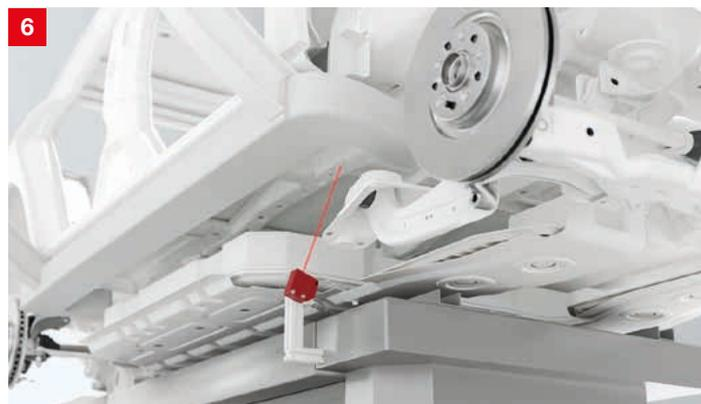
**Lösung:** Die Lasertriangulationssensoren ODS 9 sind an der Montage-Vorrichtung installiert und überwachen den Abstand zur Karosserie, damit diese exakt aufgesetzt werden kann. Sie bieten eine optimale Kombination aus Reichweite, Auflösung und Reproduzierbarkeit. Verschiedene Ausgänge sowie IO-Link ermöglichen eine optimale Einbindung der Geräte.
