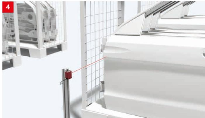
**Lösung:** Die messenden Sensoren ODS 10 oder – für höhere Auflösungen – ODKL 96 und die schaltenden Sensoren der Baureihe HT 10 liefern auch über mehrere Meter hinweg stabile Ergebnisse. Auch glänzende und spiegelnde Oberflächen werden sicher detektiert.
