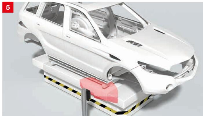
**Lösung:** Zur Lesung codierter Informationen eignen sich die Barcode- und RFID-Technik. Die Barcode-Technik leitet die gelesenen Daten an eine zentrale Datenbank weiter. Eine dezentrale Automatisierung setzt jedoch auch das Schreiben von Daten voraus. Hier kommt die RFID-Technik zum Einsatz: mit den RFID-Schreib-/Lesegeräten RFM 32 oder – für größere Reichweiten – RFM 62.
