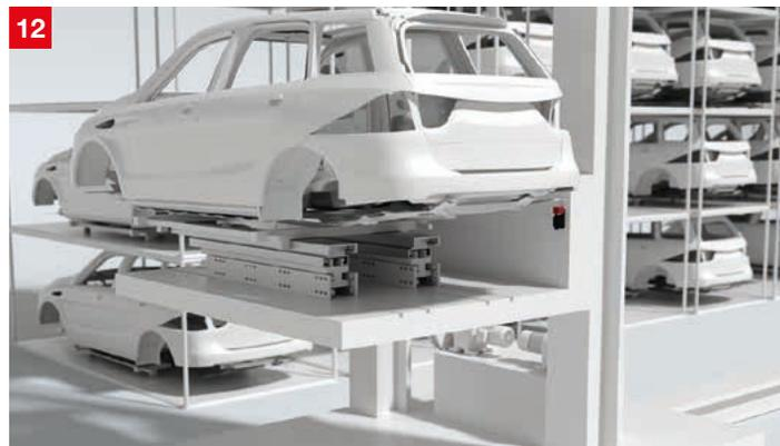
**Lösung:** Hier eignen sich induktive Sensoren. Da SKID und Hebertoleranzen auszugleichen sind, empfehlen sich Sensoren mit großem Tastabstand, z. B. die kubischen Bauformen IS/ISS 244 oder die zylindrischen Bauformen mit 3-fachem Schaltabstand aus der Baureihe IS 200.
