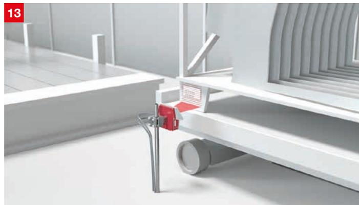
**Lösung:** Abhängig von der Anbringung des Codes und der Leseentfernung dekodiert ein BCL 300i als Rasterscanner den Code und überträgt die Daten zur SPS oder zum Materialflussrechner. Bei großen Positionstoleranzen des Etiketts werden Gerätevarianten mit integriertem Schwenkspiegel eingesetzt.
