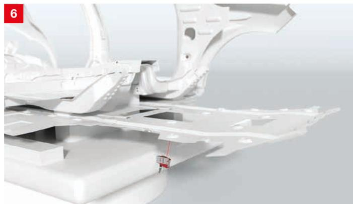
**Lösung:** Die Reflexionslichttaster mit Hintergrundausblendung HT 3 für kürzere Reichweiten und HT 46C für längere Reichweiten sorgen für eine zuverlässige Anwesenheitskontrolle. Modelle mit unterschiedlichen Lichtfleckgeometrien bieten eine optimale Anpassung an die Anwendung. Verfügbar sind flexible Befestigungen, Kabel und IO-Link-Varianten.
