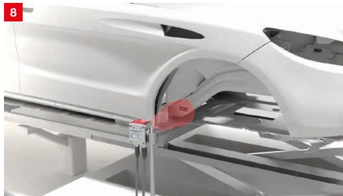
**Lösung:** Die kamerabasierten Codeleser DCR 200i sind durch ihr kompaktes Gehäuse flexibel integrierbar. Für besonders große Leseabstände bei gleichzeitig großer Tiefenschärfe werden die Barcodeleser BCL 500i eingesetzt.
