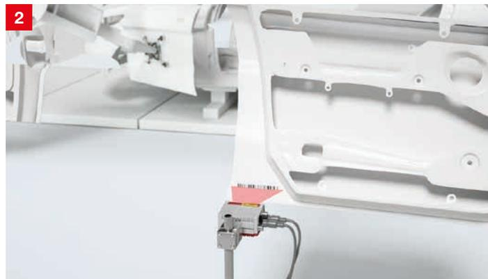
**Lösung:** Die Barcodeleser BCL 300i erfassen die Codes bis zu einer Entfernung von 700 mm. Für größere Leseentfernungen bis 2.400 mm kommen die Barcodeleser BCL 500i zum Einsatz. Je nach Anordnung des Codes und Anbindung an die Steuerung stehen passende Optikvarianten und Schnittstellen zur Verfügung.
