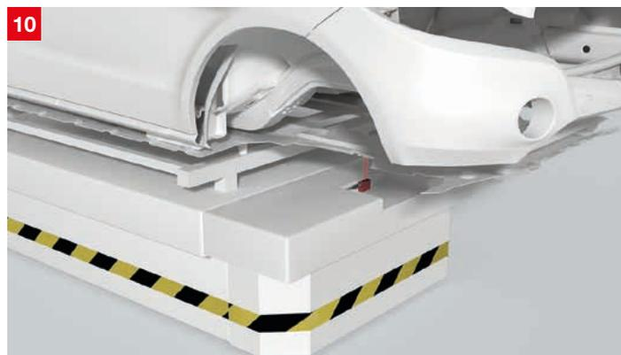
**Lösung:** Die kostengünstigen Reflexionstaster mit Hintergrundausbldung der Baureihe HT 25C bestehen auch bei glänzenden Materialien durch ihre hohe Detektionssicherheit. Varianten mit Rotlicht, Infrarot und Laser der Schutzklasse 1 sowie unterschiedliche Lichtfleckgrößen, ermöglichen die optimale Anpassung an die Anforderungen.
