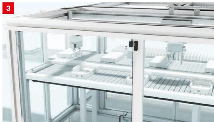
**Lösung:** Die berührungslosen Sicherheits-Transponder RD 800 mit RFID-Kodierung bieten höchsten Schutz gegen Manipulationen. Besondere Einbaumaßnahmen sind nicht erforderlich. Mit ihren OSSD-Ausgängen sind sie zudem einfach integrierbar. Die robusten Sicherheits-Schalter mit mechanischen Zungenbetätigern der S20/200-Serie sind universell einsetzbar.
