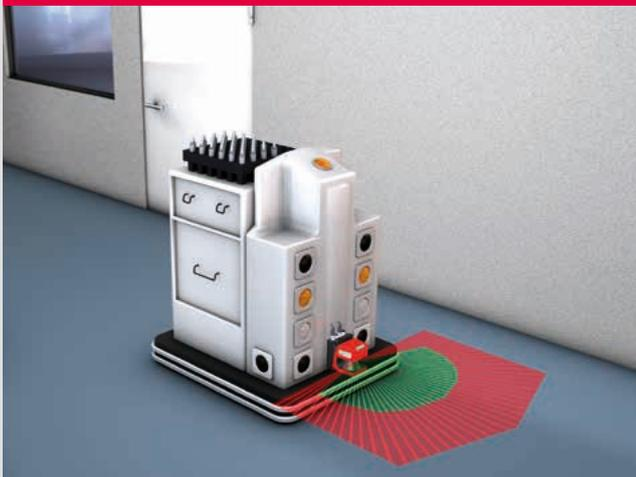
Kollisionsschutz von fahrerlosen Transportsystemen
