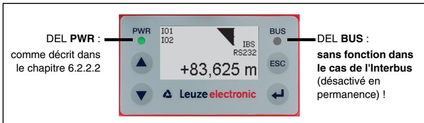
Fig. 8.12 : Diodes témoin de la version Interbus
