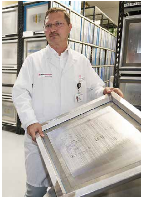
Directeur de production Georg Denkinger avec un pochoir. Il est utilisé pour appliquer la pâte à souder spécifiquement sur les cartes de circuits imprimés.
