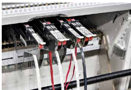
Les composants électroniques standard sont situés sur des rouleaux. Les bandes transporteuses individuelles sont introduites dans une machine de placement. Cela place les composants sur la carte de circuit imprimé.
