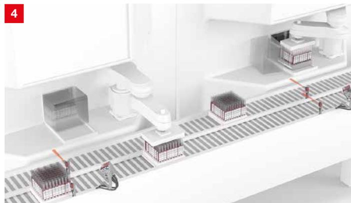
**Lösung:** In besonders kompakter Bauform für eine leichte Integration sind die optischen Sensoren der Serien SR 2 oder SR 3 mit allen Funktionsprinzipien optimal für dieses Umfeld geeignet. Bevorzugt wird eine PRK 2 mit Reflektor eingesetzt.
