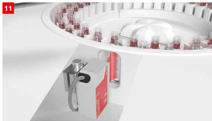
**Lösung:** Die 1D-Codeleser der Serie BCL 95 können auch durch Glasscheiben die Barcodes auf den Proben fehlerfrei identifizieren. Dies gilt auch bei einem sehr geringen Leseabstand und dicht beieinander liegenden Barcodes in einem Double Carousel.
