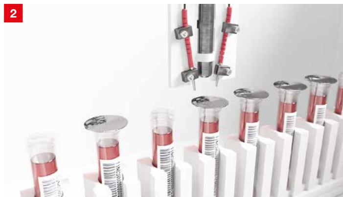
**Lösung:** Die besonders filigranen faseroptischen Sensoren KFX mit komfortabel einstellbaren Lichtleiter-Verstärkern LV 46x ermöglichen die prozesssichere Detektion der Siegfelfolie.
