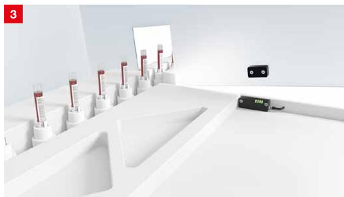
**Lösung:** Die Sicherheits-Näherungssensoren RD 800 bieten durch ihre RFID-Kodierung besonders hohen Manipulationsschutz. Alternativ überwachen die magnetkodierte Sicherheits-Näherungssensoren MC 300 den Schließzustand.
