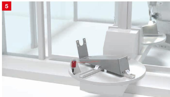
**Lösung:** Die Reflexionslichttaster mit Hintergrundausbuchtung HT 25C für längere Reichweiten und HT 3 für kürzere Reichweiten sorgen für eine zuverlässige Anwesenheitskontrolle. Modelle mit unterschiedlichen Lichtfleckgeometrien bieten eine optimale Anpassung an die Anwendung. Verfügbar sind flexible Befestigungen, Kabel und IO-Link-Varianten.
