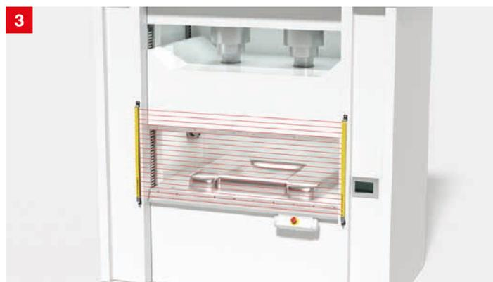
**Lösung:** Die Sicherheits-Lichtvorhänge der Baureihen ELC 100 und MLC 500 bieten mit verschiedenen Auflösungen ab 14 mm eine sichere Finger- und Hand-Erkennung und ermöglichen so kurze Sicherheitsabstände. Durch das optimierte Design sind die ELC 100 und die MLC 500 in V-Ausführung besonders schock- und vibrationsfest.
