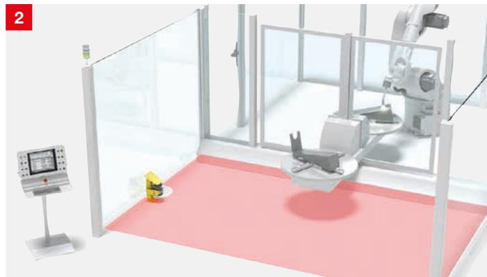
**Lösung:** Die Sicherheits-Laserscanner RSL 400 nutzen konfigurierbare Schutzfelder zur Bereichsüberwachung. Durch 8,25 m Reichweite und 270°-Scanbereich können auch große Flächen mit nur einem Gerät gesichert werden. Die Varianten mit PROFSafe / PROFINET-Schnittstelle lassen sich einfach in industrielle Netzwerke integrieren.
