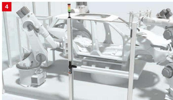
**Lösung:** Die robusten Sicherheits-Schalter mit Zuhaltung der L-Baureihe verriegeln Schutztüren bis zur Freigabe über ein elektrisches Signal. Neben Standard-Varianten sind Geräte mit integrierten Bedientasten und Not-Halt sowie mit RFID-kodiertem Betätiger verfügbar. Optische und akustische Signalgeber der A7-Baureihe ergänzen die integrierten LED-Zustandsanzeigen.
