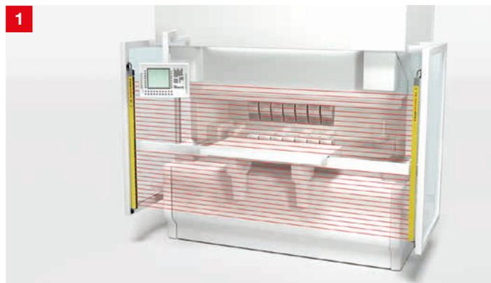
**Lösung:** Die Sicherheits-Lichtvorhänge MLC 530 verfügen über die Funktionen feste Ausblendung, bewegliche Ausblendung sowie reduzierte Auflösung. Durch die Konfiguration dieser Funktionen werden bestimmte Objekte im Schutzfeld zugelassen.
