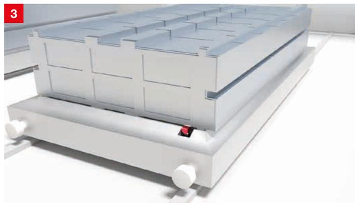
**Lösung:** Aus unserem breiten Portfolio induktiver Sensoren sind die Modelle IS / ISS 244 mit kubischer Bauform am besten geeignet. Die kompakten Sensoren lassen sich platzsparend und schnell einbauen. Seitlich gut sichtbare Statusanzeigen erleichtern die Inbetriebnahme und visualisieren Zustände.
