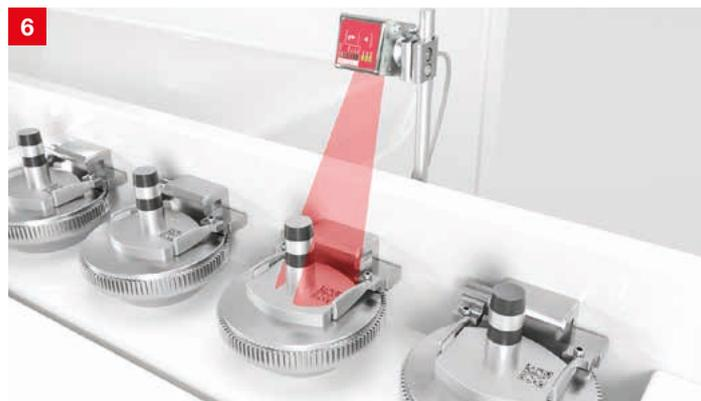
**Lösung:** Die Codeleser DCR 200i und die Smart Kameras LSIS 400i lesen 2D-Codes. Die DCR 200i zeichnen sich durch ihre kompakte Bauform und einfache Inbetriebnahme aus. Ihre Optikvarianten ermöglichen unterschiedliche Lesereichweiten. Die LSIS 400i bieten mit der motorischen Fokuseinstellung ein großes und flexibel einstellbares Lesefeld.
