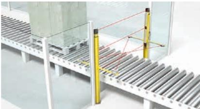
2-Sensor-Muting, zeitgesteuert. Universelle Lösung für Ein- und Ausfahren. Die Muting-Sensoren sind über Kreuz ausgerichtet.
