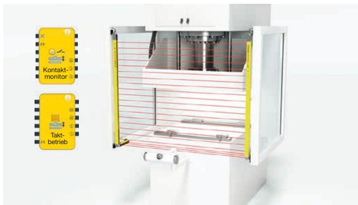
**Lösung:** Für den Einsatz an Exzenter- und Hydraulikpressen bietet das Konfigurationstool MSI.designer eine spezielle Funktions-Bibliothek. Diese enthält zugeschnittene Funktionsblöcke für die Steuerung und Absicherung von Pressen und ermöglicht so eine einfache und schnelle Konfiguration der Sicherheits-Steuerung MSI 400.
