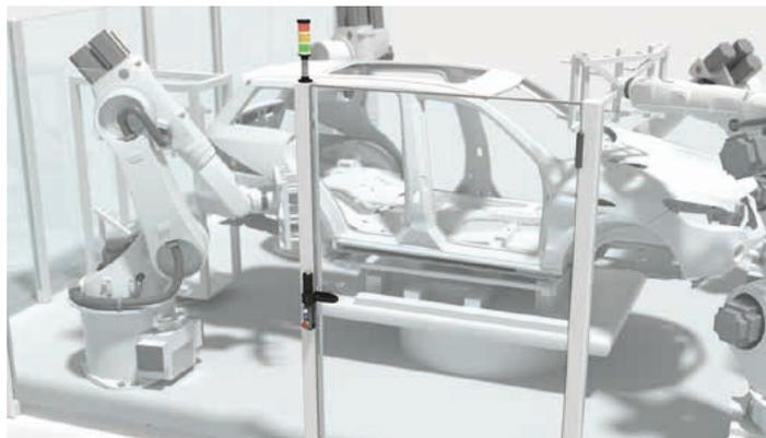
**Lösung:** Die robusten Sicherheits-Schalter mit Zuhaltung der L-Serie halten Schutztüren fest verriegelt, bis der Zugang über ein elektrisches Signal freigegeben wird. Die Serie umfasst Standard-Bauformen, Geräte mit integrierten Bedienelementen sowie Geräte mit RFID-kodiertem Betätiger.
