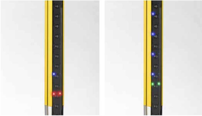
Mit der Multi-Level-Ausricht-Anzeige ist die Inbetriebnahme der Geräte besonders einfach. Bereits eine grobe Ausrichtung wird zuverlässig angezeigt. Durch die gut sichtbaren, leuchtstarken LEDs kann das Ergebnis der Ausrichtung direkt vom Sender aus beobachtet werden. So ist die optimale Einstellung schnell erreicht. Dies spart Zeit und Geld bei der Inbetriebnahme und bietet Reserven im Betrieb.
