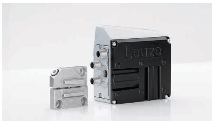
Das durchdachte Befestigungskonzept mit Schnellwechsellösung ermöglicht eine einfache Montage der FBPS 600i. Mit nur einer, leicht zugänglichen Schraube an der Klemmhalterung werden die Geräte sicher befestigt. Dies spart Zeit bei der Montage, und im Servicefall lassen sich die Geräte schnell tauschen.
