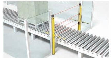
4-Sensor-Muting, zeitgesteuert. Für Ein- und Ausfahren. Bei erhöhten Anforderungen, z. B. an Form und Platzierung der Beladung. Die Muting-Sensoren sind parallel ausgerichtet.
