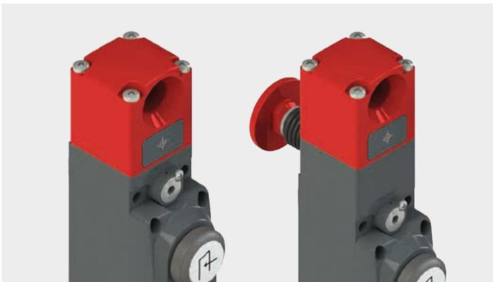
Die optionale Fluchtentriegelung (Panic-Button) ermöglicht die sofortige Entriegelung des Betätigers und das Öffnen der Tür aus dem Inneren des Gefahrenbereichs. Der ergonomisch optimierte Taster ermöglicht es dem Bediener den Gefahrenbereich auch dann zu verlassen, falls er versehentlich eingeschlossen wird. Die Vorrichtung funktioniert auch bei fehlender Stromversorgung.
