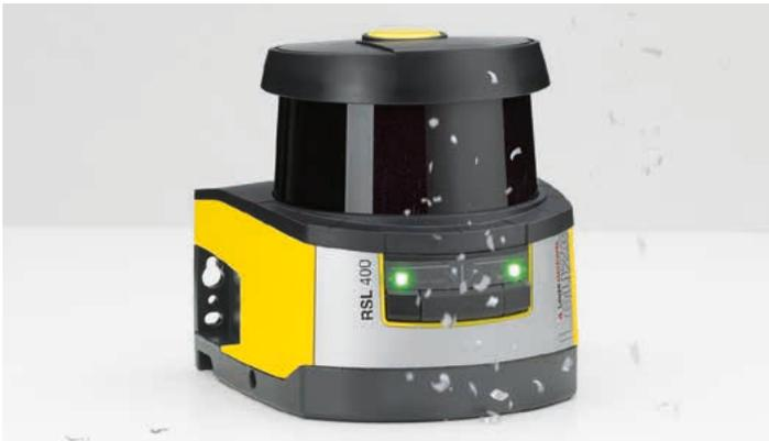
Durch die hohe Winkelauflösung von  $0,1^\circ$  kann der RSL 400 nicht sicherheitsrelevante Objekte, wie Staub und Partikel in der Luft, besonders gut filtern (etwa 3x höhere Abtastung als bei konventionellen Scannern). So werden unnötige Abschaltungen reduziert.
