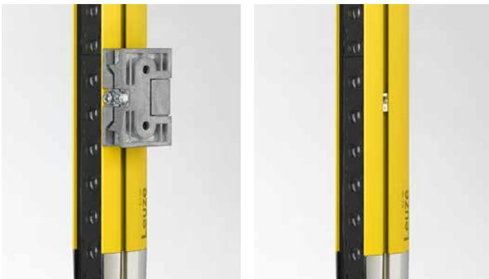
Die robusten Halter unterstützen durch ihre Schwenk-Funktion die einfache Ausrichtung der Geräte. Sie werden direkt in den Nuten montiert, die auf beiden Seiten der ELC 100 angebracht sind. Ist keine Ausrichtung notwendig – zum Beispiel bei Anwendungen mit kurzen Reichweiten – kommen die im Lieferumfang enthaltenen Nutensteine zum Einsatz, was die Kosten weiter reduziert.
