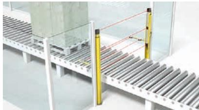
2-Sensor-Muting, sequenzgesteuert. Nur für Ausfahren. Bei erhöhten Anforderungen, z. B. an Form und Platzierung der Beladung. Die Muting-Sensoren sind parallel ausgerichtet.
