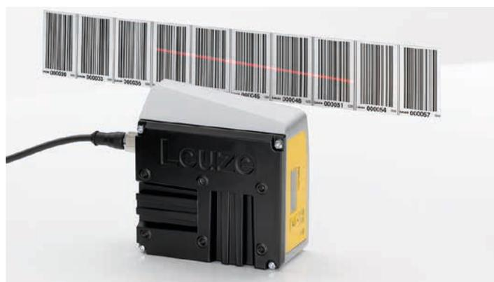
Das FBPS 600i arbeitet besonders zuverlässig. Mit jedem Scansvorgang werden mehrere Codes gelesen, aus denen die Software hochgenaue Positionswerte ermittelt. Durch den schrägen Verlauf des Scanstrahls und die Bewegung des Gerätes wird jeder Code an verschiedenen Stellen abgetastet. So werden Lesefehler durch lokale Verschmutzungen oder Beschädigungen vermieden.
