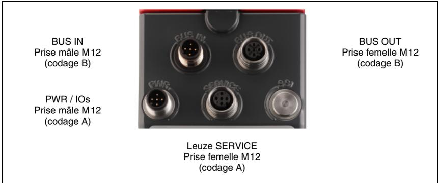
Figure 7.1 : Raccordements de l'AMS 3004*i*
