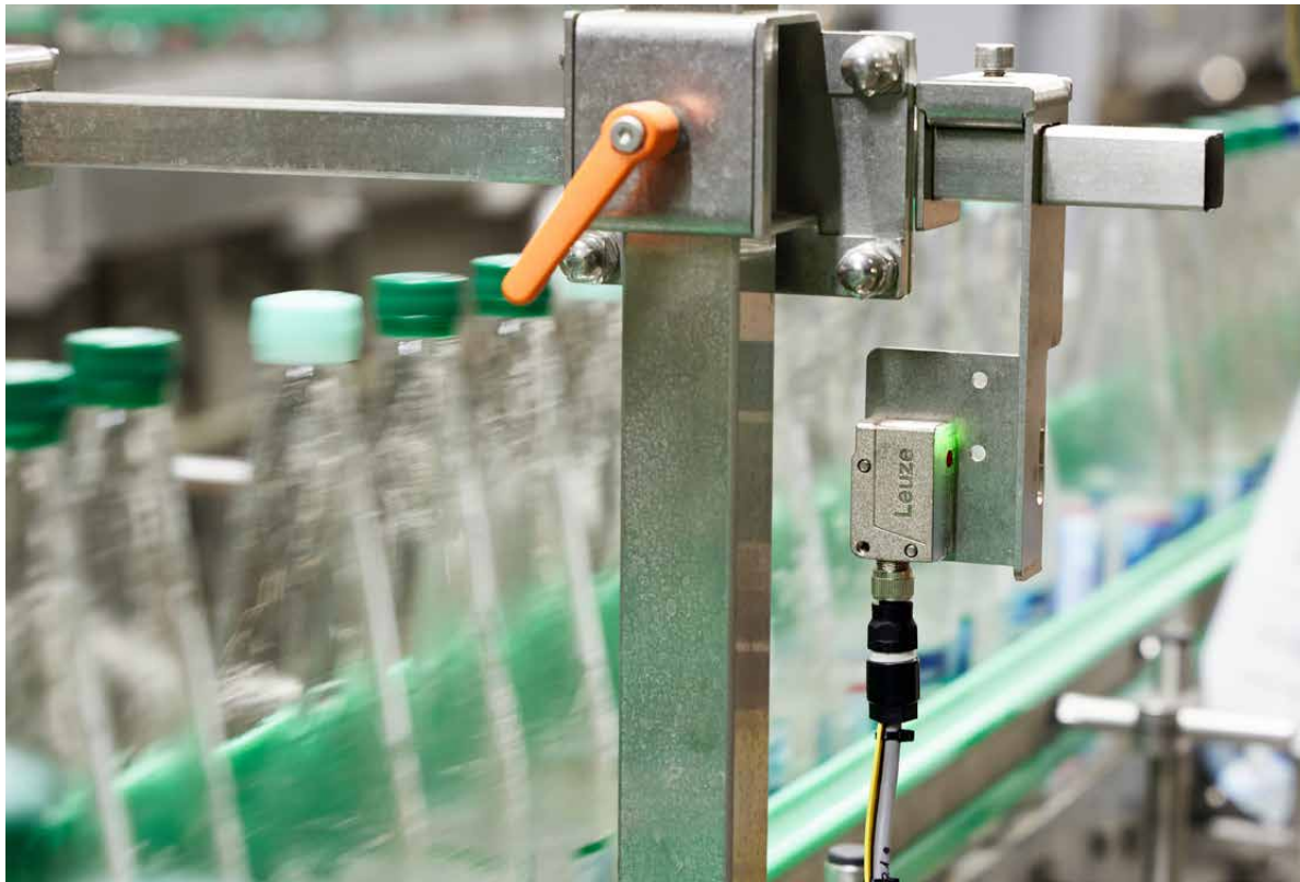
PRK 18B in der Behälterfördertechnik.
