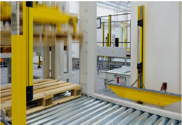
RK 46C.DXL VarOS的带状光斑使它同样适合用作屏蔽传感器
