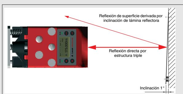
Figura 1.3: Montaje del reflector
