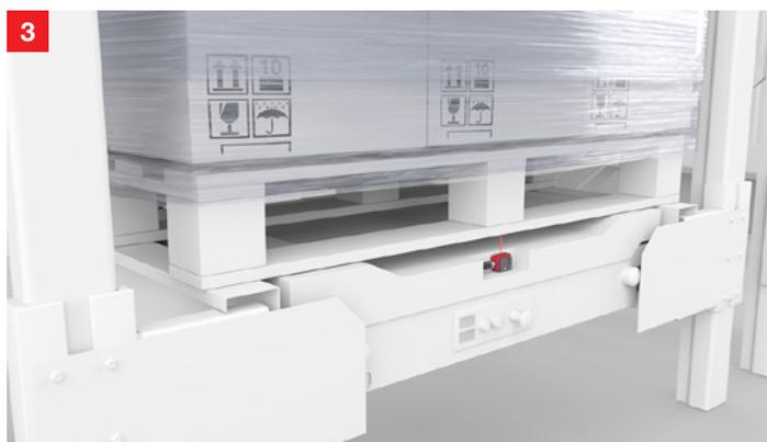
**Solución:** Los sensores ópticos HT 3C detectan los palets de forma fiable gracias a la supresión de fondo activa y a la resistencia a la luz ambiental. La serie HT 3C ofrece soluciones robustas, por ejemplo, para detectar objetos con estructuras cromáticas, objetos perforados u objetos con superficies muy pulidas.
