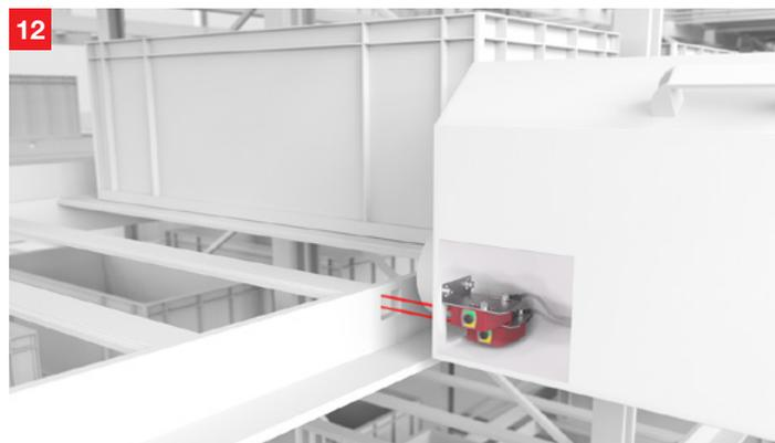
**Solución:** Las potentes fotocélulas autorreflexivas con supresión de fondo de la serie 3C detectan de forma fiable objetos frente a una gran variedad de fondos. Existen modelos con luz láser para tareas de posicionamiento especialmente precisas y rápidas.
