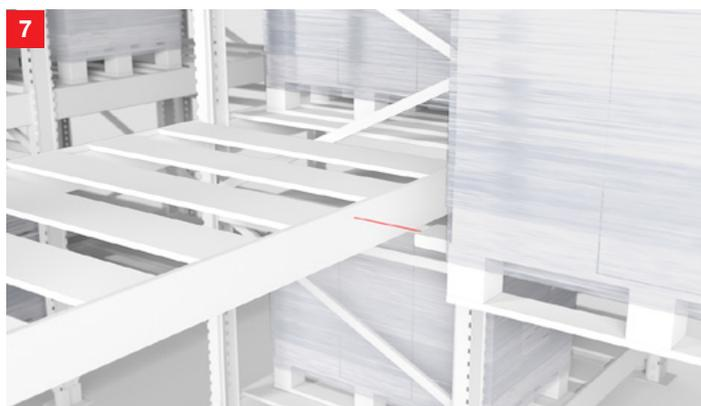
**Solución:** Las fotocélulas autorreflexivas de la serie HT 3C funcionan independientemente del material y tienen puntos de conmutación precisos. Gracias a las dos salidas digitales, los mismos sensores pueden usarse también para el posicionamiento del manipulador de cargas.
