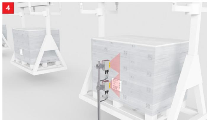
**Solución:** Los lectores de códigos de barras de la serie BCL 500i/600i leen los códigos de los palets. A través del switch integrado, los equipos se pueden conectar entre sí, y directamente al control a través de una estructura de línea. Gracias a las diferentes versiones de la óptica, los equipos también se pueden adaptar de forma óptima a la tarea de lectura.
