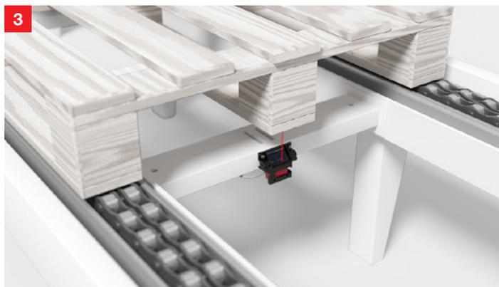
**Solución:** Las fotocélulas autorreflexivas de la serie HT 25C ya están montadas por el fabricante del sistema de transporte en el interior del mismo mediante un soporte especial. Disponen de un cristal frontal integrado para desviar las partículas de suciedad. La parametrización específica de luz ambiental de los sensores bloquea eficazmente las fuentes de luz ambiental.
