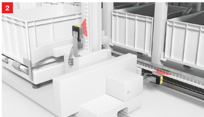
**Solución:** Con el sistema de posicionamiento por códigos de barras seguro FBPS 600i solo se necesita un sensor para la detección segura de la posición. El equipo se conecta a través de dos interfaces SSI a una unidad de evaluación segura, por ejemplo de un convertidor de frecuencia, y es apropiado para aplicaciones hasta PL e. De este modo, se pueden implementar las funciones de seguridad con facilidad.
