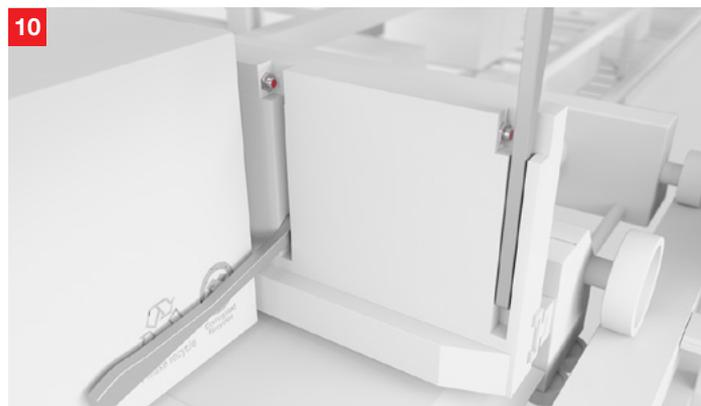
**Solución:** Los sensores inductivos de la serie IS 208 detectan con fiabilidad objetos metálicos. Los pequeños equipos estándar, con un diámetro de tan solo 8 mm y una carcasa de metal robusta, pueden integrarse fácilmente y de forma individual en la lanzadera.
