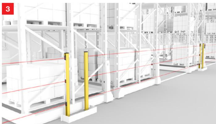
**Solución:** Los dispositivos de seguridad multihaz de la serie MLD 500 se utilizan como protección de accesos. Para alcances de hasta 8 m, hay disponibles sistemas transceptores económicos que solo necesitan una conexión eléctrica a un lado. Como alternativa, los sistemas emisor-receptor ofrecen alcances de hasta 70 m.
