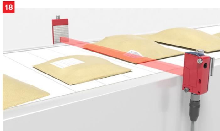
**Solución:** Las fotocélulas reflexivas de la serie RK 46C detectan de forma fiable objetos de hasta 5 mm en un sistema de cinta transportadora. Para ello, los equipos usan un potente haz de luz rectangular de 25 mm de ancho. Gracias a la alta frecuencia de conmutación de 250 Hz, el RK 46C detecta objetos incluso a altas velocidades de transporte.
