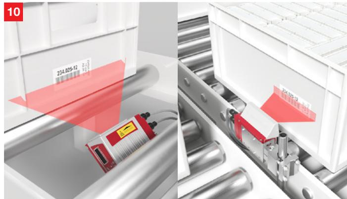
**Solución:** Los lectores de códigos de barras de las series BCL 200i y BCL 300i se pueden montar a poca distancia del código gracias a su distancia mínima de lectura de solo 40 y 20 mm. Con su switch integrado, las estructuras de línea se pueden configurar en todos los buses de campo basados en Ethernet. La parametrización se realiza a través del control.
