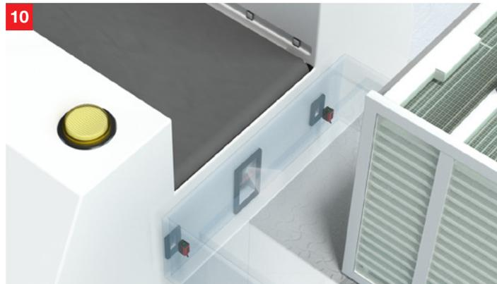
**Solución:** Las económicas fotocélulas de barrera de la serie 5 transmiten la información de conmutación al AGV. Los equipos son insensibles frente a la luz ambiental y se pueden alinear fácilmente gracias a la luz roja visible.
