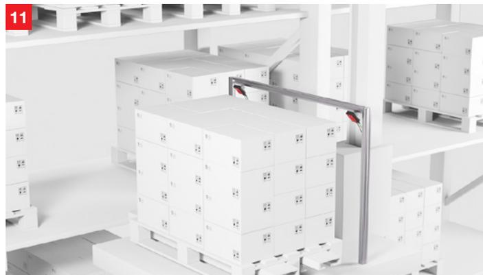
**Solución:** La cámara IP industrial LCAM 308 permite la observación en áreas inaccesibles para el operario de una instalación durante su funcionamiento. Esto simplifica detectar la causa del error en caso de mal funcionamiento. La robusta cámara suministra Live-Streams de alta calidad a través de la interfaz Ethernet. Además, se puede acceder a la grabación del último minuto.
