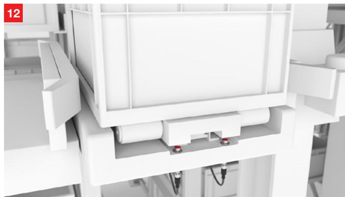
**Solución:** Los sensores inductivos de la serie IS 208 e IS 212 detectan con fiabilidad objetos metálicos. Los equipos con carcasa de metal robusta pueden adaptarse de forma óptima a la aplicación correspondiente seleccionando la salida, la conexión y el alcance de detección.
