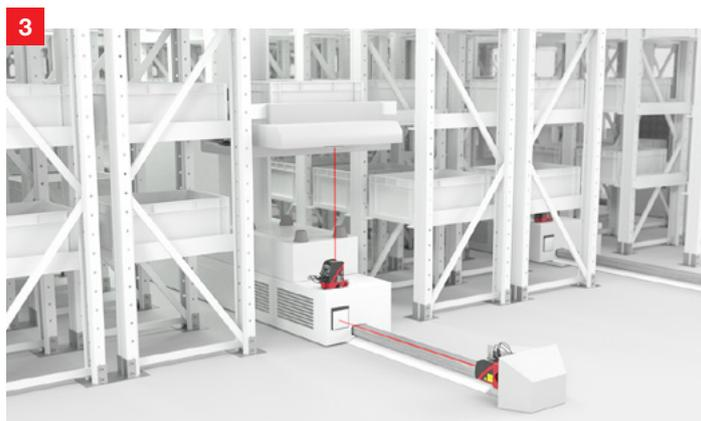
**Solución:** El sistema de posicionamiento láser AMS 300i determina rápidamente y con una exactitud absoluta las distancias respecto a los componentes móviles de la instalación a una distancia de hasta 300 m. En cuestión de milisegundos, los equipos proporcionan los valores medidos para el control dinámico mediante una amplia selección de interfaces Industrial Ethernet o interfaces de buses de campo.
