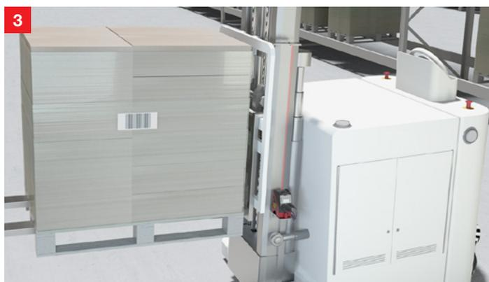
**Solución:** El sistema de posicionamiento láser AMS 300i proporciona datos de medición cada 2 ms con una exactitud absoluta de  $\pm 2$  mm. Los datos se pueden transferir al control a través de una gran variedad de interfaces.
