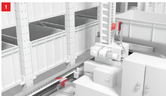
**Solución:** Los sistemas compactos de posicionamiento por códigos de barras BPS 300i permiten un posicionamiento exacto. Las interfaces para buses de campo, Industrial Ethernet, así como las conexiones SSI y en serie, permiten que la integración en el control sea sencilla y flexible. De igual modo, la configuración y el diagnóstico de los equipos resultan también muy sencillos.
