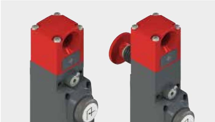
옵션으로 선택 가능한 비상 해제 버튼(패닉 버튼)은 액추에이터가 즉각적으로 잠금을 해제하여 위험 구역 내부에서 도어를 열 수 있습니다. 작업자의 부주의로 인해 위험 구역에 갇혔을 경우에도 비상 해제 버튼을 눌러 나올 수 있으며, 전원 공급이 되지 않는 경우에도 작동하여 비상 탈출이 가능합니다.
