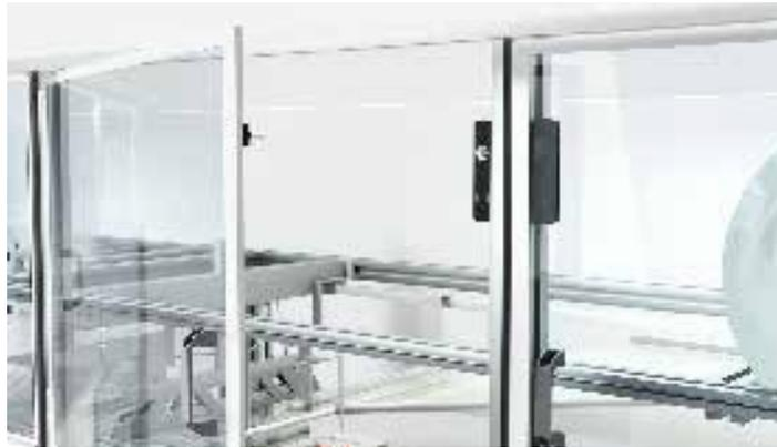
**솔루션:** 인터락 장치가 있는 안전 스위치 L 시리즈는 공정 제어 장치가 전기 신호를 보낼 때까지 안전 도어를 잠금 상태로 유지합니다.
