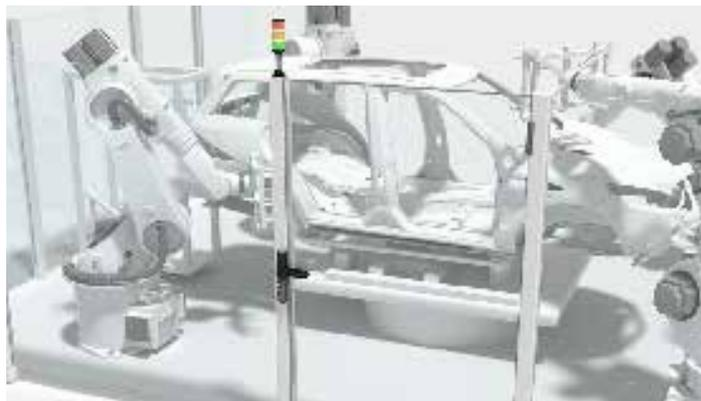
**솔루션:** 견고한 인터락 안전 스위치 L 시리즈는 전기 신호를 통해 접근이 허용될 때까지 안전 도어를 단단히 잠급니다. 이 시리즈는 기본 모델, 조작 컨트롤이 내장된 모델, 그리고 RFID 코딩 액추에이터가 있는 등 다양한 모델을 제공합니다.
