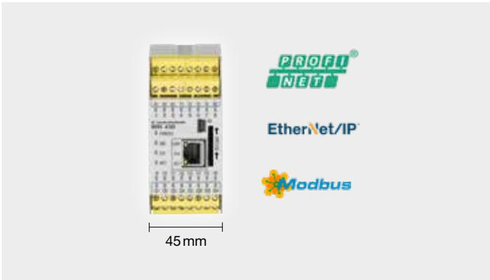
안전 컨트롤러 MSI 400은 산업용 네트워크에 쉽게 연결할 수 있습니다. 45mm밖에 되지 않는 작은 너비의 하우징을 갖추었으며 이더넷 통신과 산업용 이더넷 프로토콜이 내장되어 있습니다. 게이트웨이 모듈을 이용하면 EtherCAT, PROFIBUS 및 CANopen 등 다른 필드버스로도 연결이 가능합니다.
