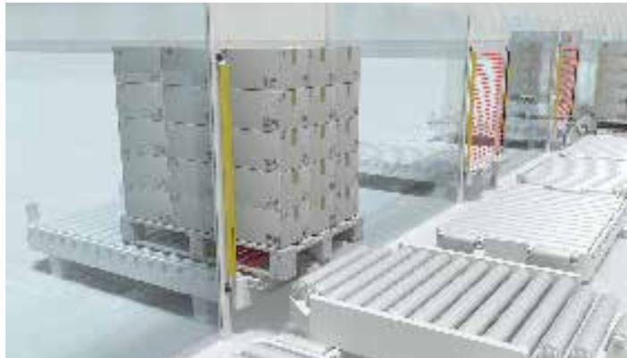
**솔루션:** 스마트 프로세스 게이팅 (SPG) 기능을 사용하면 안전 센서가 PLC의 제어 신호와 함께 브릿지 처리됩니다. 이 기능은 MLC 530 SPG 안전 라이트 커튼에 내장되어 있습니다. 추가 뮤팅 센서가 필요 없으며 SPG를 통해 장비의 설치 공간을 절약할 수 있습니다.
