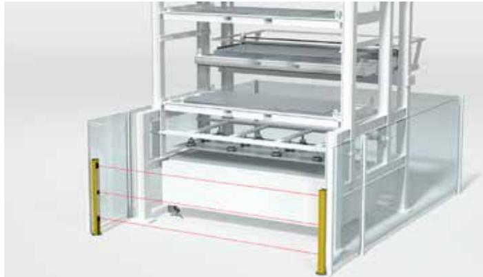
**솔루션:** 멀티 라이트빔 안전 센서 MLD 300/500는 비용 대비 효율적인 접근 보호 솔루션을 제공합니다. 최대 8m 작동 범위의 트랜시버 버전은 특히 설치가 간편합니다. 넓은 영역을 보호할 때에는 송신기/수신기 모델을 사용하여 최대 70m 까지 감지할 수 있습니다.
