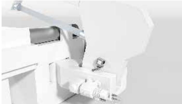
**솔루션:** 포지션 스위치 S300은 최종 위치 도달 여부를 모니터링합니다. 이 장치는 플러저와 다양한 액추에이터가 있는 버전을 제공하여 범용으로 사용할 수 있습니다. 강제 폐쇄 접점(NC)으로 S300을 안전 회로에 직접 연결할 수도 있습니다.
