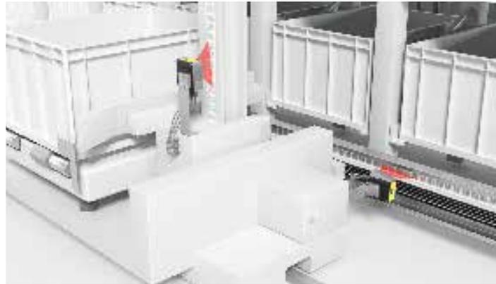
**솔루션:** 안전 바코드 위치 확인 시스템 FBPS 600i는 하나의 장치로 안전한 위치 감지를 제공합니다. PL e/ SIL 3에 대한 요구 사항을 충족하며 안전 기능을 매우 쉽게 구현할 수 있습니다.
