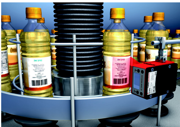
Figura 3.6: Ejemplo de aplicación de asiento e identificación de etiquetas
