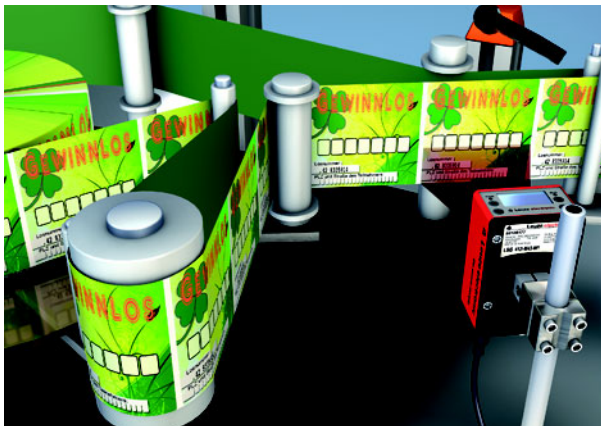
Figura 3.1: Ejemplo de aplicación: control de presencia
