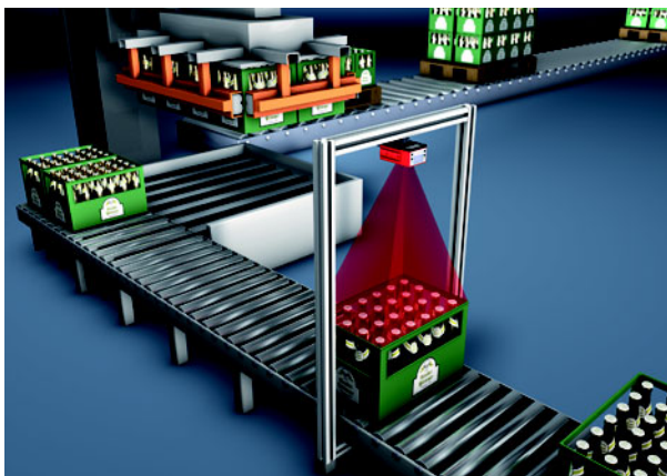
Figura 3.2: Ejemplo de aplicación: control de integridad
