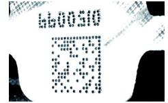
Figure 3.5 : Exemple d'application : code Data Matrix marqué à l'aiguille
