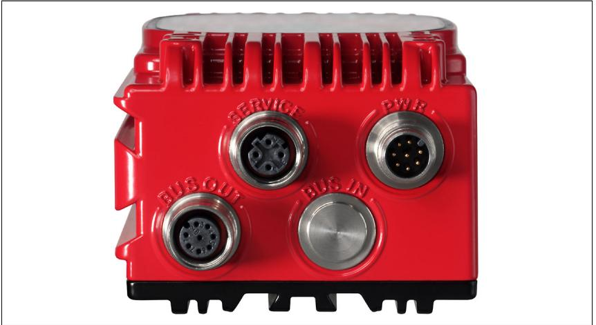
Figure 5.1 : Position des branchements électriques
