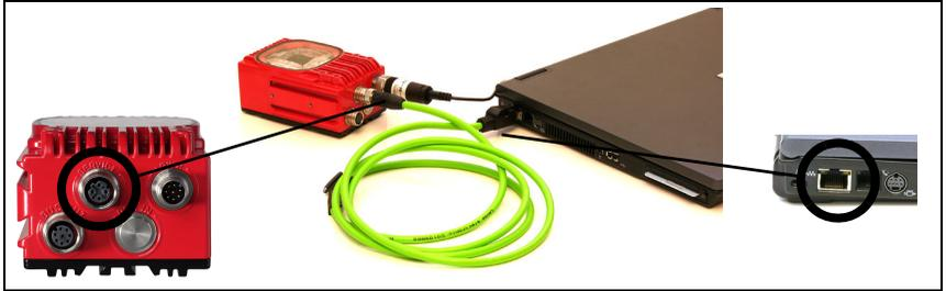
Figure 6.1 : Raccordement de la LSIS 4xx*i* au PC
