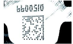
Bild 3.5: Applikationsbeispiel genadelter Data Matrix Code
