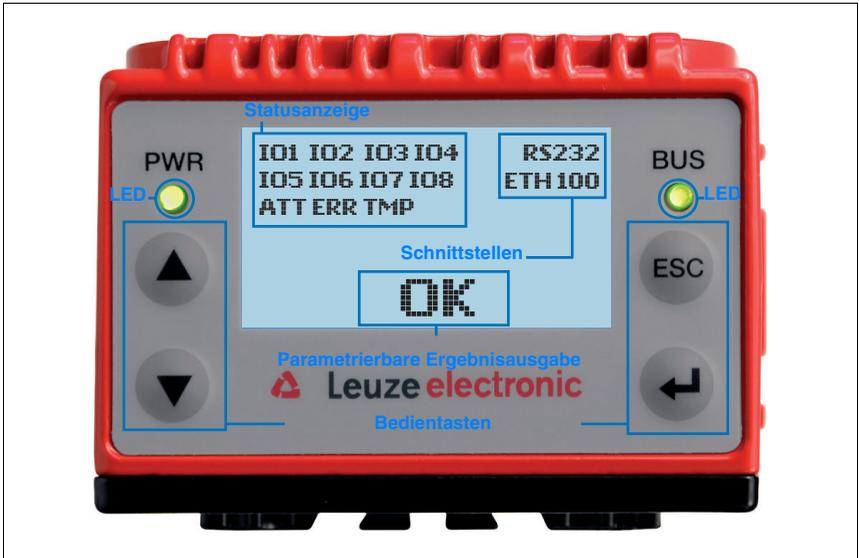
Bild 7.1: Aufbau des Bedienfeldes
