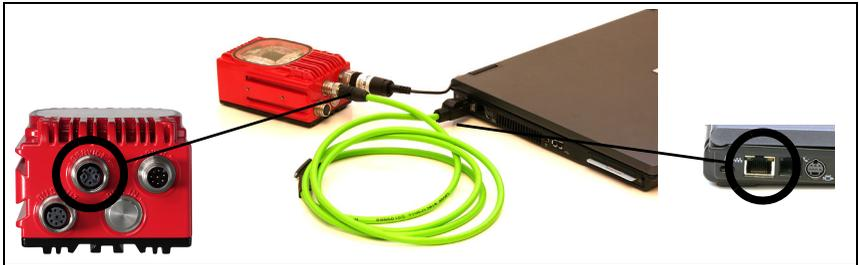
Bild 6.1: Anschluss LSIS 4xx*i* an PC
