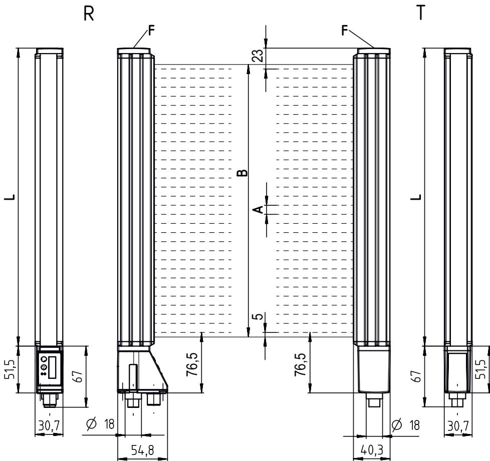
A 光束距离 20 mm      L 型材长度 1128 mm
