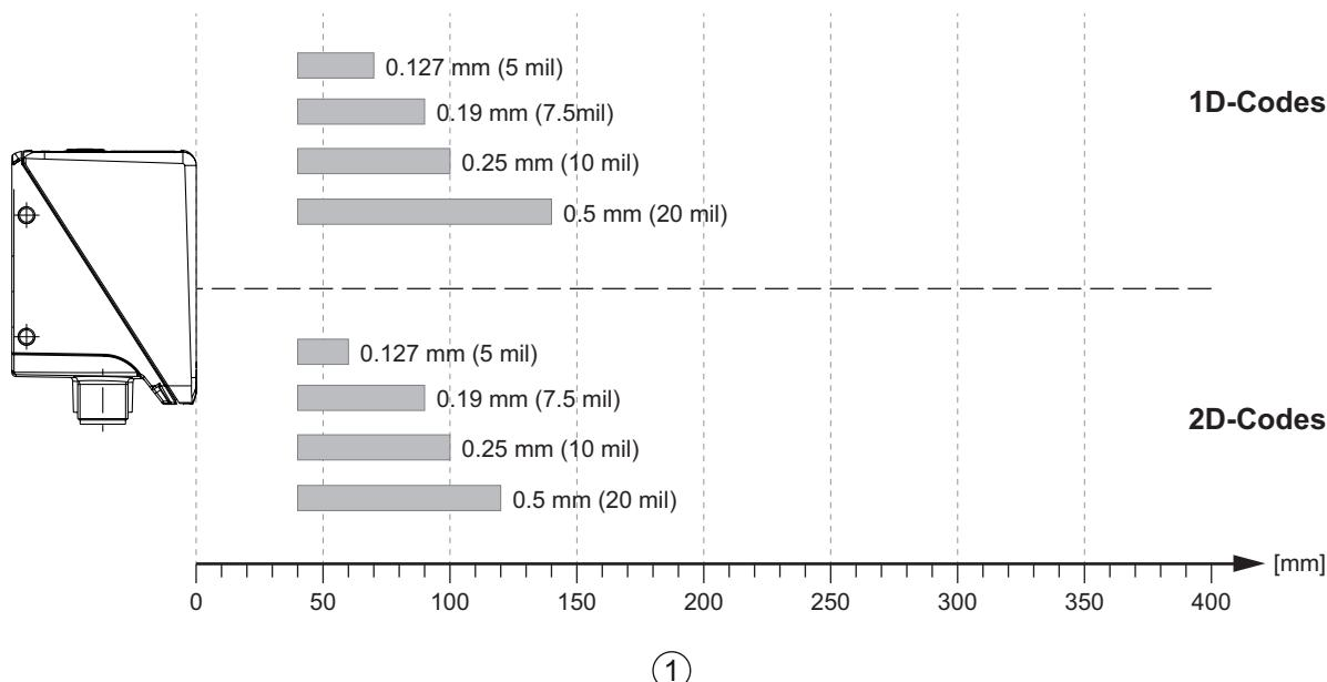
图 6.2: 不同条码模块大小上典型的 1D 和 2D 码读取间距
