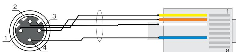
图 7.7: RJ-45 上的主机电缆布置
