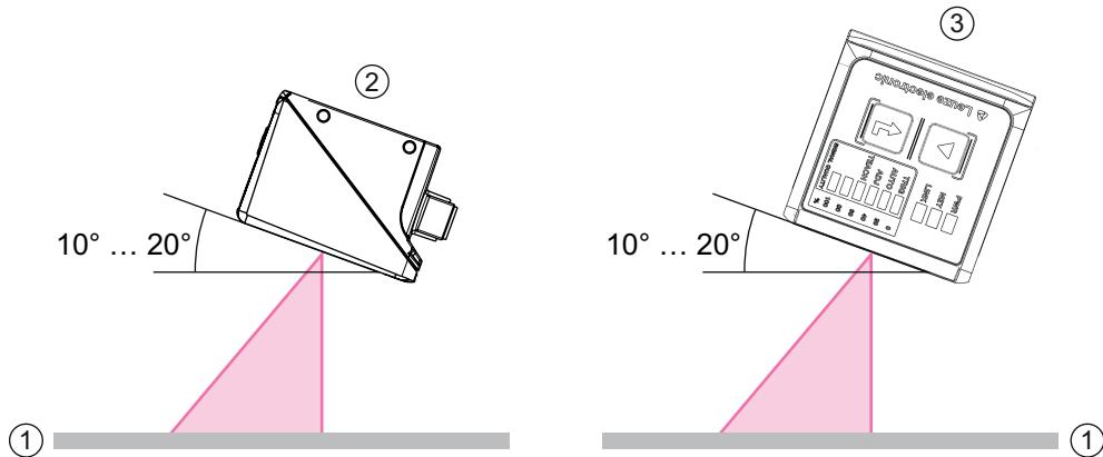
建议的倾翻或倾斜角度  $10^\circ \dots 20^\circ$
