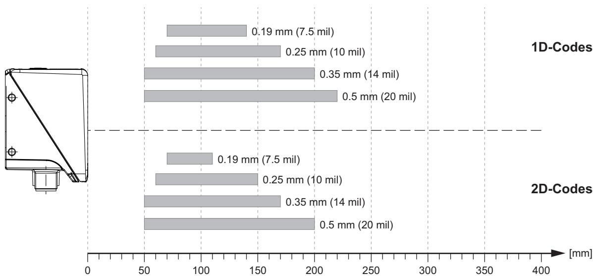
图 6.3: 不同条码模块大小上典型的 1D 和 2D 码读取间距
