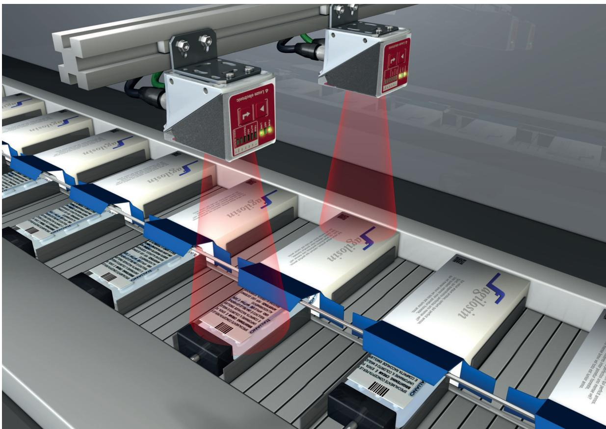
图 5.2: 包装技术中读取 2D 码
