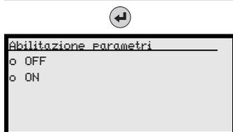
Nel menu di gestione dei parametri, con i tasti selezionare la voce di menu Abilitazione Parametri.
